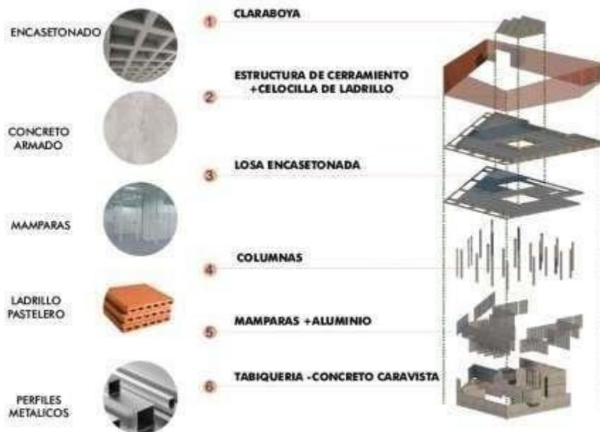
Figura 52: Sistema Constructivo
