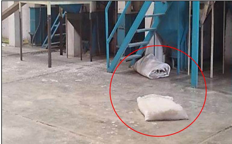
Figura 25. Sacos obstaculizando el paso dentro del área de producción.
