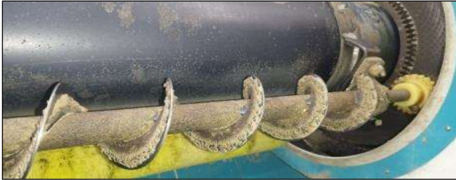
Figura 27. Sin fin del clasificador de arroz sucio.
