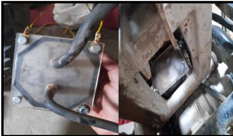
Figura 47 Reservorio de agua instalada en la parte trasera de la moto
