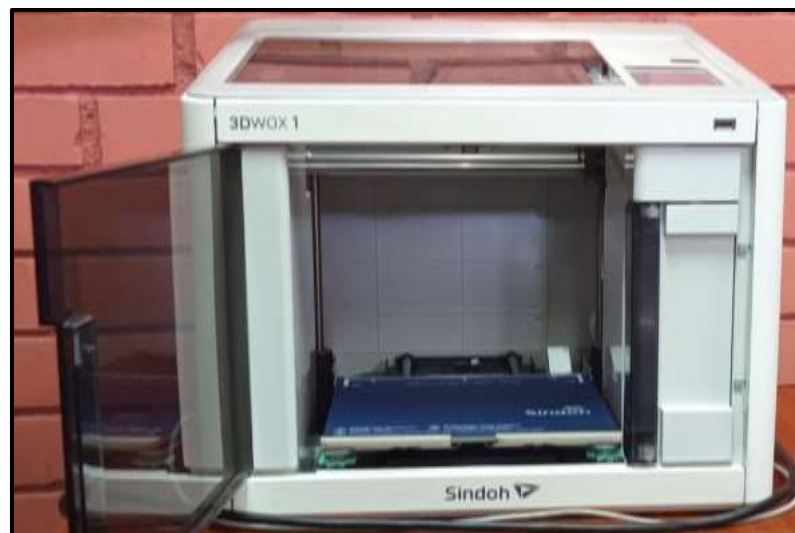
Figura 7 Impresora 3D Sindoh, modelo 3DWOX 1
