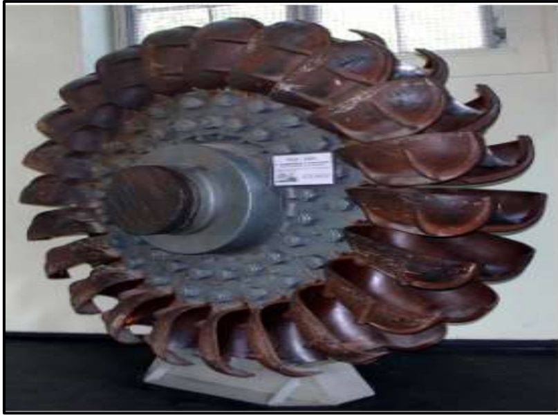
Figura 3. Turbina tipo Pelton de eje horizontal
