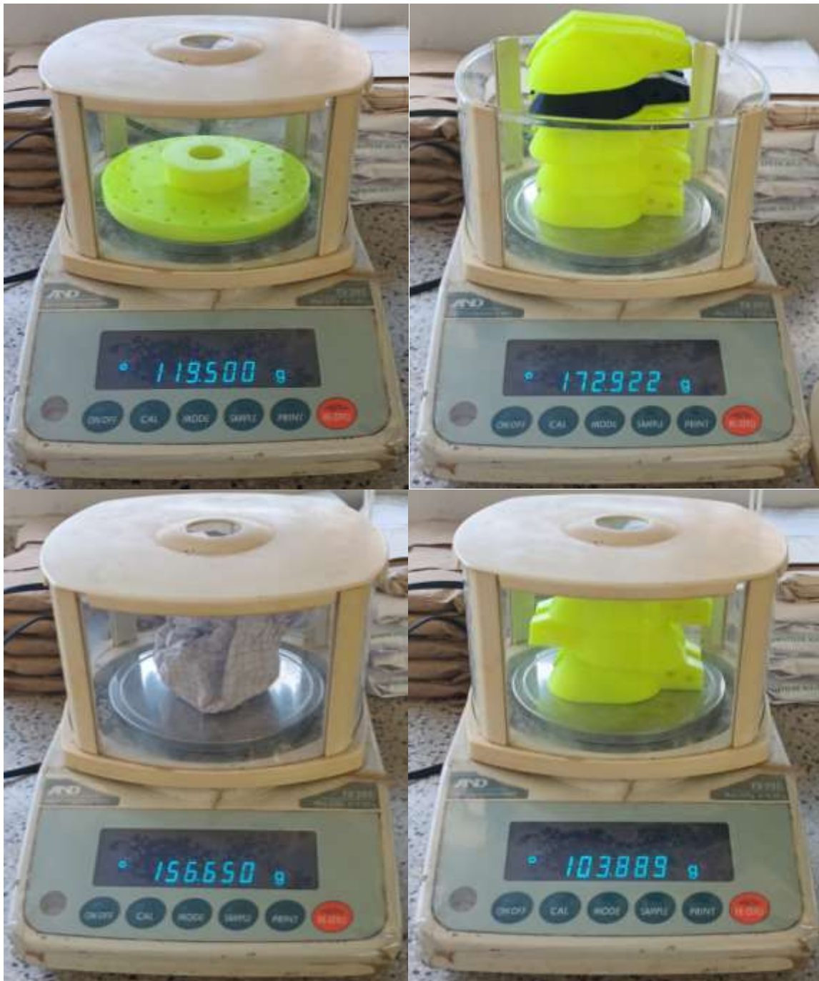
Anexo 11. Peso de las microturbinas tipo Pelton impresas en 3D con PLA para la microturbina del 50 % de relleno.
