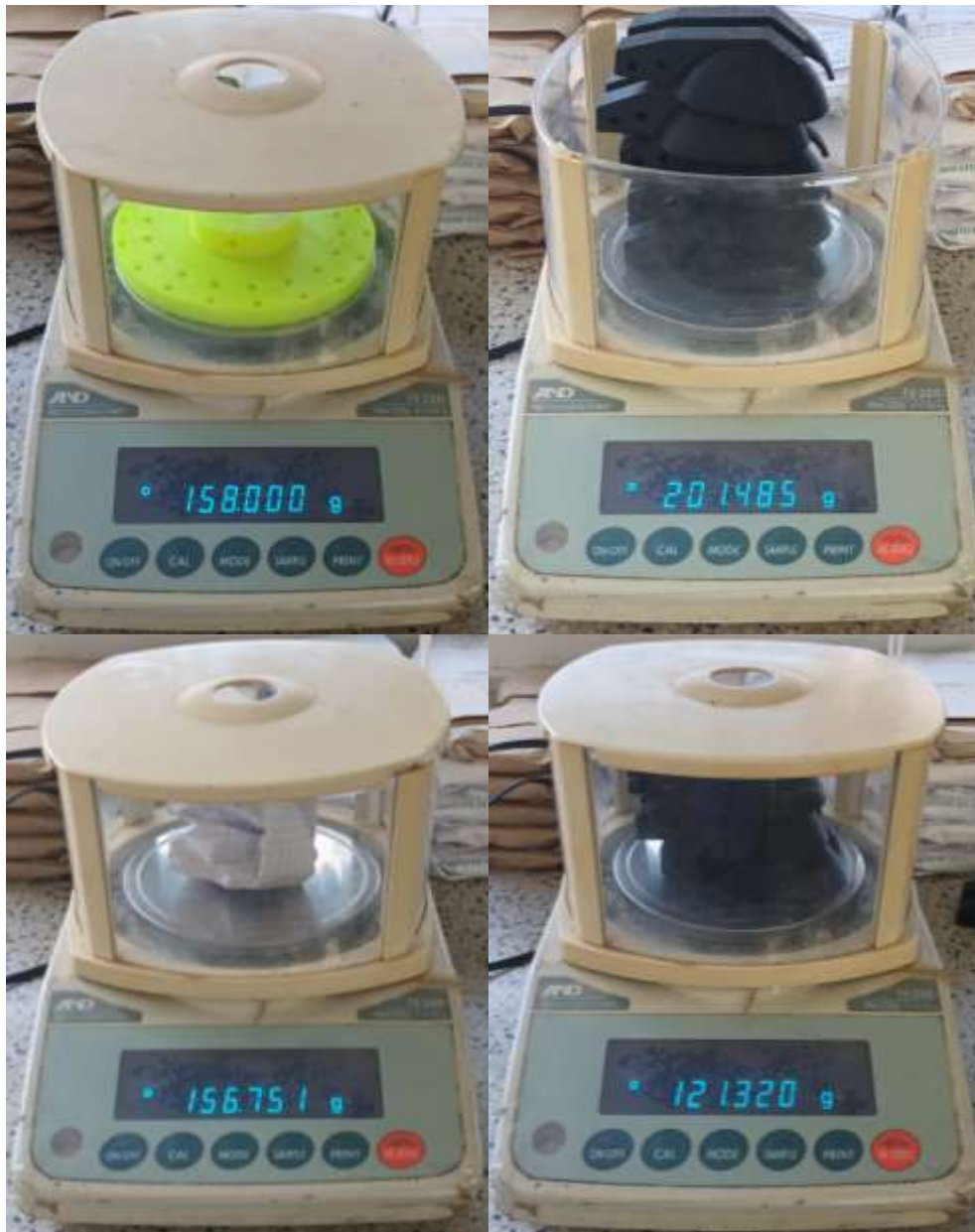
Anexo 12. Peso de las microturbinas tipo Pelton impresas en 3D con PLA para la microturbina del 75 % de relleno.
