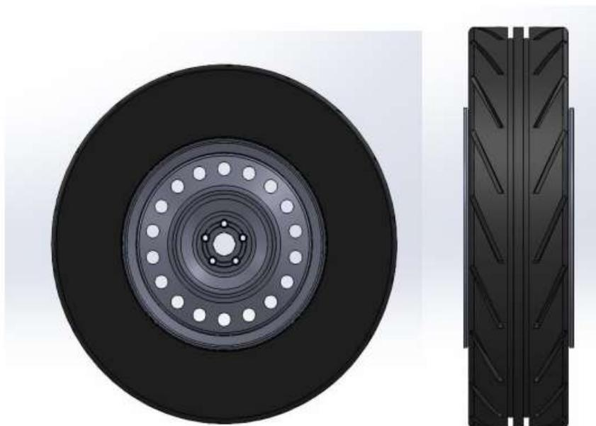
**Figura 20.** Vista lateral y frontal de neumáticos 7.00R16 diseñado para el furgón techado 5 ton.
