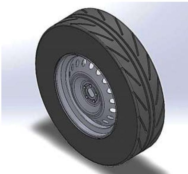
**Figura 19.** Isométricos neumáticos 7.00R16 diseñado para el furgón techado 5 ton.
