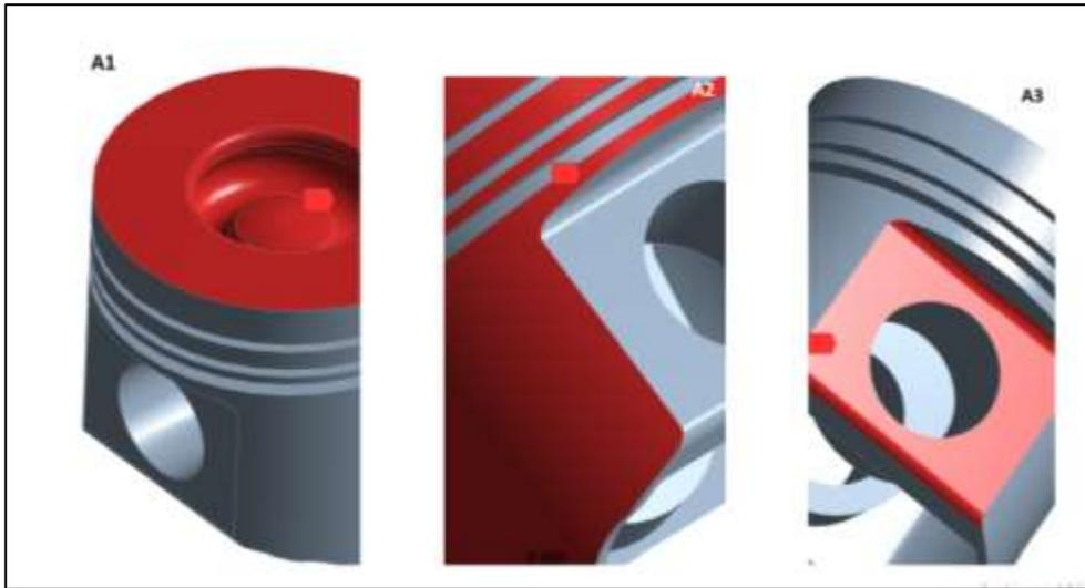
Figura 15. Zonas de interés utilizadas en el análisis para el pistón.
