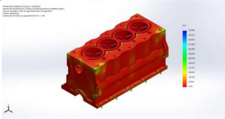
BLOQUE DE 4 CILINDROS-Análisis estático monoblock gasolina-Factor de seguridad-Factor de seguridad1
