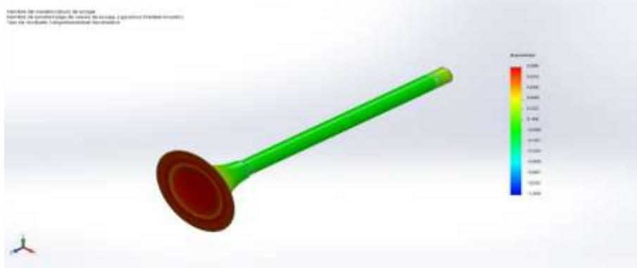
**Válvula de escape-Fatiga de válvula de escape a gasolina-Resultados-Resultados4**
