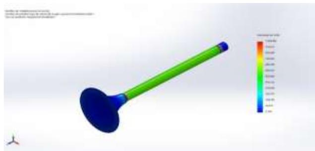
Válvula de escape-Fatiga de válvula de escape a gasolina-Resultados-Resultados1
