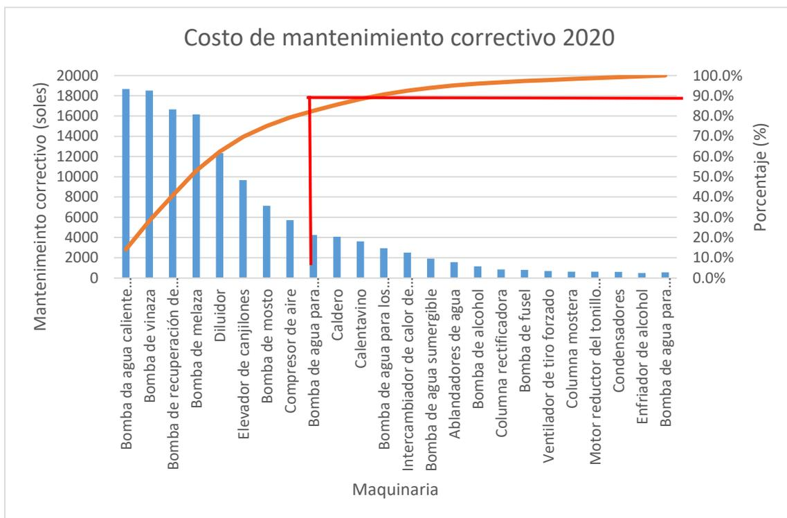
Fig. 29 Diagrama 20-80 de las máquinas de ERSA realizado en base a su costo de mantenimiento
