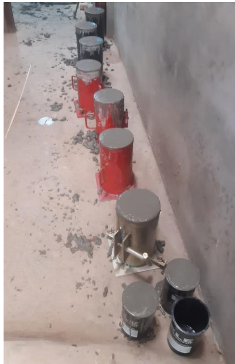
Fig. 46. Vaciado de probetas cilíndricas.
