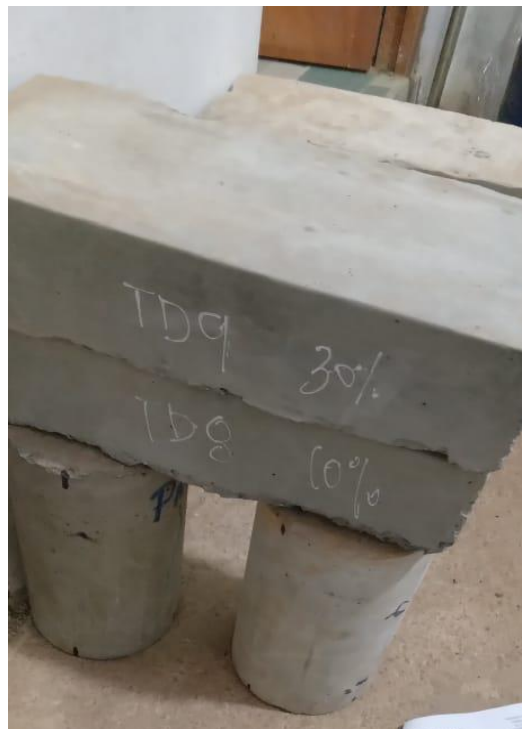
Fig. 48. Muestras para ensayo a flexión.
