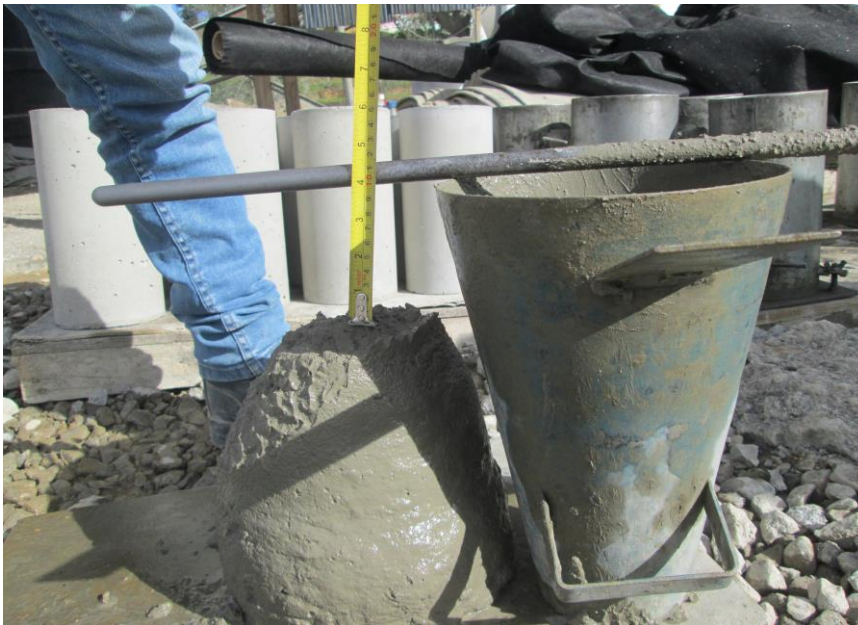
Fig. 44. Control del asentamiento SLUMP en el concreto fresco.
