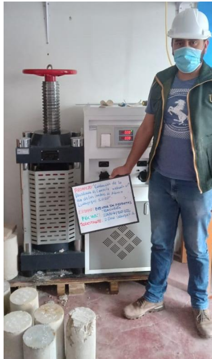
Fig. 51. Rotura de probetas, ensayo a compresión.
