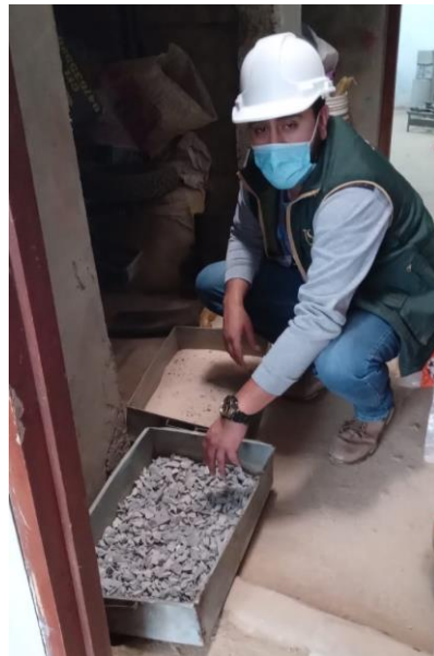
Fig. 42. Análisis granulométrico por tamizado, piedra chancada.
