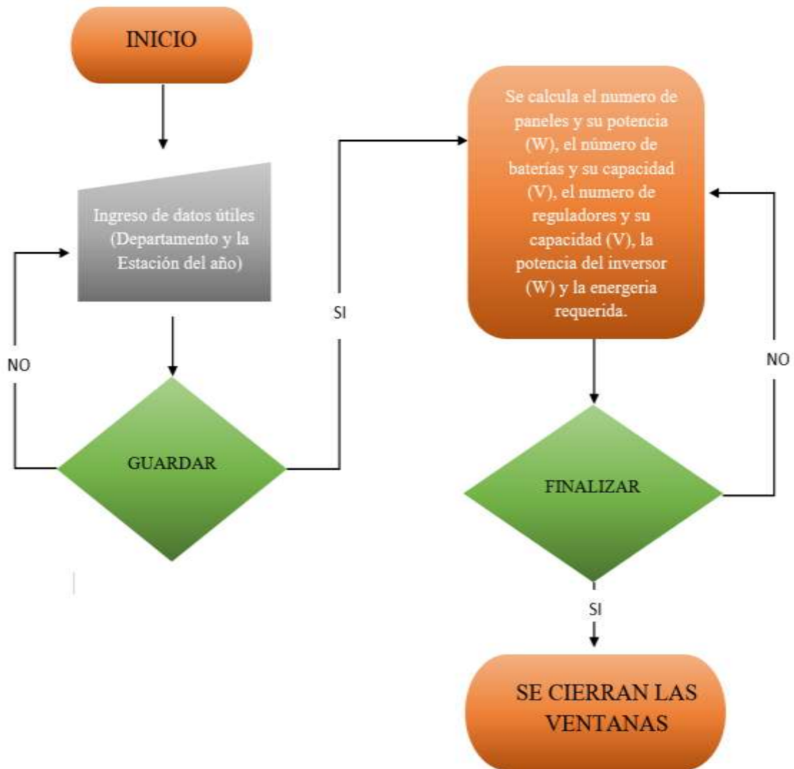
Diagrama 6: Diagrama de flujo GUI sistema fotovoltaico
