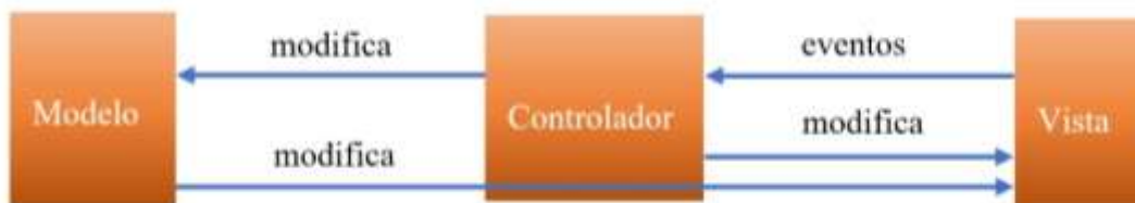
Figura 13: Patrón de diseño arquitectónico MVC
