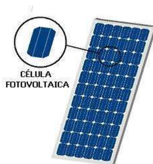
Figura 3: Panel Solar Fotovoltaico
