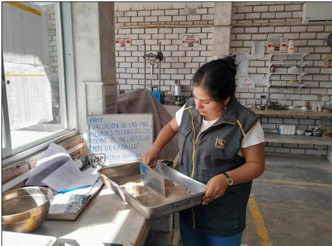
**Fig. 6.** Realizando el cuarteo para extraer una cantidad determinada
