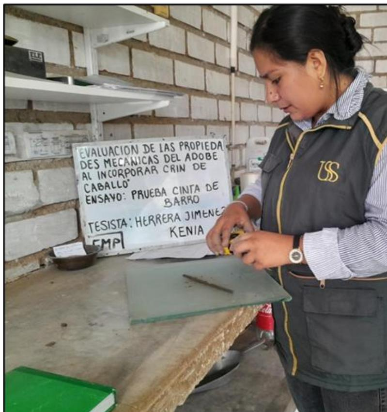
**Fig. 15.** Prueba de cinta de barro
