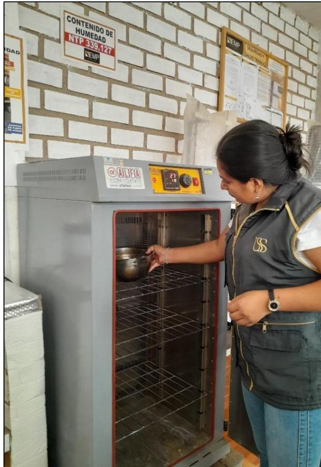
**Fig. 10.** Muestra colocada al horno  $T^{\circ}=110^{\circ}\text{C}$ , para su respectivo secado
