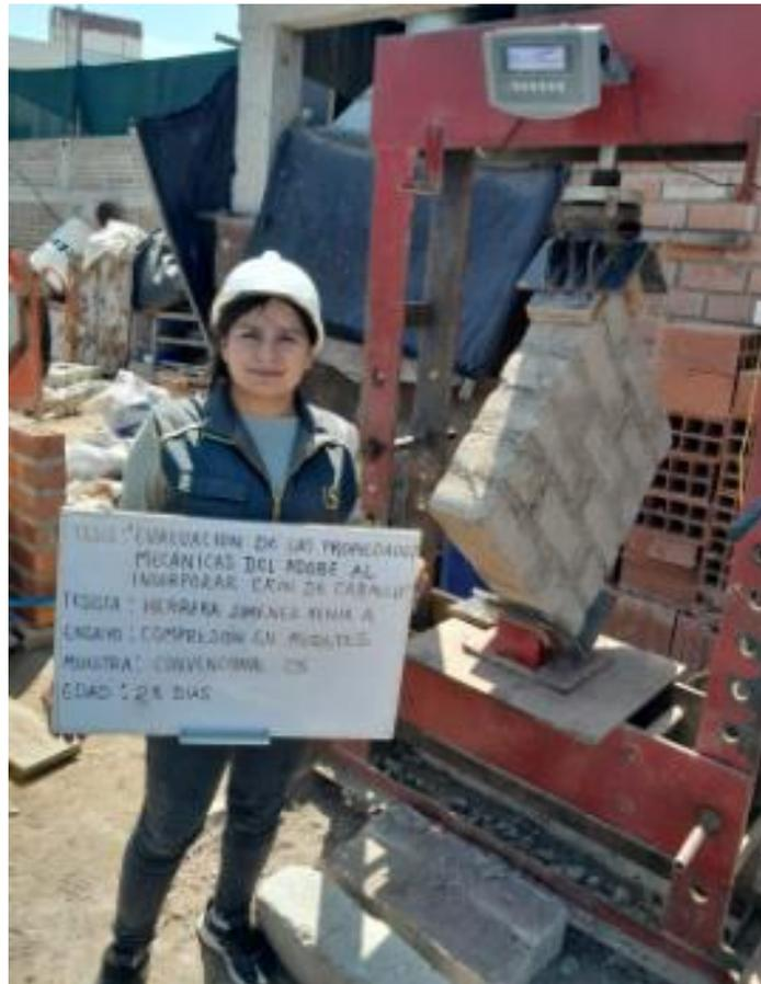
**Fig. 29.** Ensayos de resistencia a la compresión diagonal aplicado en muretes.
