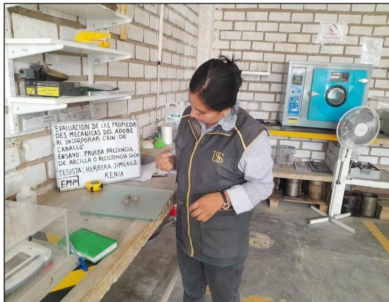
Fig. 16. Bolita de prueba de presencia de arcilla
