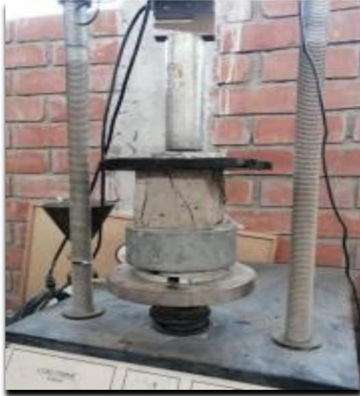
**Fig. 24.** Muestra de adobe sometido a la carga axial, del ensayo de resistencia a la compresión
