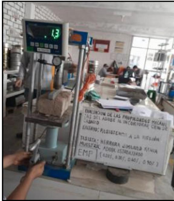
**Fig. 25.** Ensayo de resistencia a la flexión para las unidades de adobe
