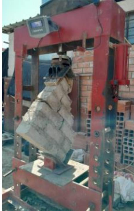
**Fig. 30.** Deformación del murete
