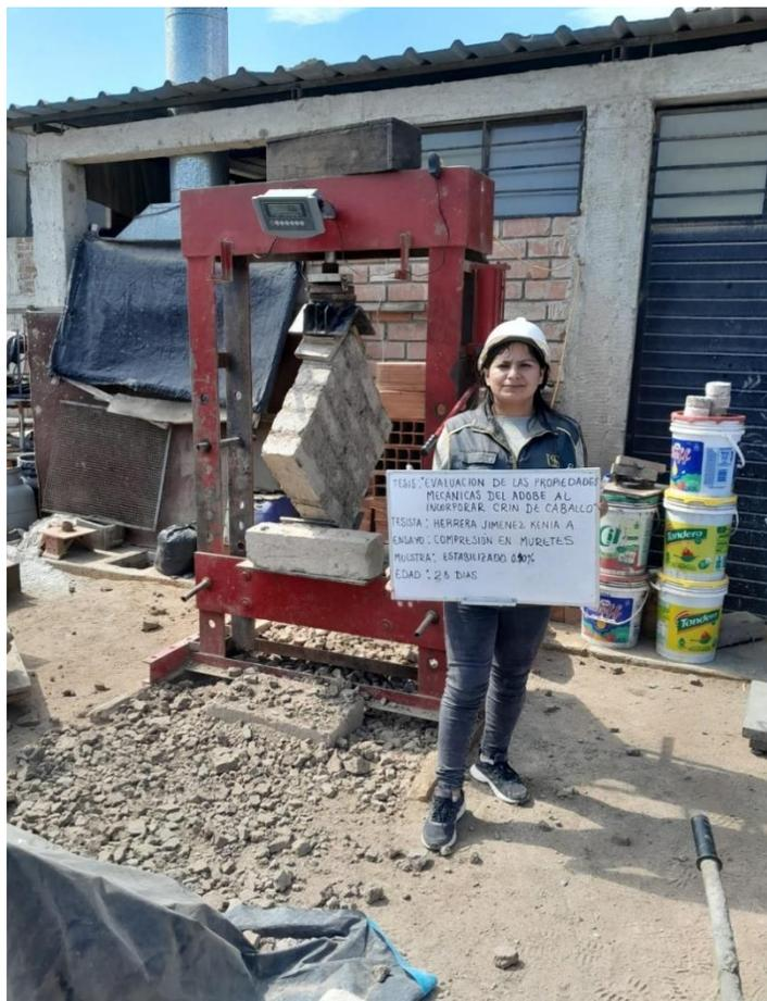
Ensayo de compresión axial para muretes
