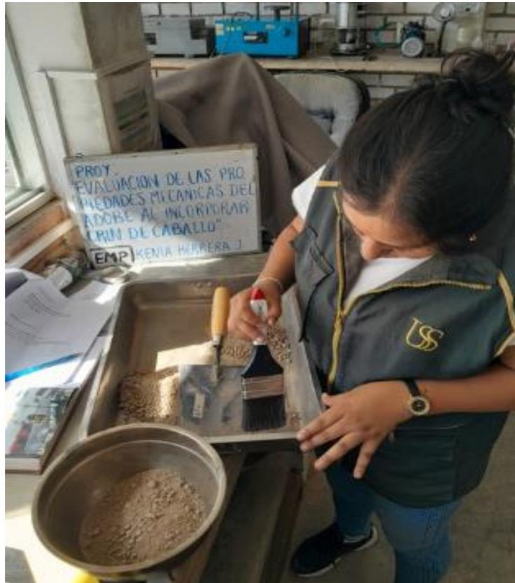
Separación de muestras para el ensayo de contenido de humedad.
