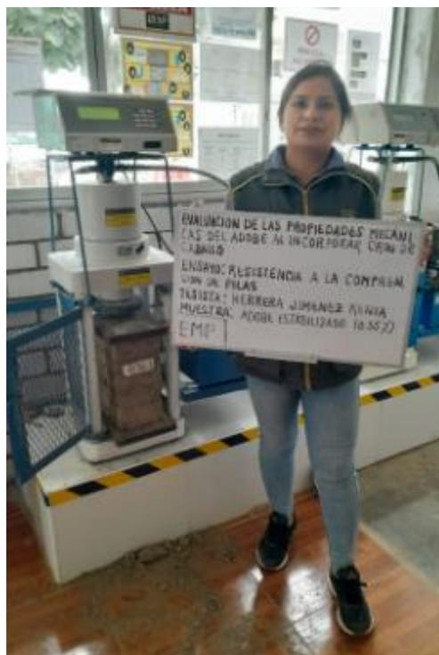
**Fig. 28.** Pilas a ensayo de resistencia a la compresión.
