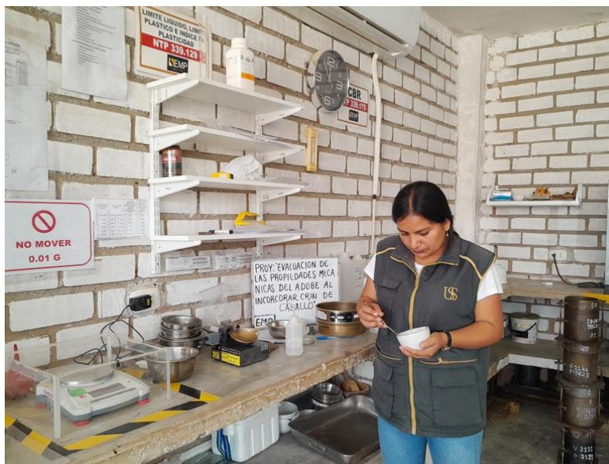
**Fig. 12.** Obtención de la pasta uniforme
