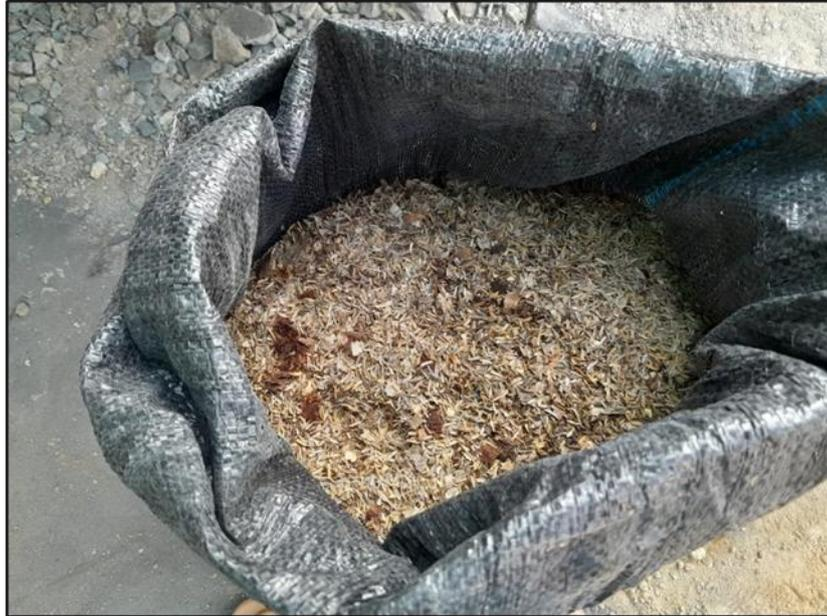
**Fig. 18.** Pajilla que se utilizó para la fabricación de adobes
