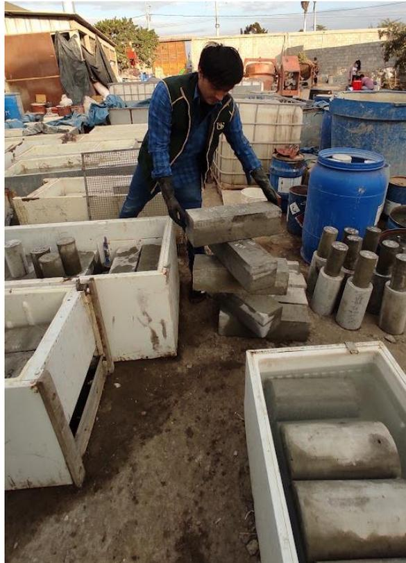
**Fig. 14.** Termino de acuerdo de probetas, para evaluación de las resistencias requeridas.
