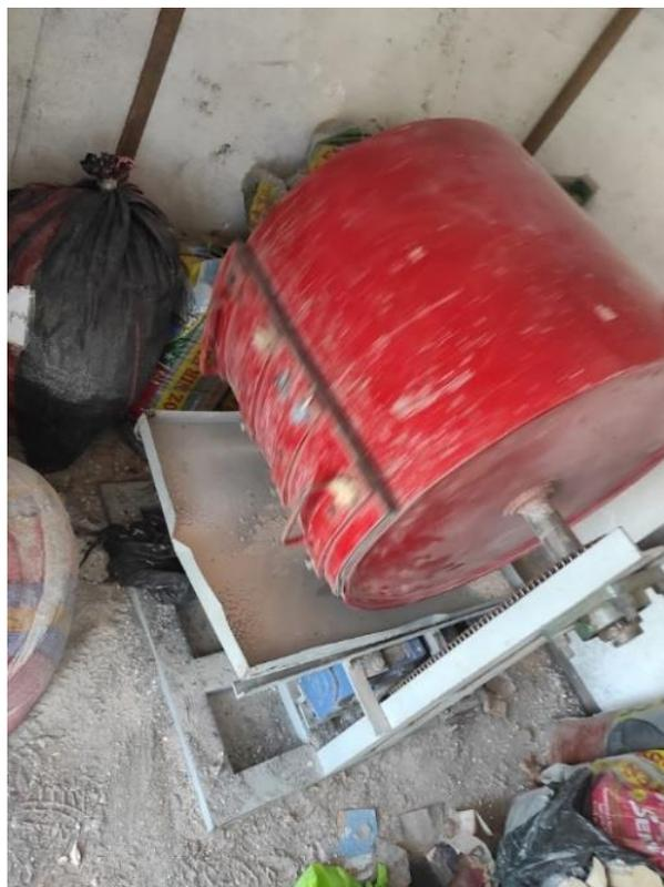
**Fig. 13.** Ensayo de agregado grueso máquina de los Ángeles
