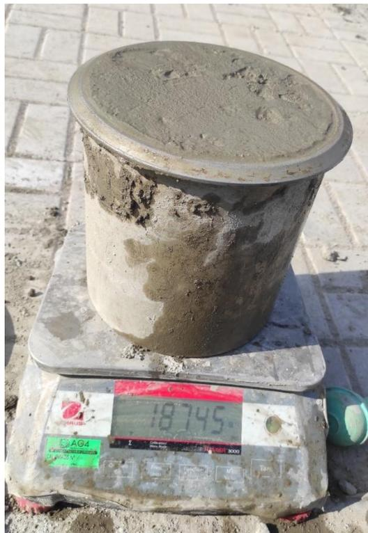
**Fig. 17.** Medición de peso unitario de concreto en estado fresco.
