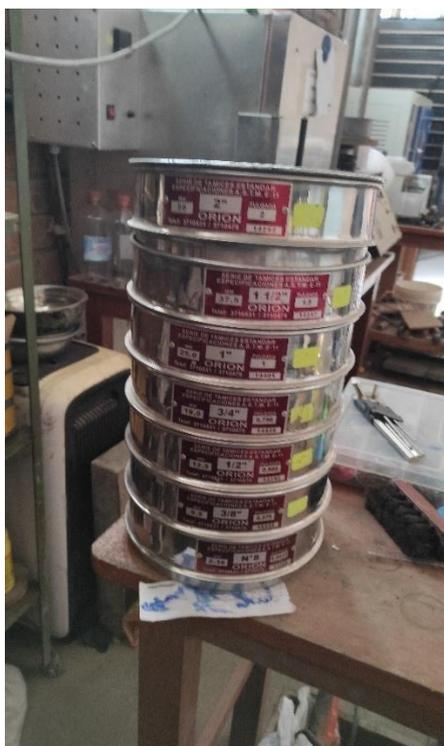
**Fig. 9.** Tamices para el agregado grueso
