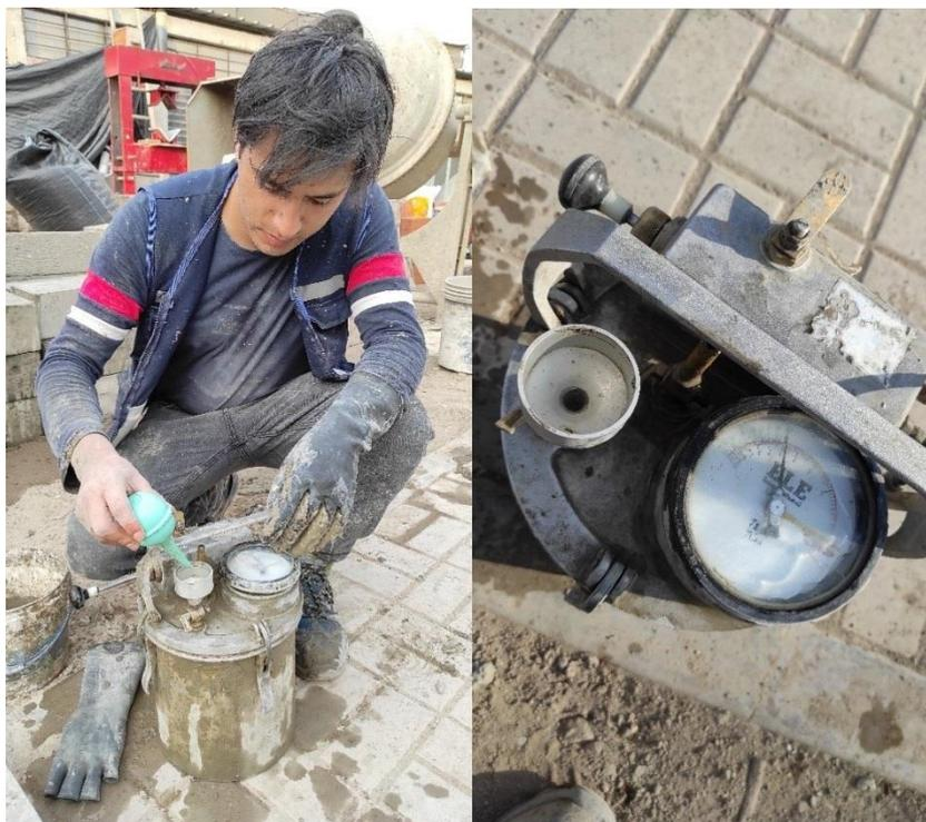
**Fig. 18.** Medición del contenido de aire atrapado en la muestra de concreto fresco
