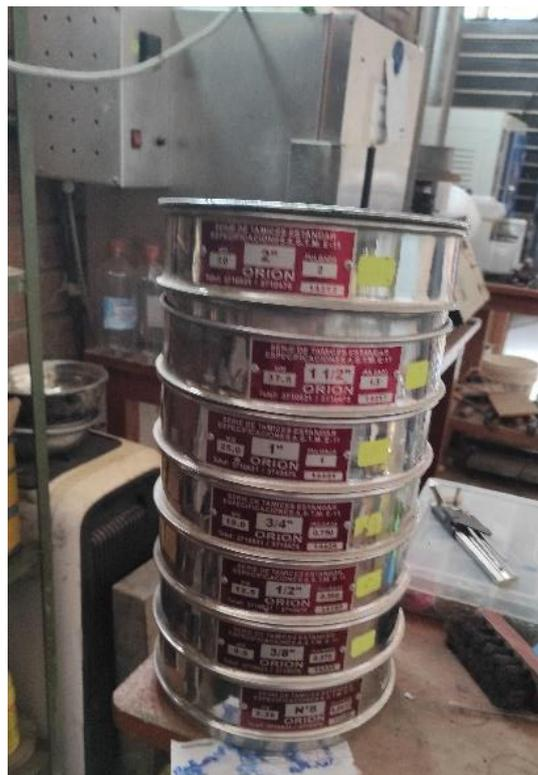
b) Disposición de mallas para tamizar el agregado fino
