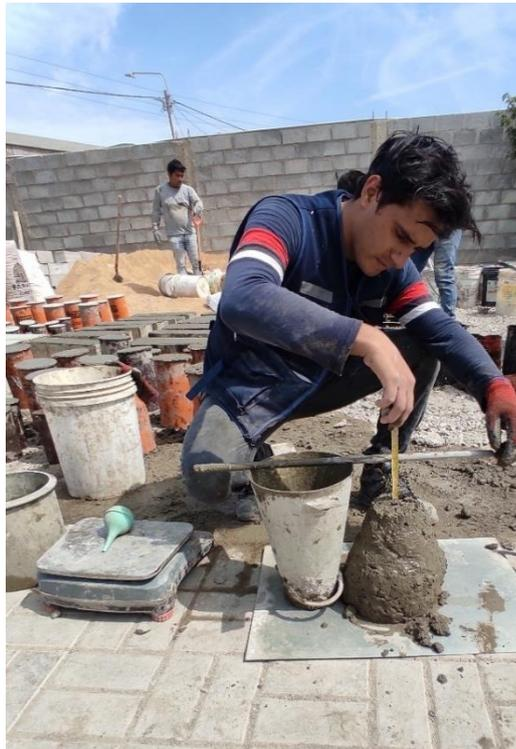
**Fig. 15.** Medición del asentamiento de concreto en estado fresco.
