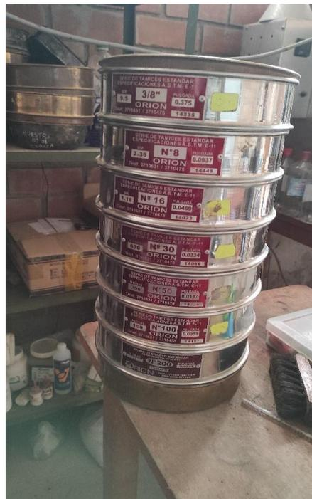
**Fig. 8.** Tamices para el agregado fino
