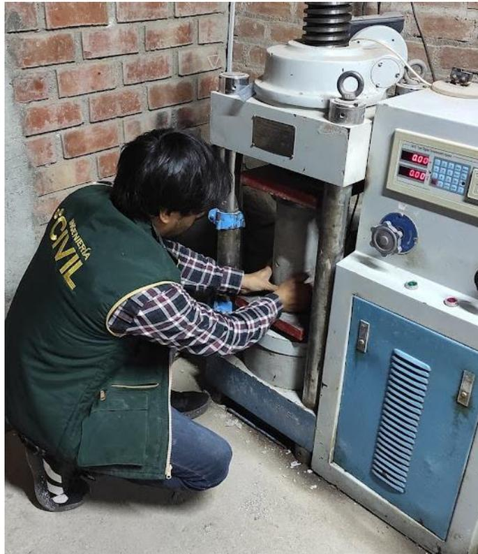
**Fig. 19.** Ensayo de resistencia a la compresión
