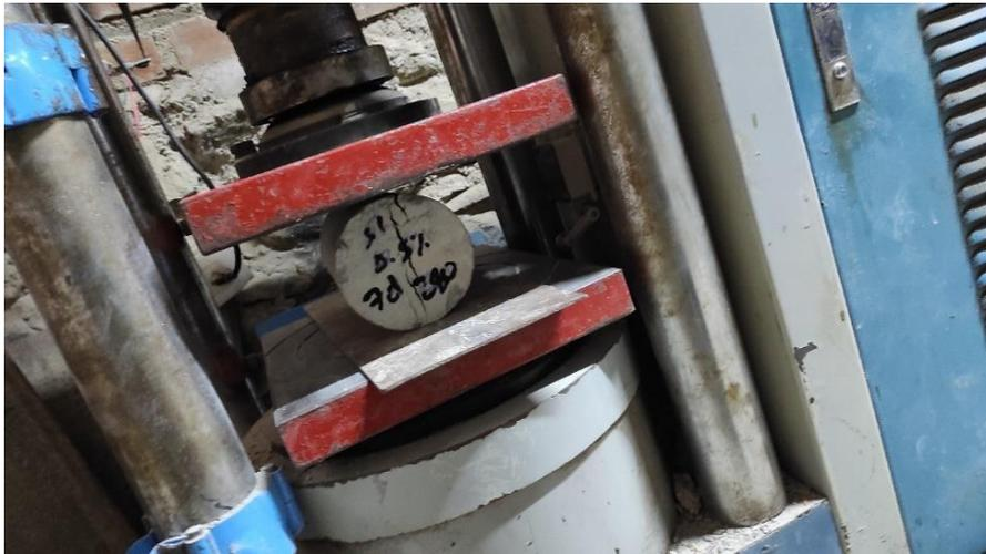
**Fig. 20.** Ensayo de resistencia a la tracción
