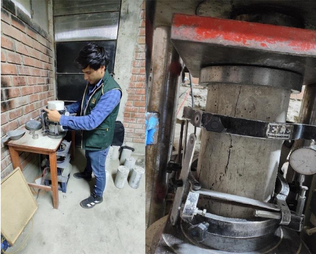
**Fig. 22.** *Ensayo de módulo de elasticidad.*
