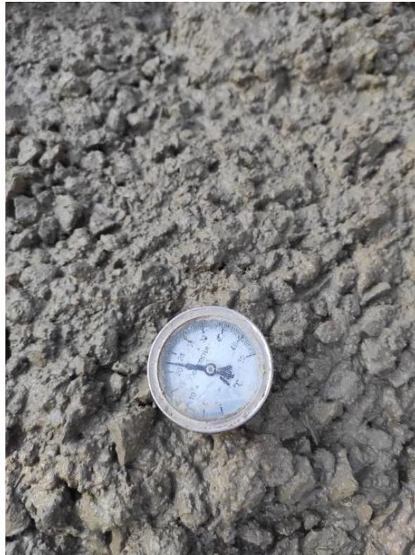
**Fig. 16.** Lectura de Temperatura de concreta en estado fresco.
