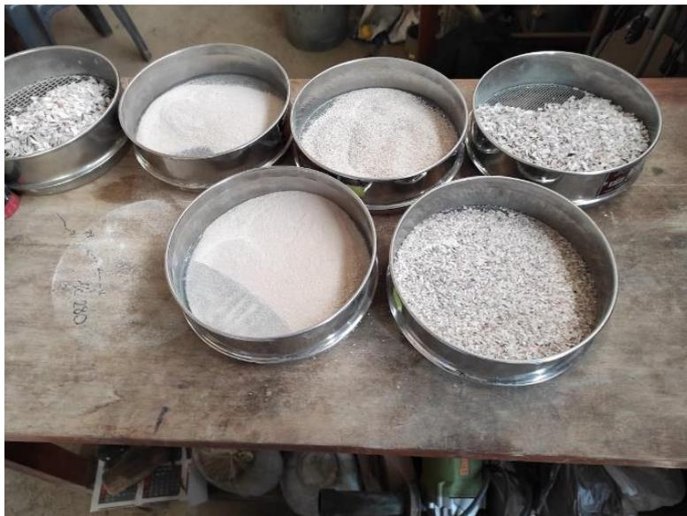
**Fig. 12.** Tamizado de agregado fino (Argopecten Purpuratus)
