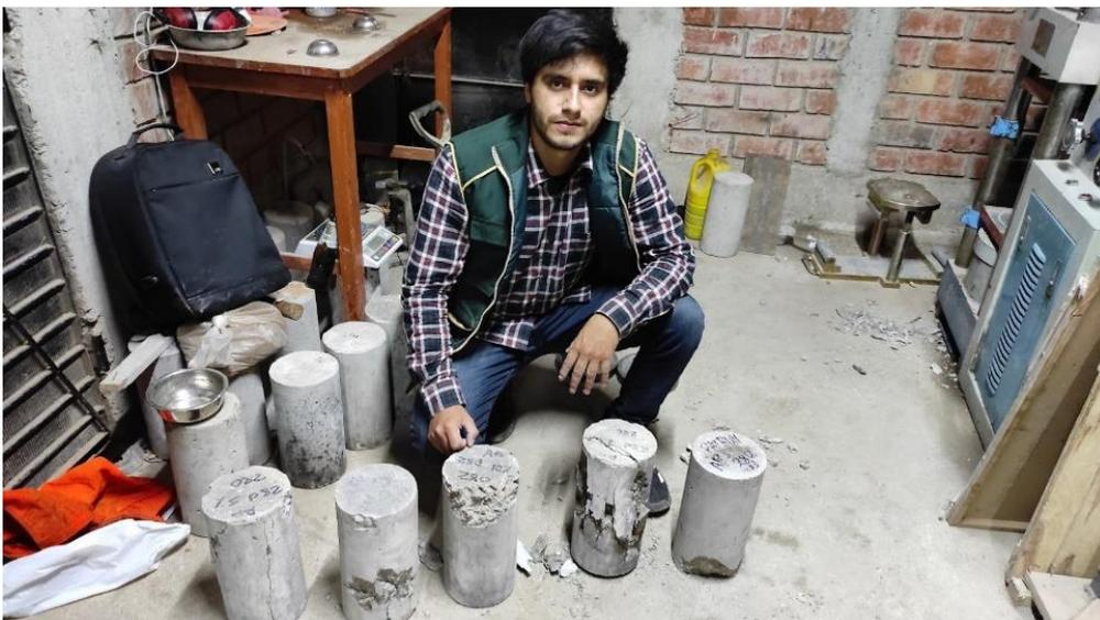
b) Ensayo de resistencia a la Tracción
