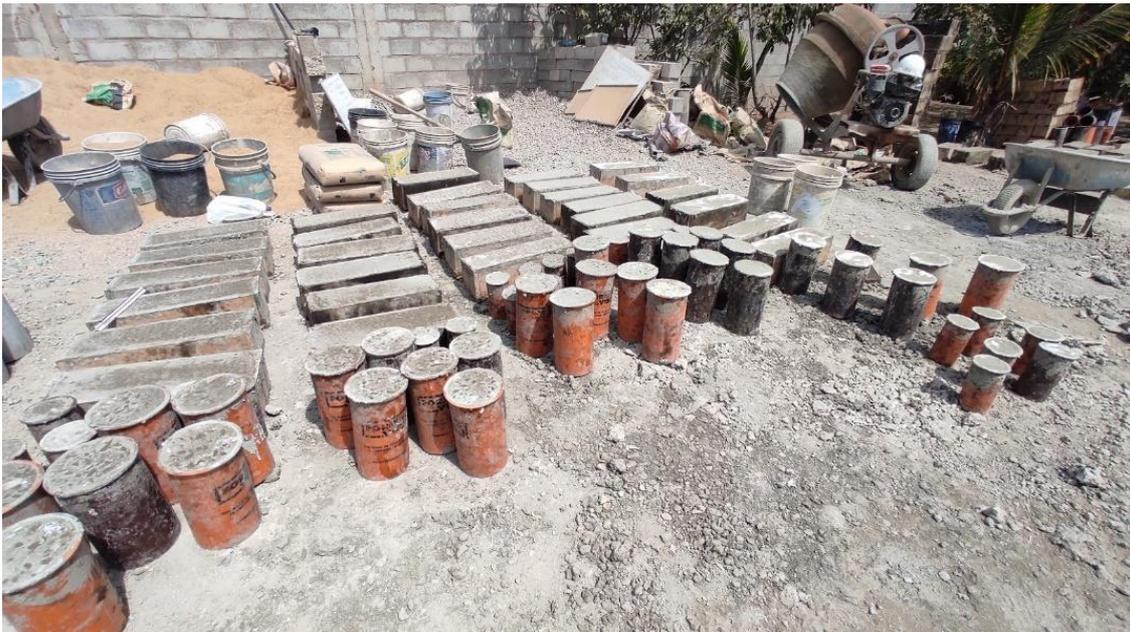
d) Acopio de probetas
