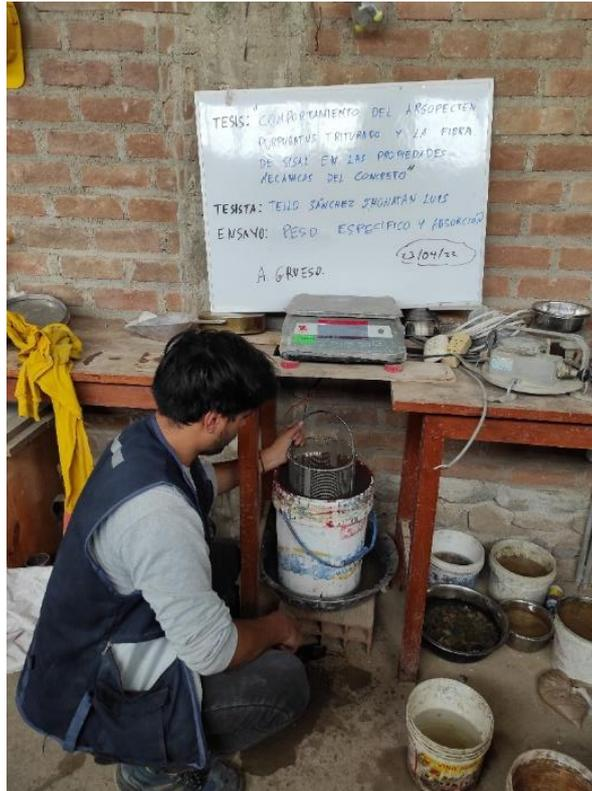
**Fig. 11.** Ensayo Peso Específico y absorción de agregado grueso
