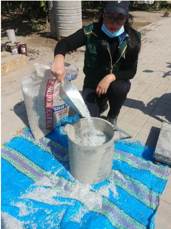
Ensayo de peso unitario del PET reciclado.
