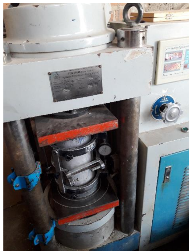
Ensayo de módulo de elasticidad.
