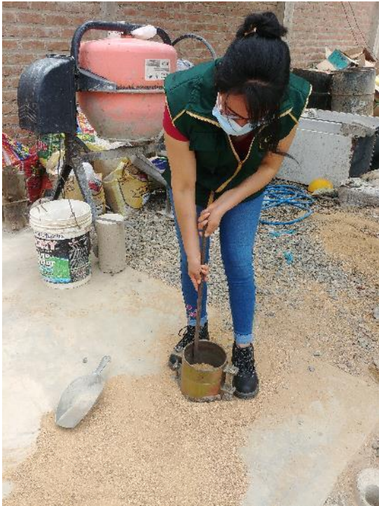
Ensayo de peso unitario de los agregados.
