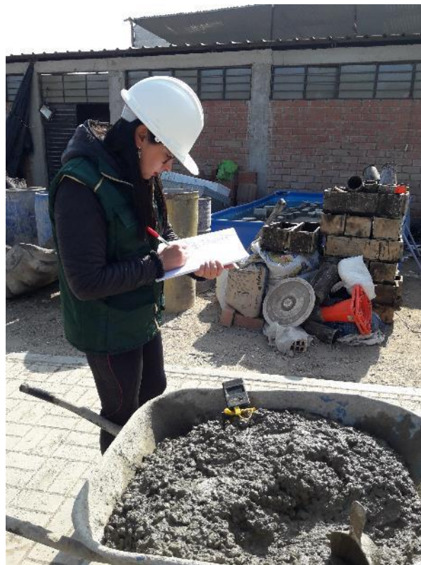
Ensayo de control de temperatura.
