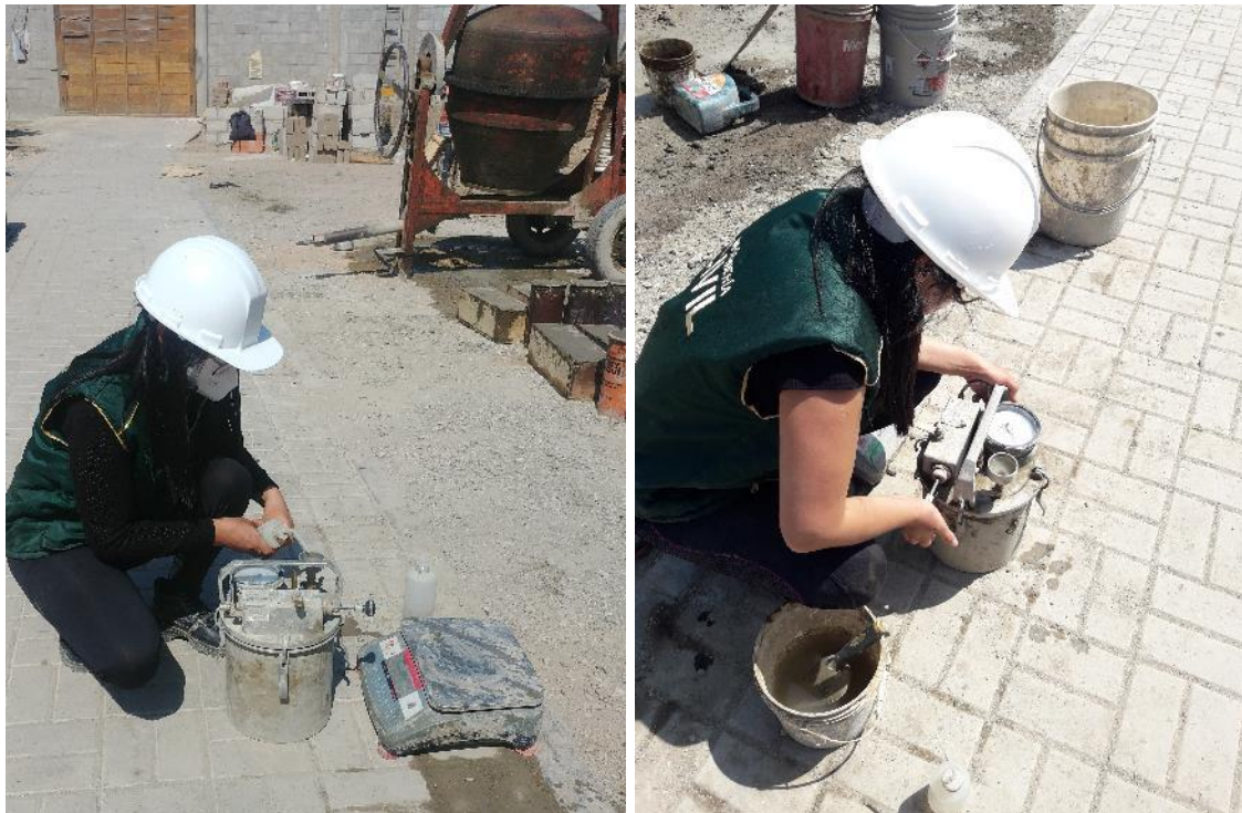
Ensayo de contenido de aire.
