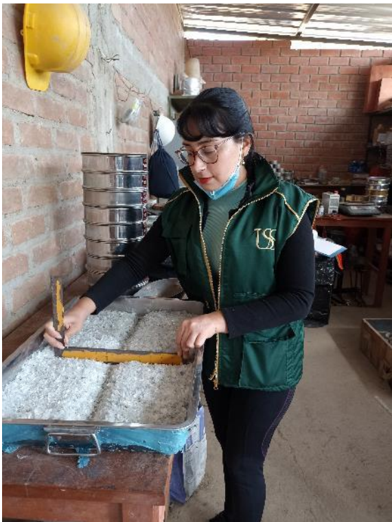
Ensayo de análisis granulométrico del PET reciclado.
