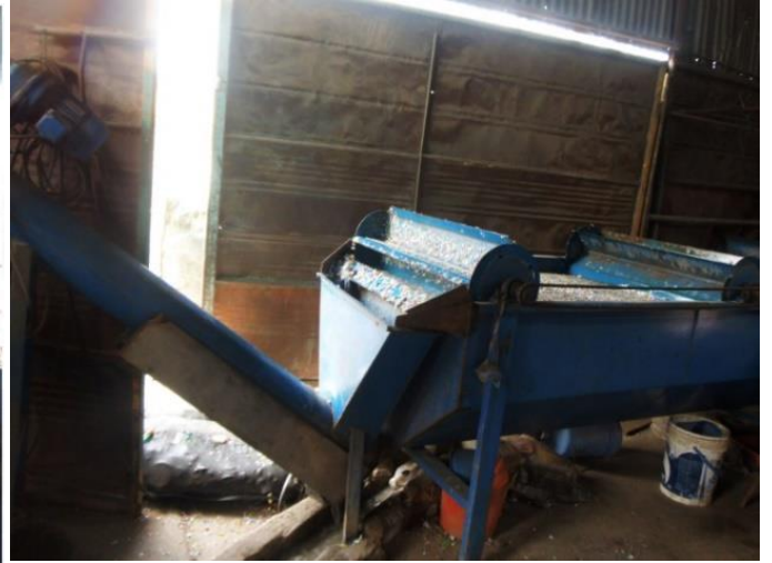
Trituración de las botellas plásticas PET en máquina trituradora.
