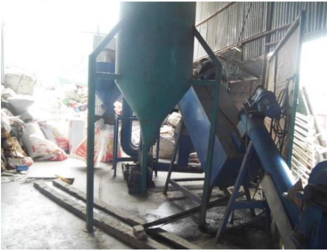
Trituración de las botellas plásticas PET en máquina trituradora.
