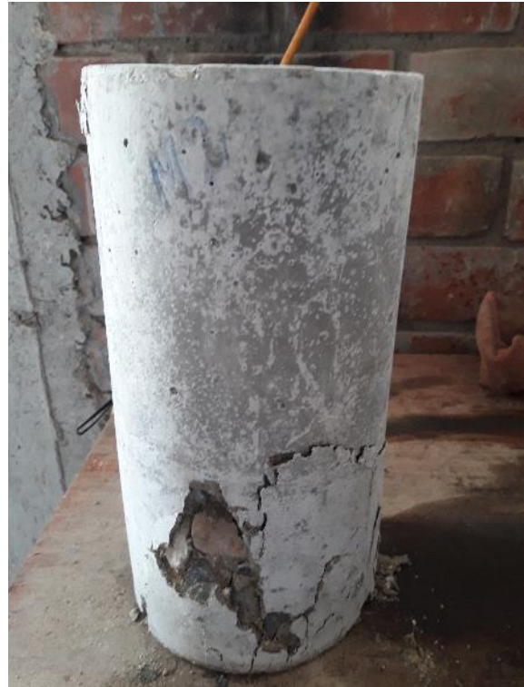
Ensayo de resistencia a la compresión.
