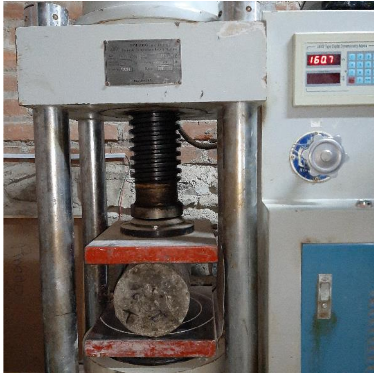
Ensayo de resistencia a la tracción indirecta.
