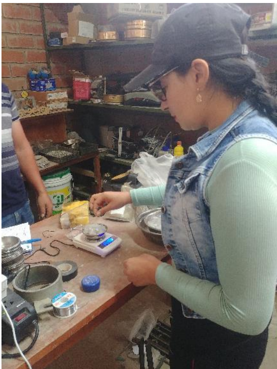
Ensayo de peso específico del PET reciclado.
