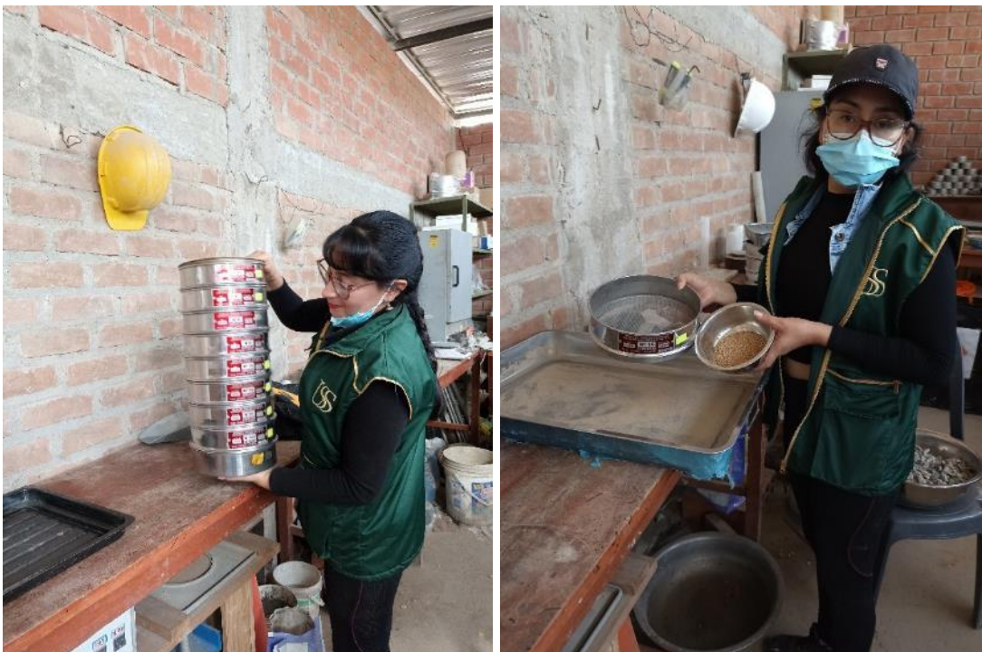
Ensayo de análisis granulométrico de los agregados.
