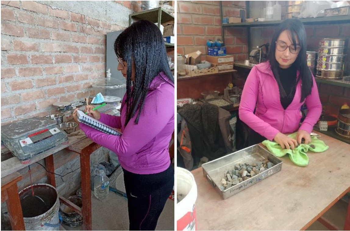
Ensayo de peso específico y absorción del agregado grueso.
