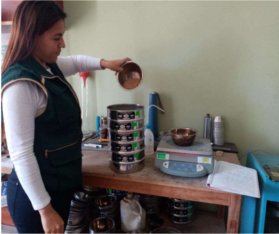
Granulometría del agregado fino
