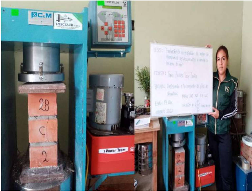
Ensayo de resistencia a compresión axial.
