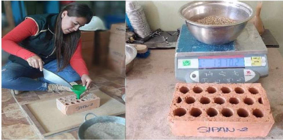
Determinación del porcentaje de vacíos en la unidad de albañilería.
