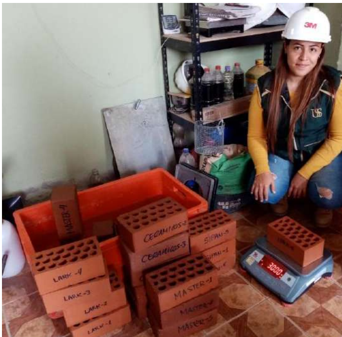
Fig. 20. Peso de unidades luego de secar por 4 horas a temperatura ambiente
