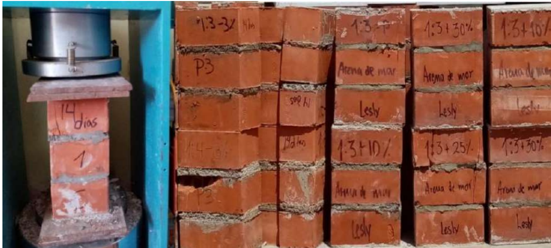
Fig. 29. Pilas analizadas a compresión axial
