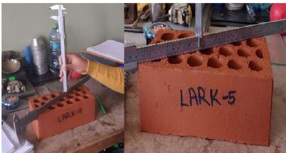
Fig. 22. Alabeo de unidades de albañilería
