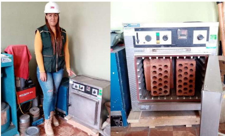
Fig. 21. Puesta de unidades al horno por 24 horas
