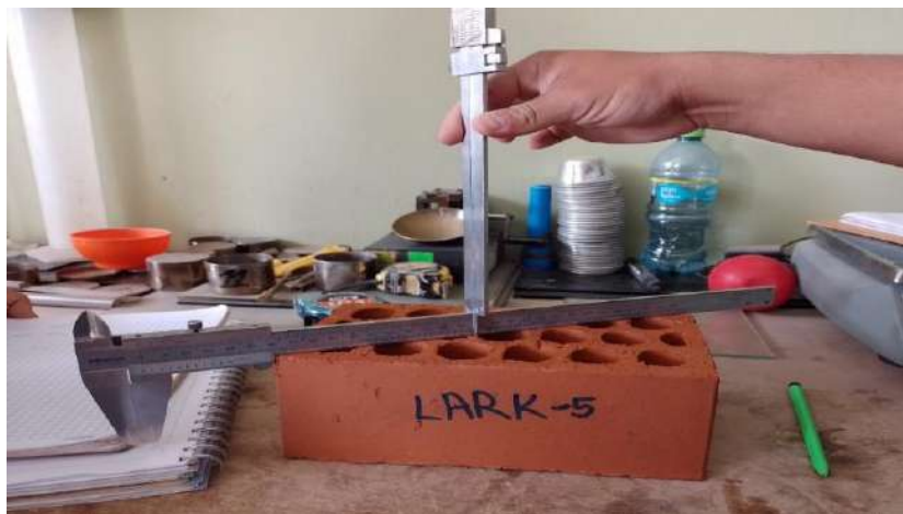
Alabeo a la unidad de albañilería.
