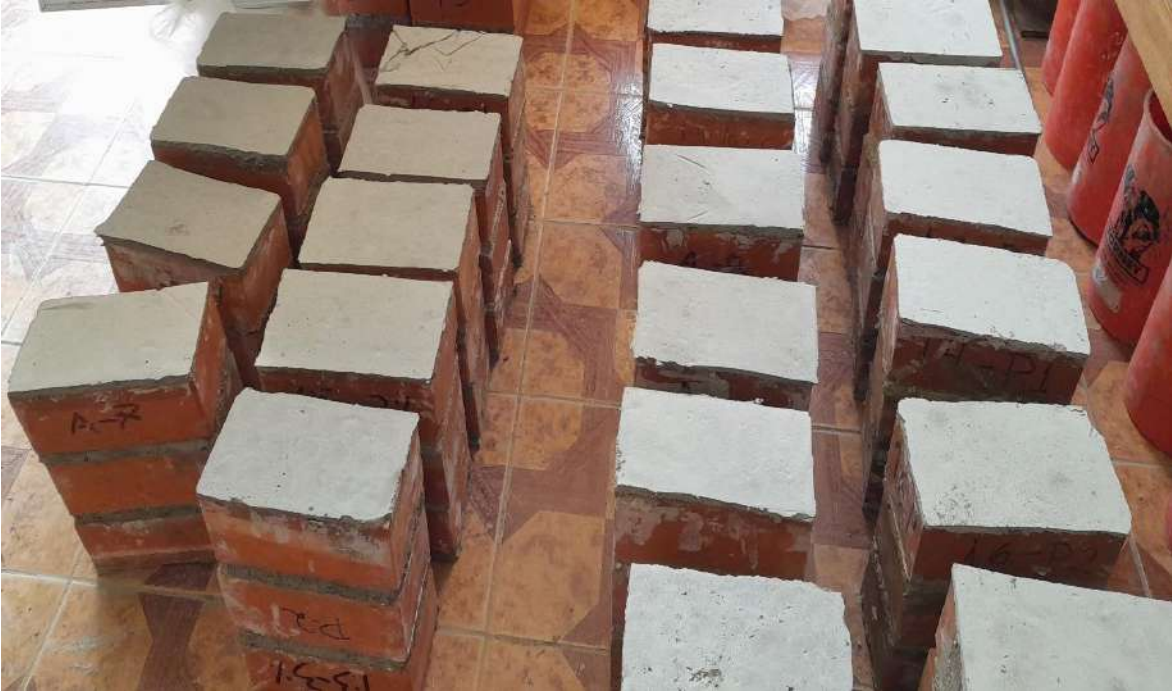
Refrentado de pilas de albañilería
