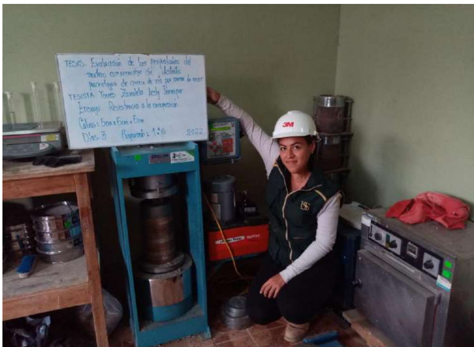
Resistencia a la compresión de mortero en cubos de 5cm por lado
