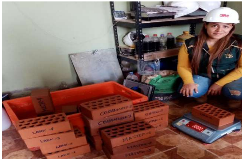
Peso de unidades saturadas para determinar el porcentaje de absorción (%).
