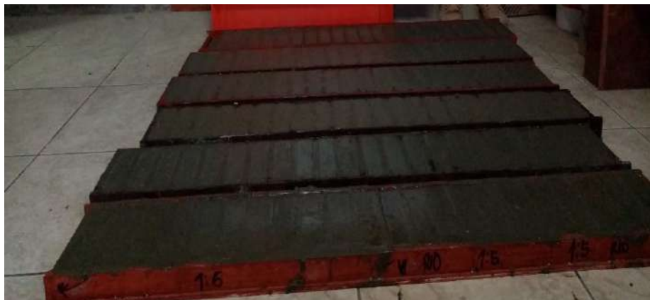
Elaboración de especímenes para compresión y flexión
