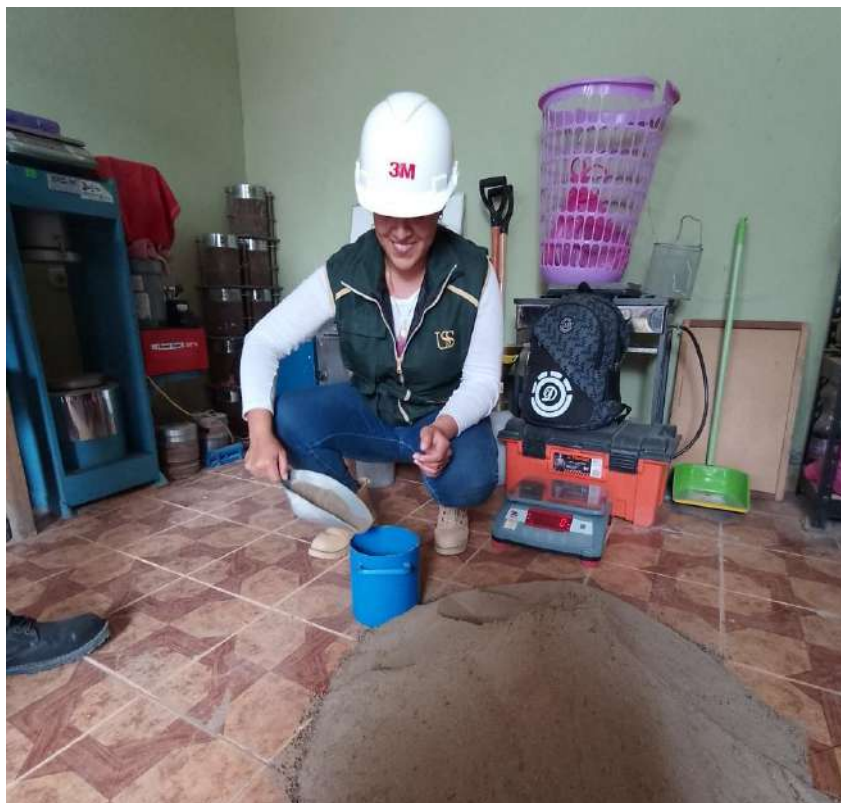
Peso unitario suelto del agregado fino.
