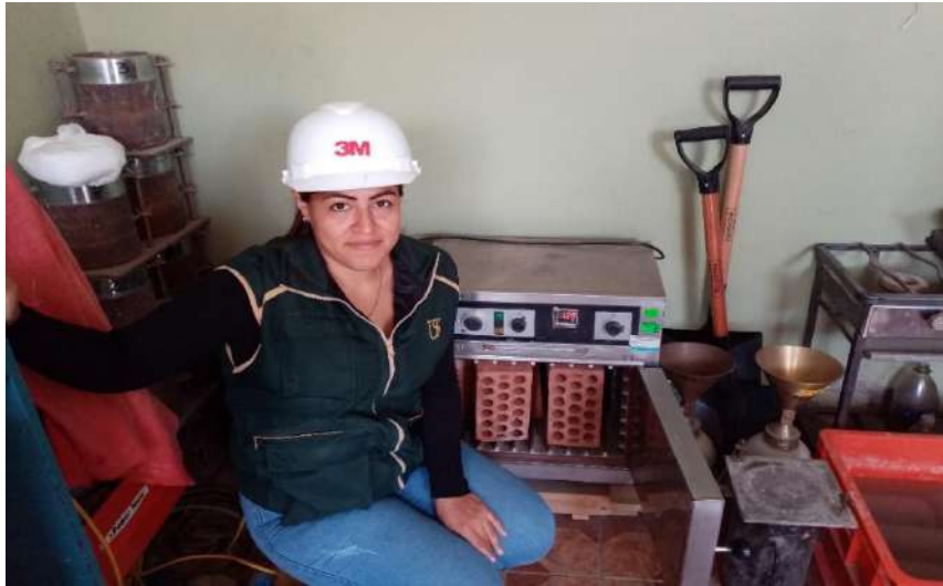
Unidades secadas al horno para ensayo de succión.
