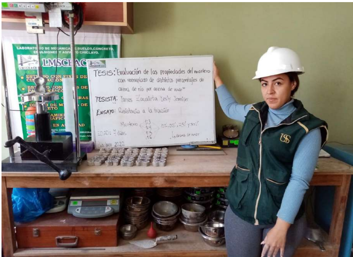
Elaboración de especímenes para tracción
