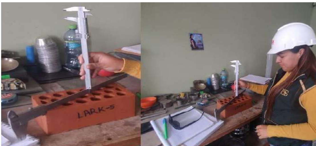
Fig. 18. Dimensiones del ladrillo empleando vernier
