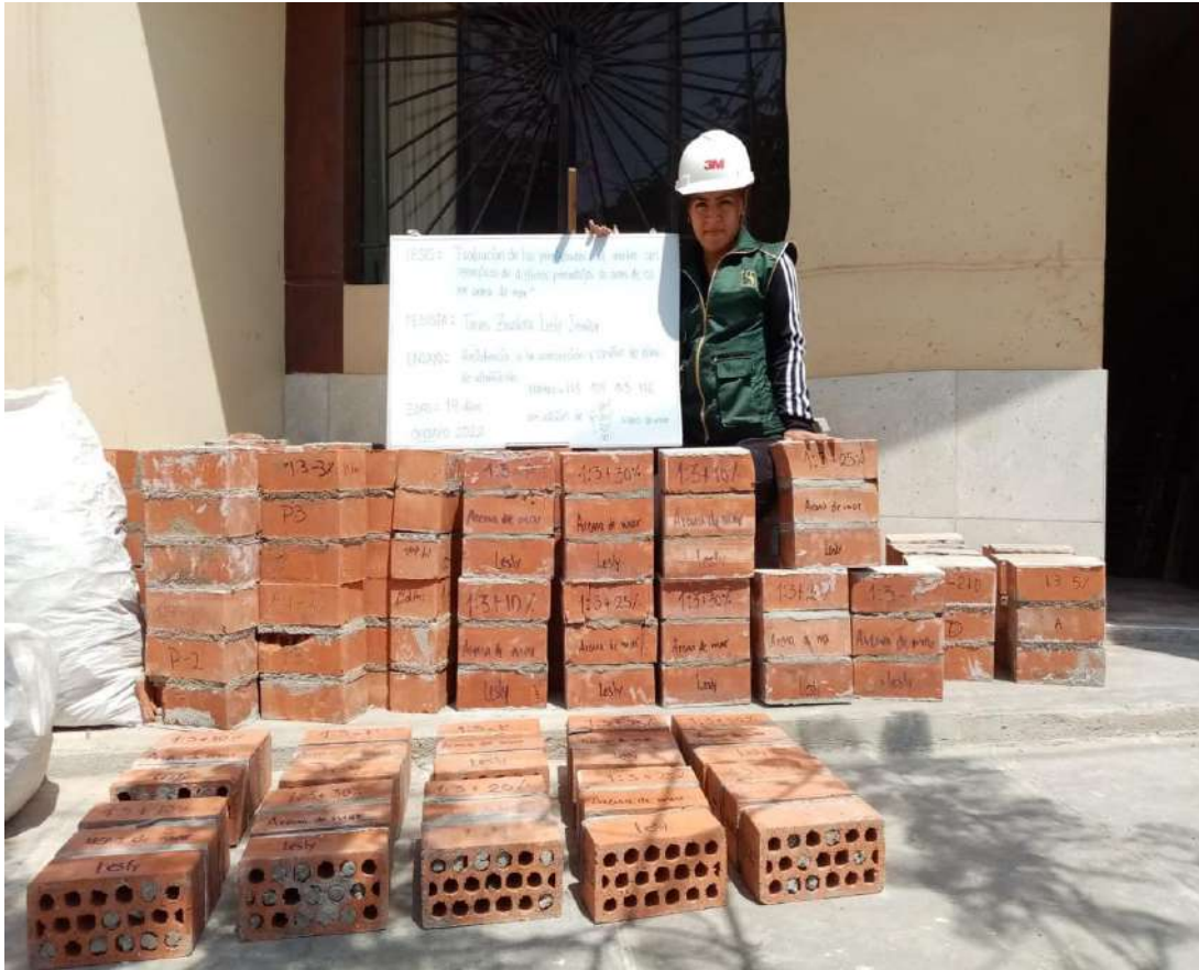
Pilas de albañilería ensayadas.
