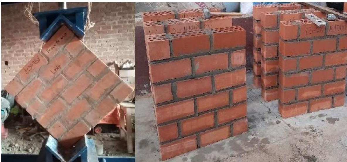
Fig. 31. Ensayo de compresión diagonal de muretes de albañilería
