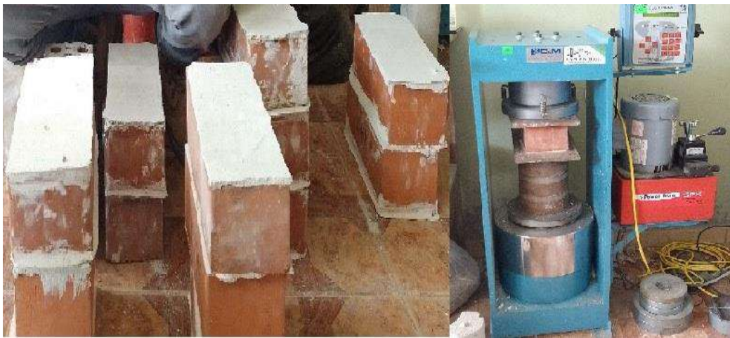
Fig. 23. Prueba a compresión del elemento de mampostería
