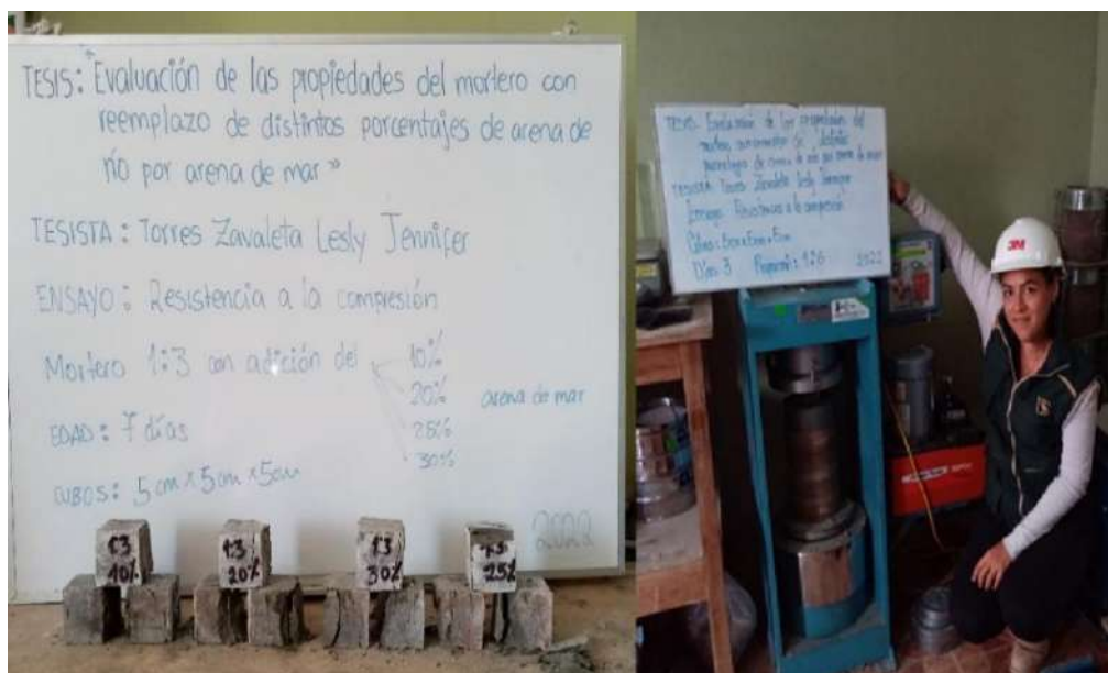
Fig. 26. Ensayo a compresión de cubos de 5 cm por lado
