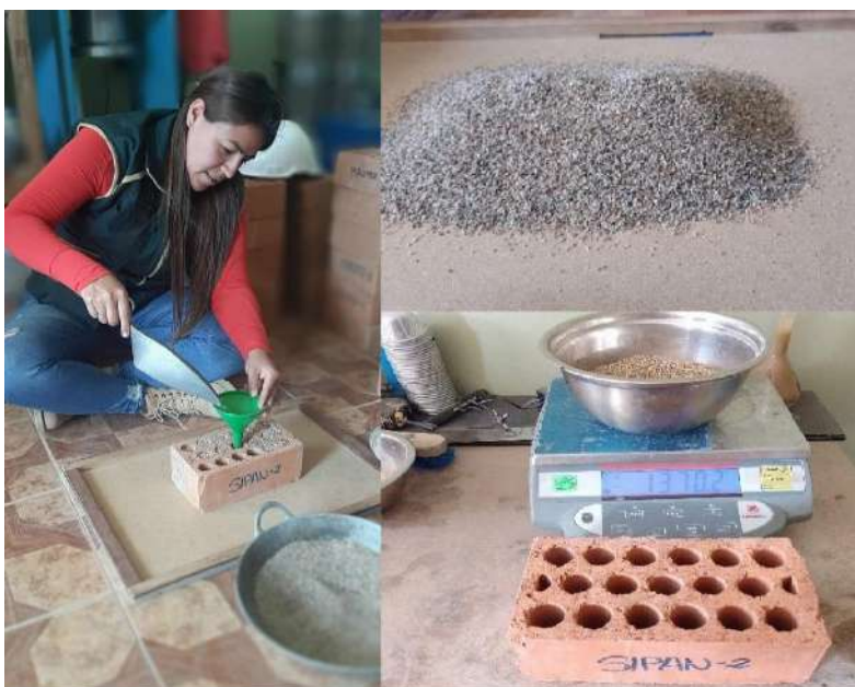
Fig. 19. Llenado de vacíos del ladrillo con arena
