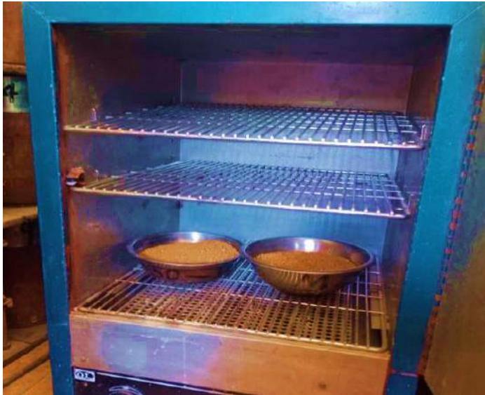
Fig. 17. Muestra colocada al horno para determinar su contenido de humedad
