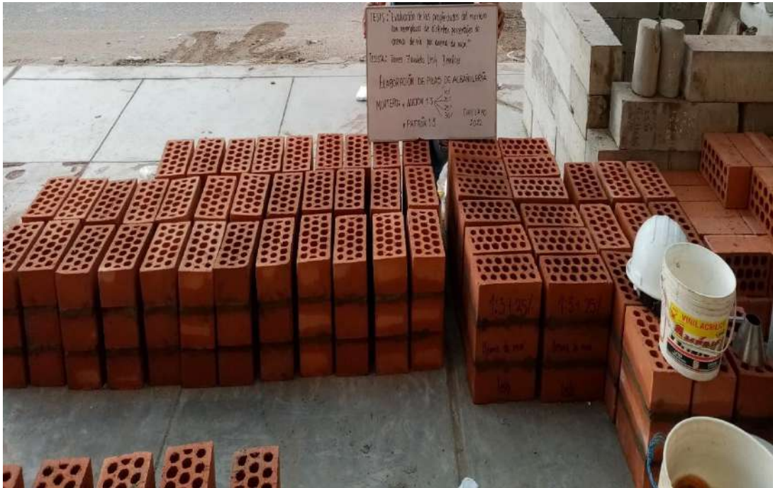
Pilas de albañilería para ensayo de adherencia por flexión
