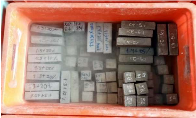
Curado de especímenes de mortero
