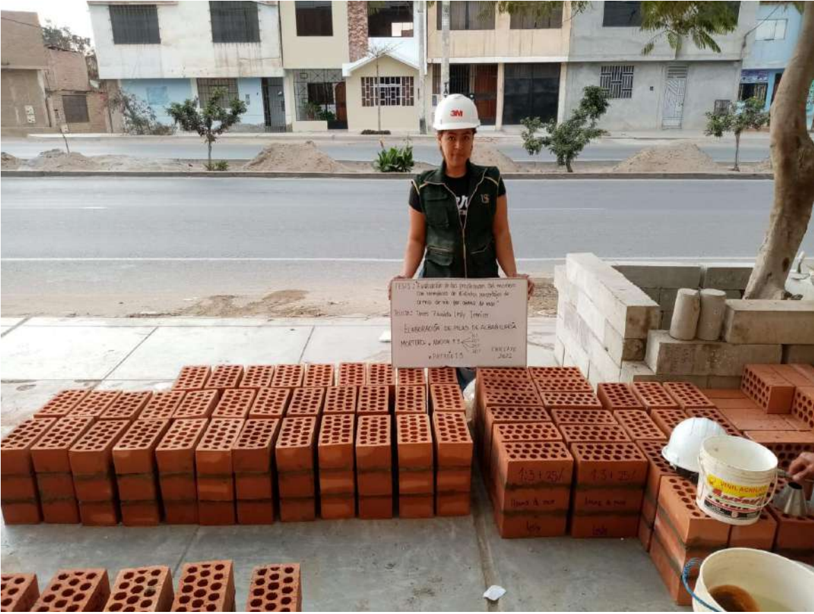
Elaboración de pilas de albañilería.
