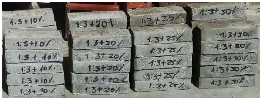
Muestras para ensayo de resistencia a la flexión
