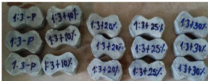
Muestras para ensayo de resistencia a la tracción
