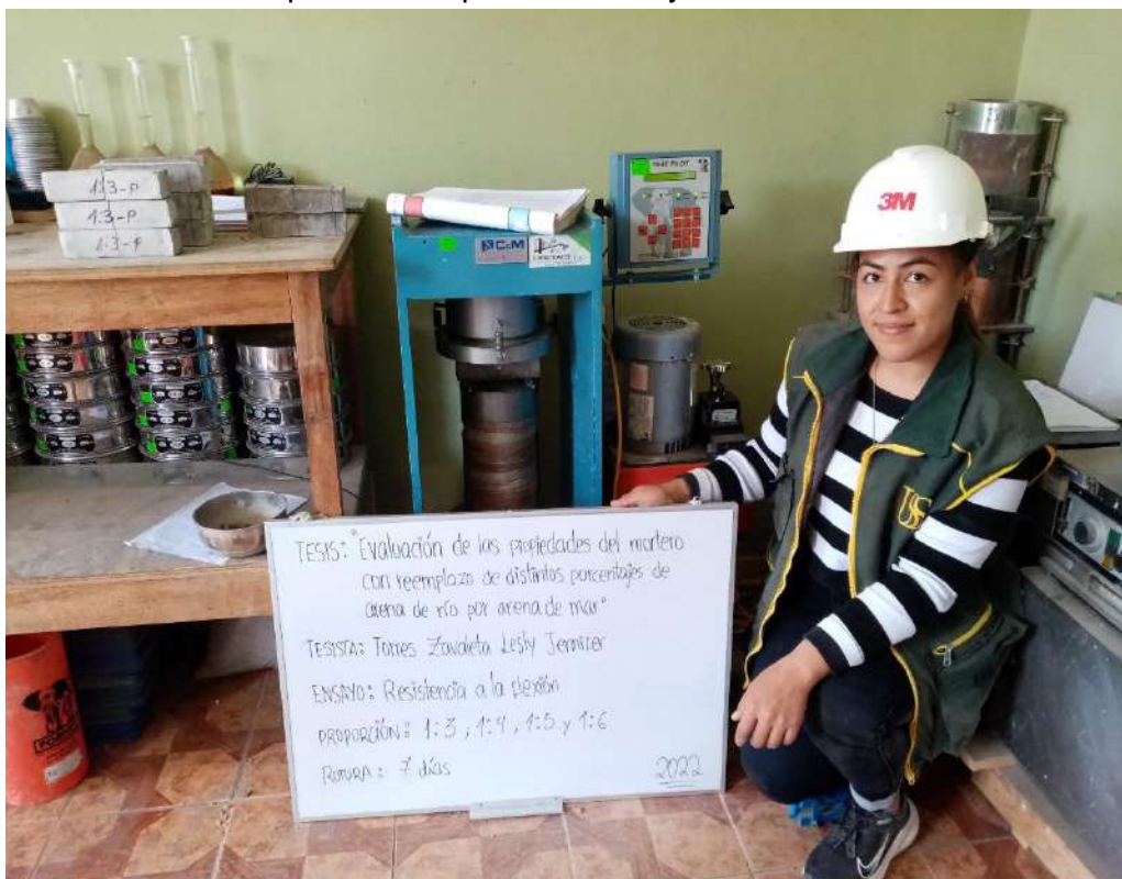
Resistencia a la flexión de mortero en barras de 4cmx4cmx16cm
