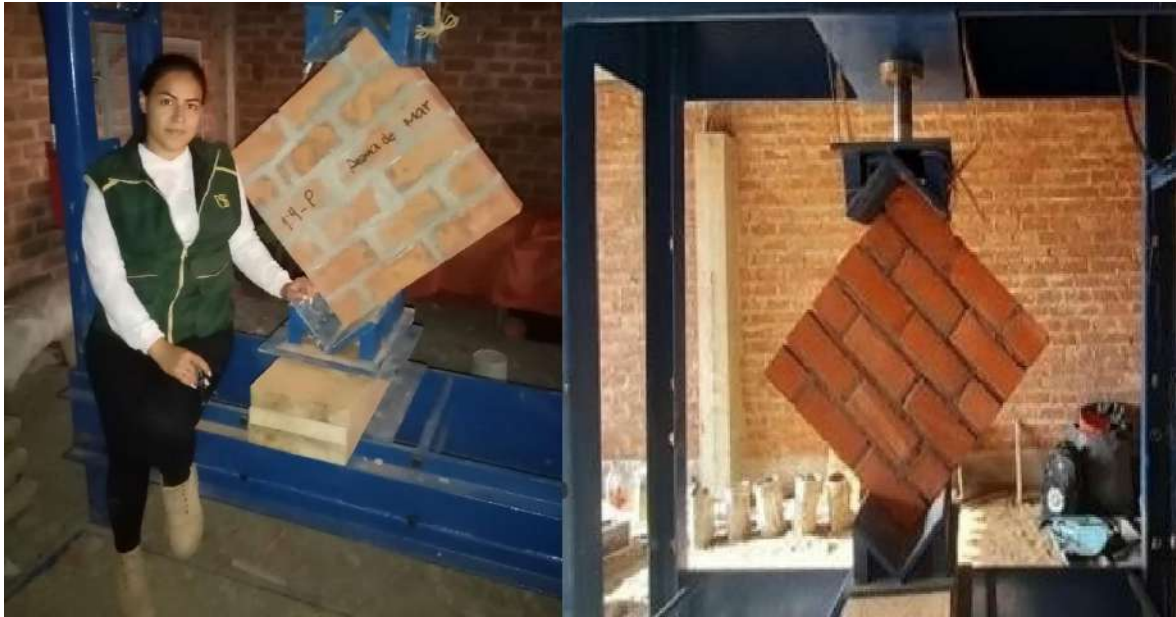
Rotura de muretes de albañilería.
