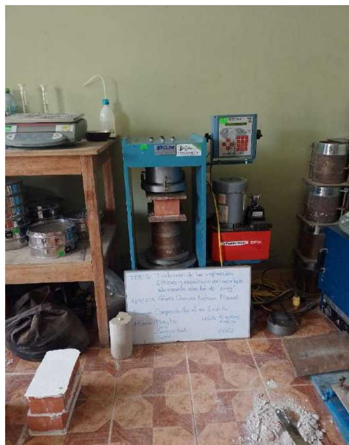
Ensayo de resistencia a compresión axial de las unidades de albañilería
