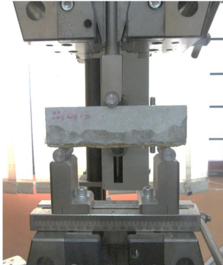
Fig. 8. La configuración de la prueba de flexión dinámica. [73]
