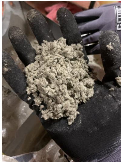
Fig. 25. Lana de Roca molida para sustituto parcial del agregado grueso.
