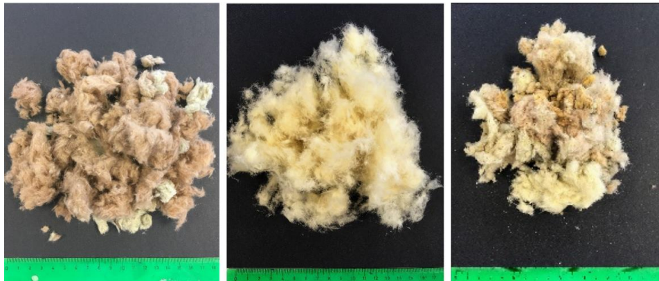
Fig. 3. Residuos de lana de roca (RW), residuos de fibra de vidrio (FG) y residuos mixtos de lana mineral (MIX). [48]
