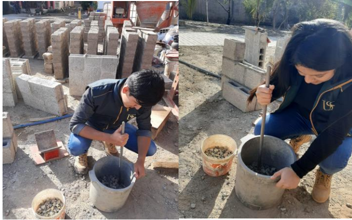
Fig. 29. Realización del ensayo de peso unitario compactado del agregado recio.
