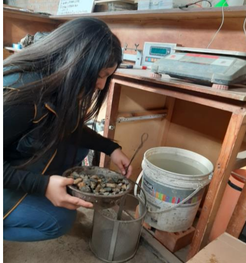
Fig. 31. Realización del ensayo de peso específico y absorción del agregado grueso.
