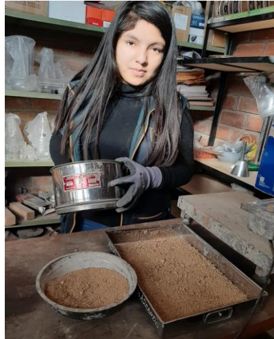
Fig. 33. Peso del material tamizado por la malla N°200 - Abertura de 75 \mu m.
