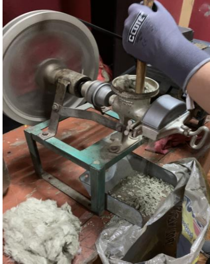
Fig. 24. Proceso de molienda del granel de Lana de Roca.
