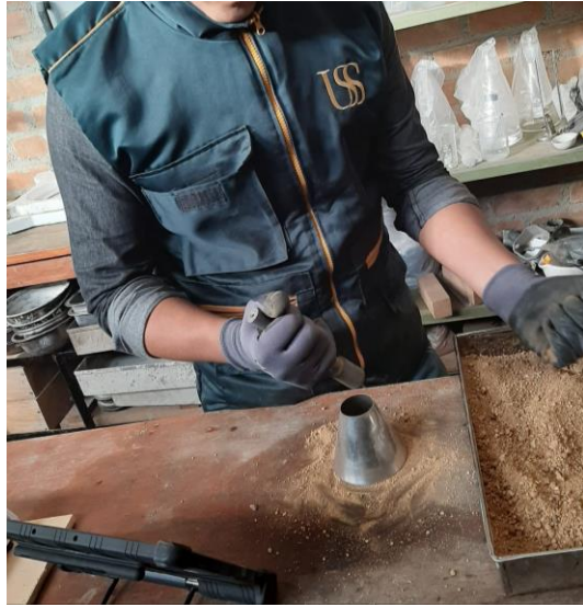
Fig. 32. Ensayo de peso específico del agregado fino.
