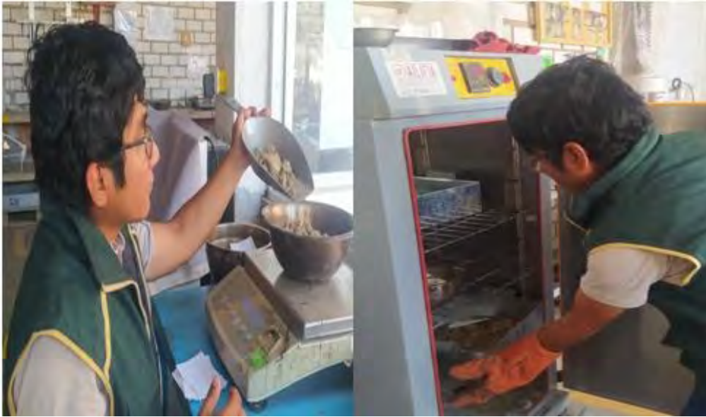
Fig. 3 Muestra de ensayo de contenido de humedad
