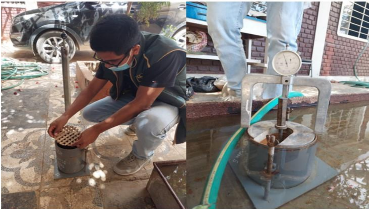
Fig. 30. Ensayo de CBR con inclusión de geomalla de bambú.
