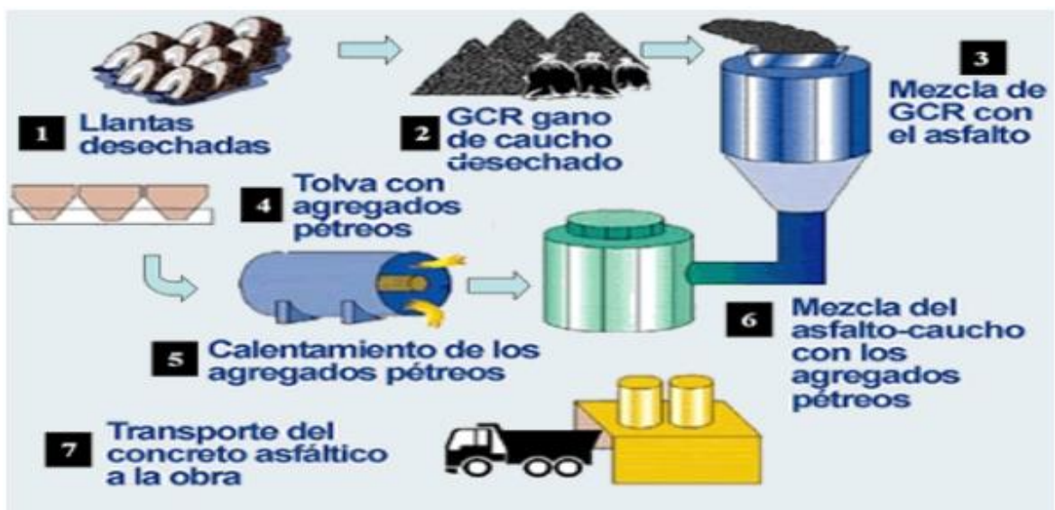
Figura 3. Descripción del proceso por vía húmeda
