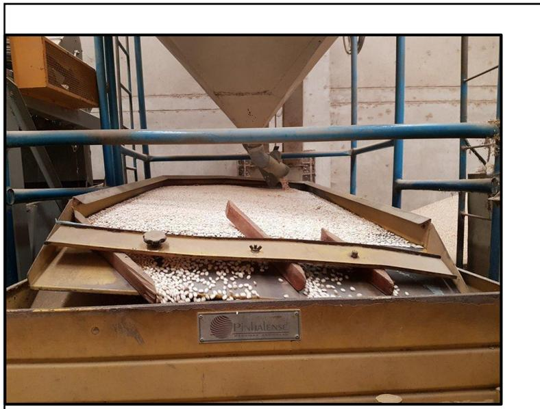
**Figura 6:** Máquina de clasificado
