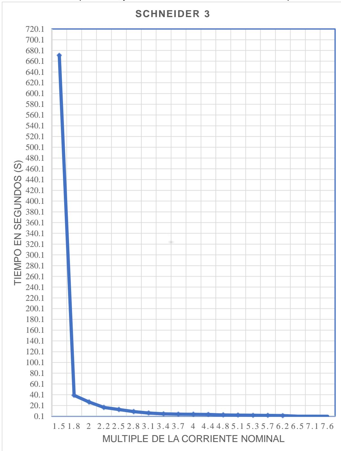
**Figura 36: Diagrama de flujo Tiempo-Múltiplo de la corriente nominal SCHNEIDER 3**
