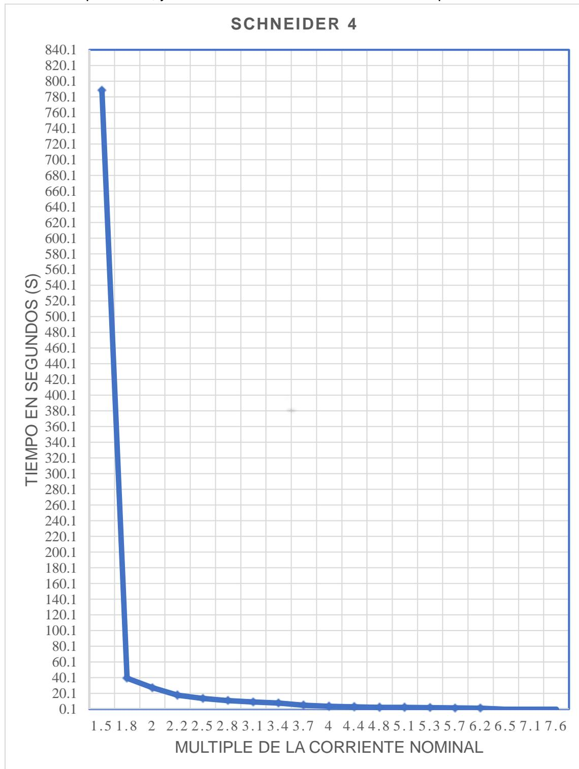
**Figura 37: Diagrama de flujo Tiempo-Múltiplo de la corriente nominal SCHNEIDER 4**
