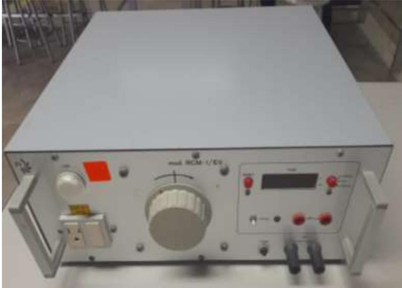
**Anexo 1: Equipo mod. RCM -1/EV para la calibración de amperio**
