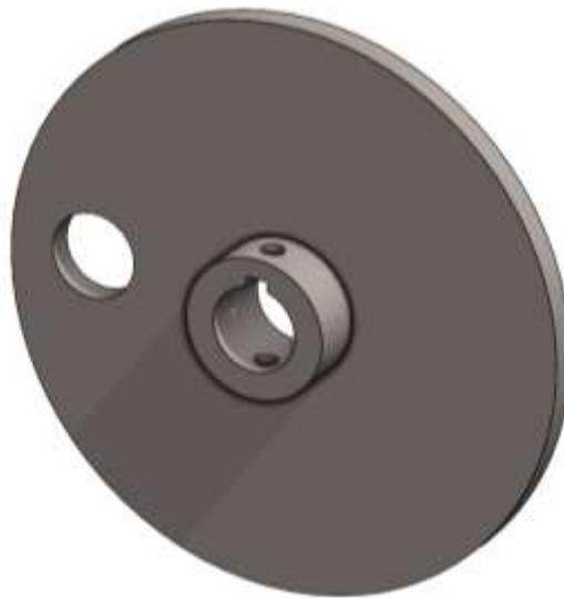
**Figura 40.** Plato manivela del aerogenerador.
