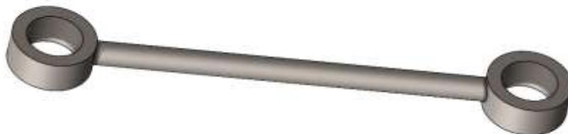
**Figura 41.** Biela del aerogenerador.
