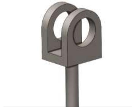
**Figura 42.** Vástago del aerogenerador.
