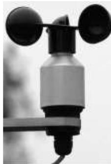
**Figura 11.** Anemómetro de rotación, cazoleta.
