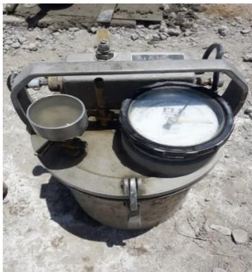
**Fig. 36.** Ensayo para determinar el Contenido de Aire en Mezclas Frescas.
