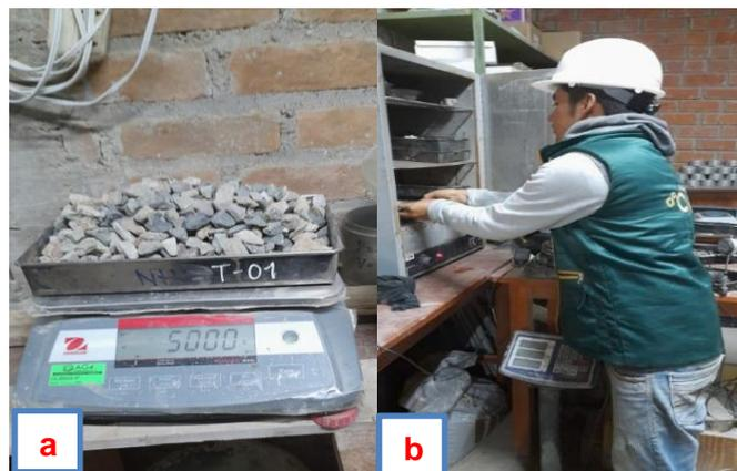
**Fig. 30.** Ensayo Contenido de Humedad del Agregado Grueso: a) Peso del material y b) Colocación del material al horno.
