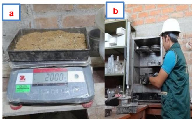
**Fig. 25.** Ensayo del Contenido de Humedad del Agregado Fino: a) Peso del material y b) Colocación del material al horno.
