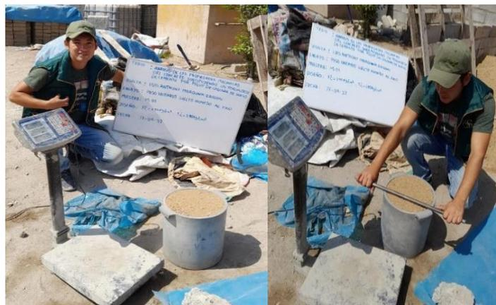
**Fig. 23.** Ensayo del Peso Unitario Suelto Húmedo del Agregado Fino
