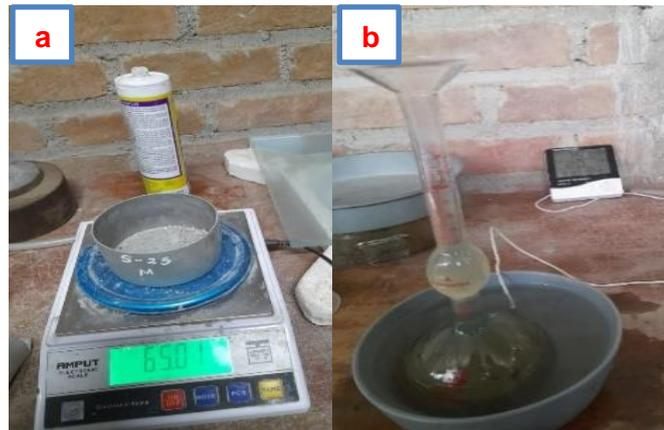
**Fig. 33.** Ensayo Peso Específico del Cemento: a) Peso del cemento y b) sumersión de la botella en agua a temperatura constante.
