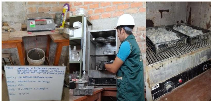
**Fig. 32.** Ensayo Peso Específico y Absorción del Agregado Grueso
