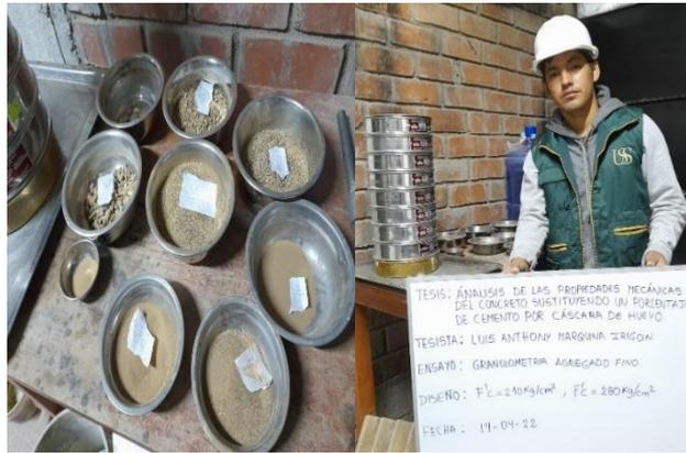
**Fig. 26.** Granulometría - Agregado Fino.
