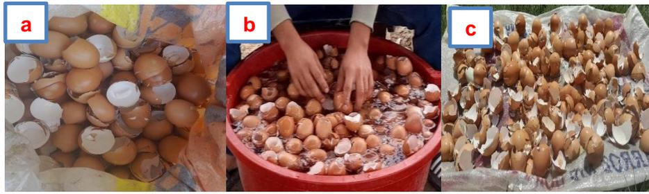
**Fig. 20.** Cáscara de huevos: a) Recolección, b) Lavado y c) Secado
