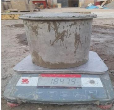
**Fig. 35.** Ensayo para Determinar la Densidad: Registro del Peso Unitario.
