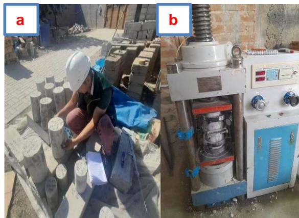
**Fig. 39.** Determinación de la Resistencia a la Compresión del Concreto: a) Medida del diámetro y b) Ensayo de la muestra.
