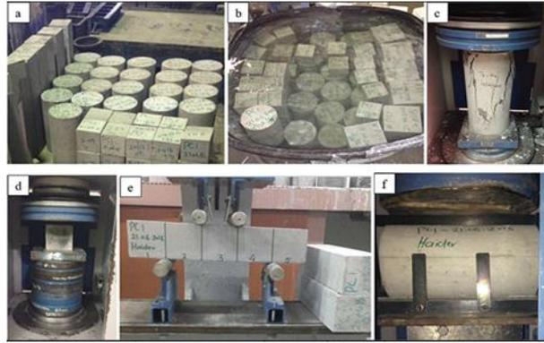
**Fig. 7.** Ensayos mecánicos al concreto endurecido: a) Concreto después del desencofrado, (b) curado de las muestras, (c y d) prueba de resistencia a la compresión, (e) prueba de resistencia a la flexión y (f) prueba de resistencia a la tracción. [66].
