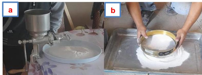
**Fig. 21.** Cáscaras de huevos: a) Pulverización y b) tamizado
