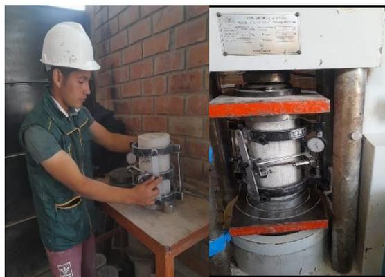
**Fig. 42.** Ensayo Módulos de Elasticidad del Concreto: a) Colocación del compresómetro y b) Ensayo de la muestra.
