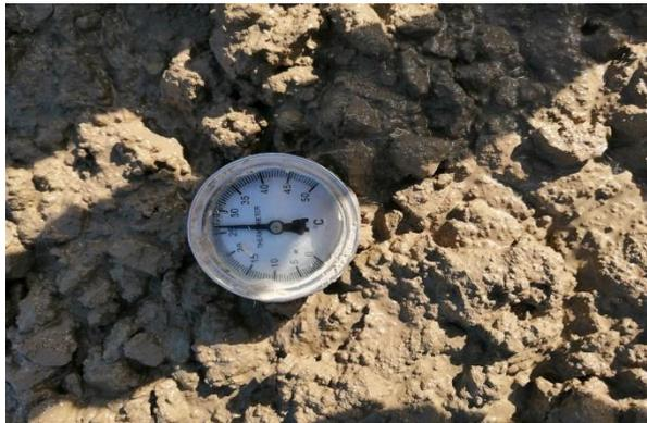
**Fig. 38.** Determinación de la Temperatura del Concreto.
