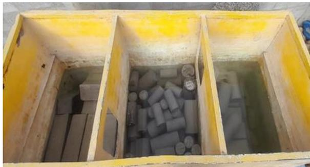
**Fig. 6.** Curado del concreto
