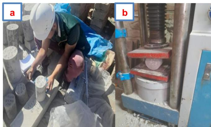
**Fig. 41.** Ensayo de la Resistencia a la Tracción del Concreto: a) Medida del diámetro y b) Ensayo de la muestra.
