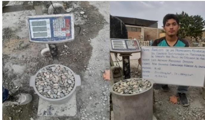
**Fig. 29.** Ensayo Peso Unitario Compactado Húmedo Agregado Grueso
