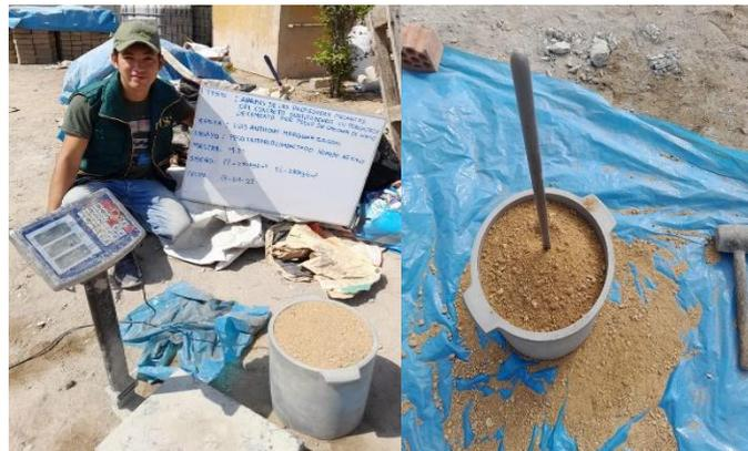
**Fig. 24.** Ensayo del Peso Unitario Compactado Húmedo del Agregado Fino
