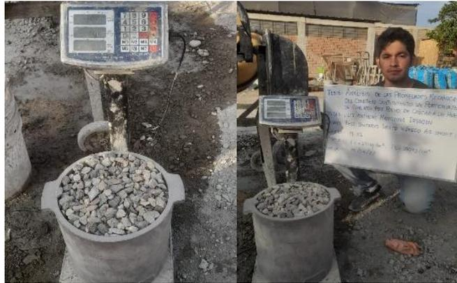
**Fig. 28.** Ensayo Peso Unitario Suelto Húmedo Agregado Grueso
