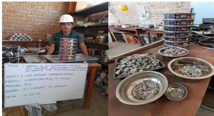
**Fig. 31.** Granulometría - Agregado Grueso
