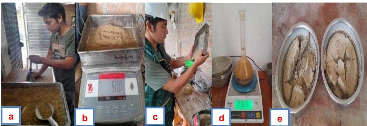
**Fig. 27.** Ensayo Peso Específico y Absorción del Agregado Fino: a) Prueba del cono, b) Peso del material, c) Uso de la fiola, d) Peso del material con el agua y d) Material retirado del horno (seco).
