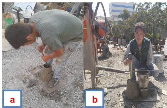
**Fig. 37.** Determinación del Asentamiento del concreto: a) Varillado del concreto y b) Medida del asentamiento del concreto.
