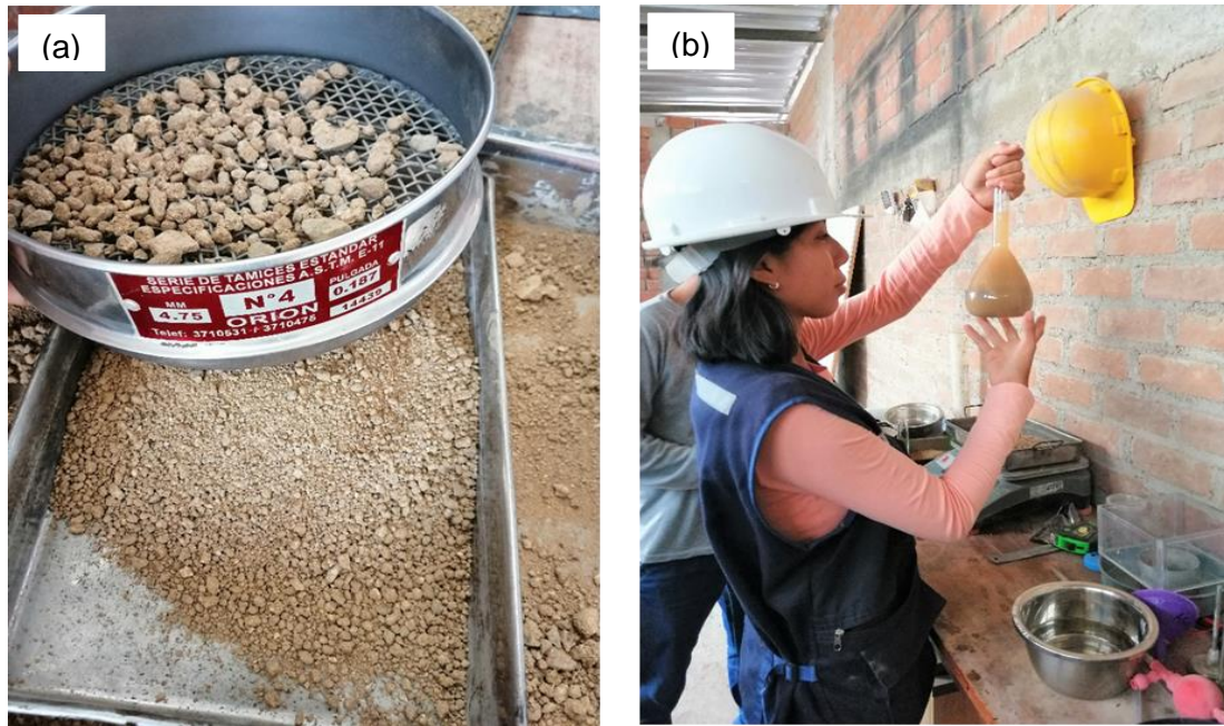
Fig. 17. Ensayo Peso específico y porcentaje de absorción del agregado fino. (a) Muestra para ensayo, (b) Tesisista realizando ensayo.
