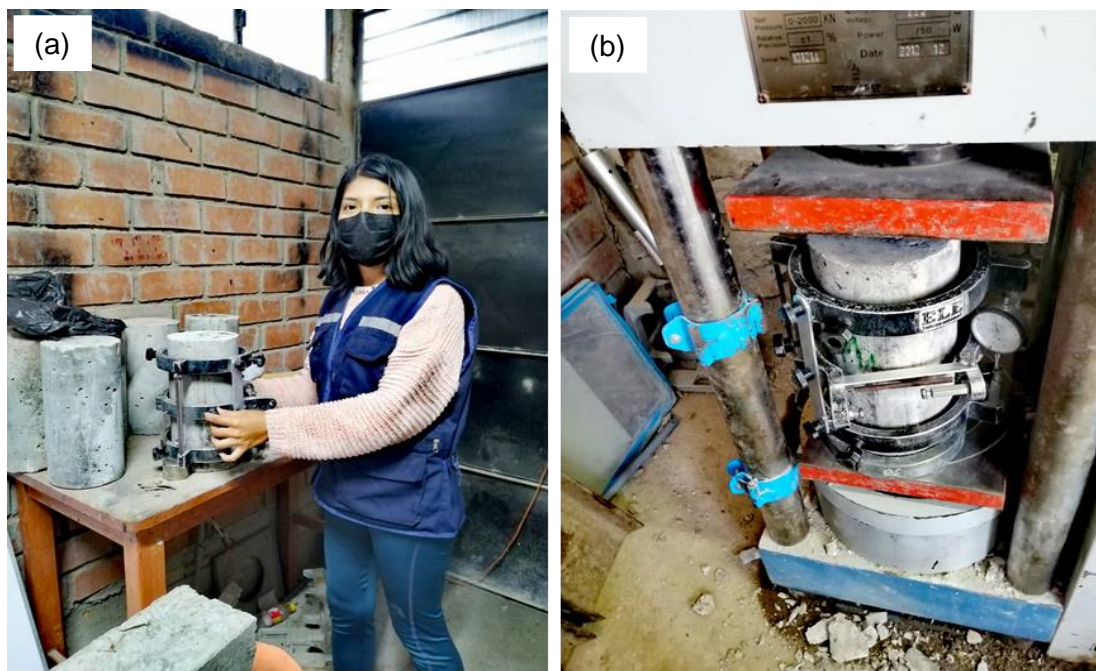
Fig. 25. Ensayo de módulo de elasticidad. (a) Tesista colocando el equipo, (b) Probeta ensayada.
