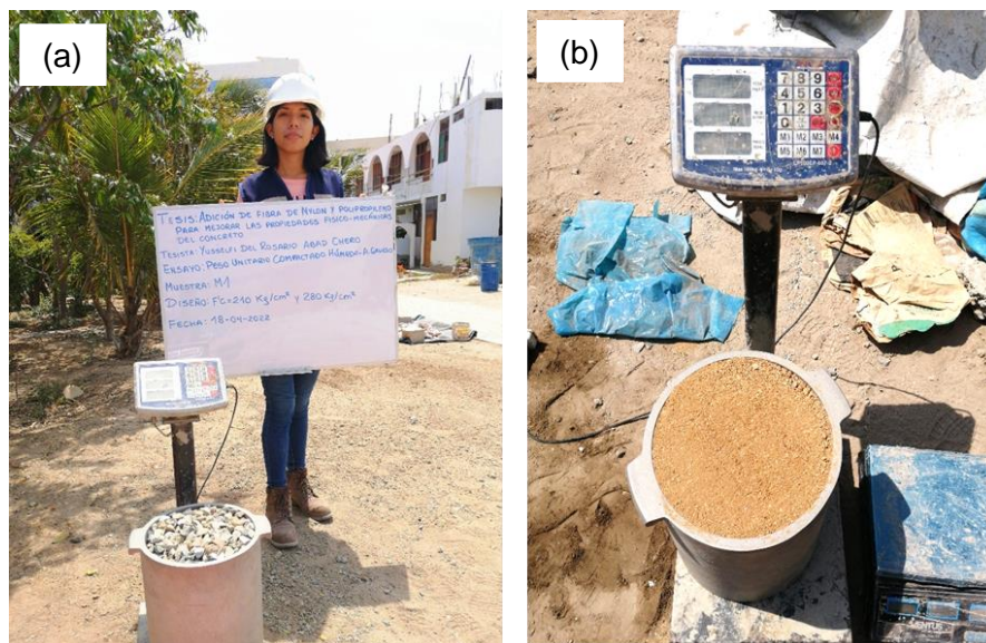
Fig. 15. Ensayo Peso Unitario de los agregados. (a) Agregado grueso, (b) Agregado fino.
