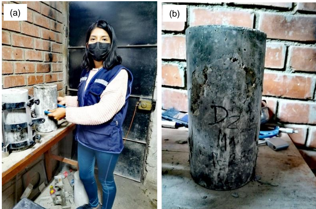
Fig. 22. Ensayo de la resistencia a la compresión. (a) Tesista realizando la medición del diámetro con el micrómetro, (b) Probeta ensayada.
