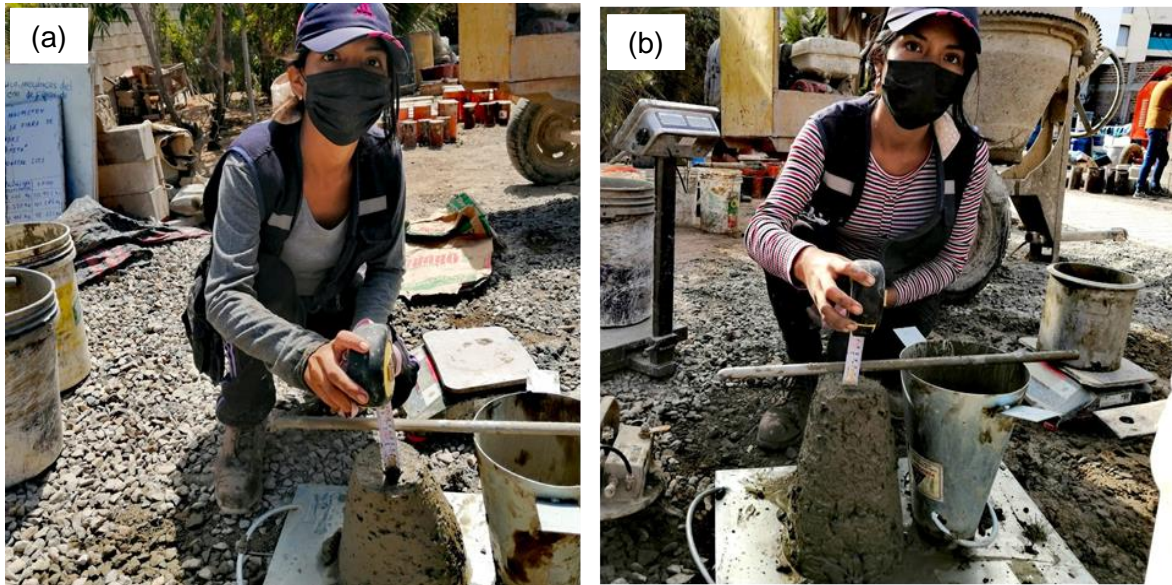
Fig. 18. Ensayo del asentamiento de la mezcla. (a) Medición de Slump en f'c= 210 \text{ kg/cm}^2 , (b) Medición de Slump en f'c= 280 \text{ kg/cm}^2 .
