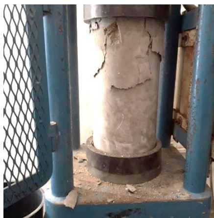
Fig. 3. Ensayo resistencia a la compresión.
