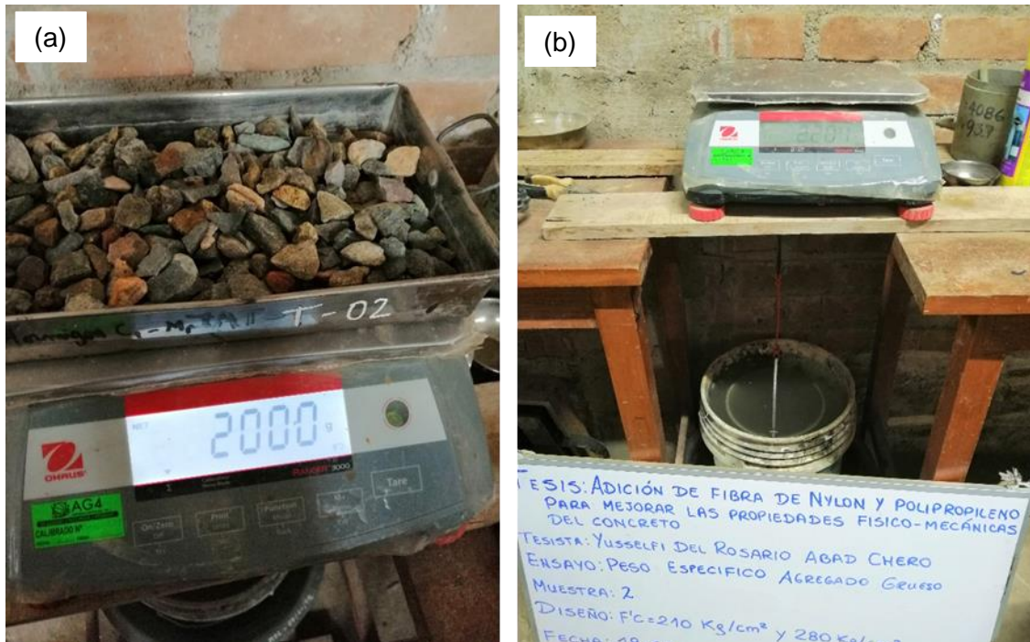
Fig. 16. Ensayo Peso específico y porcentaje de absorción del agregado grueso (a) Muestra a ensayar, (b) Ensayo realizado.
