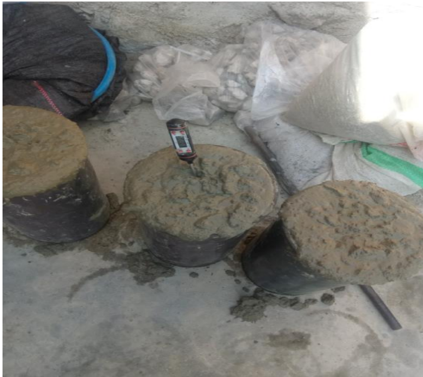
Foto 22 Lectura de la temperatura del concreto en estado fresco
