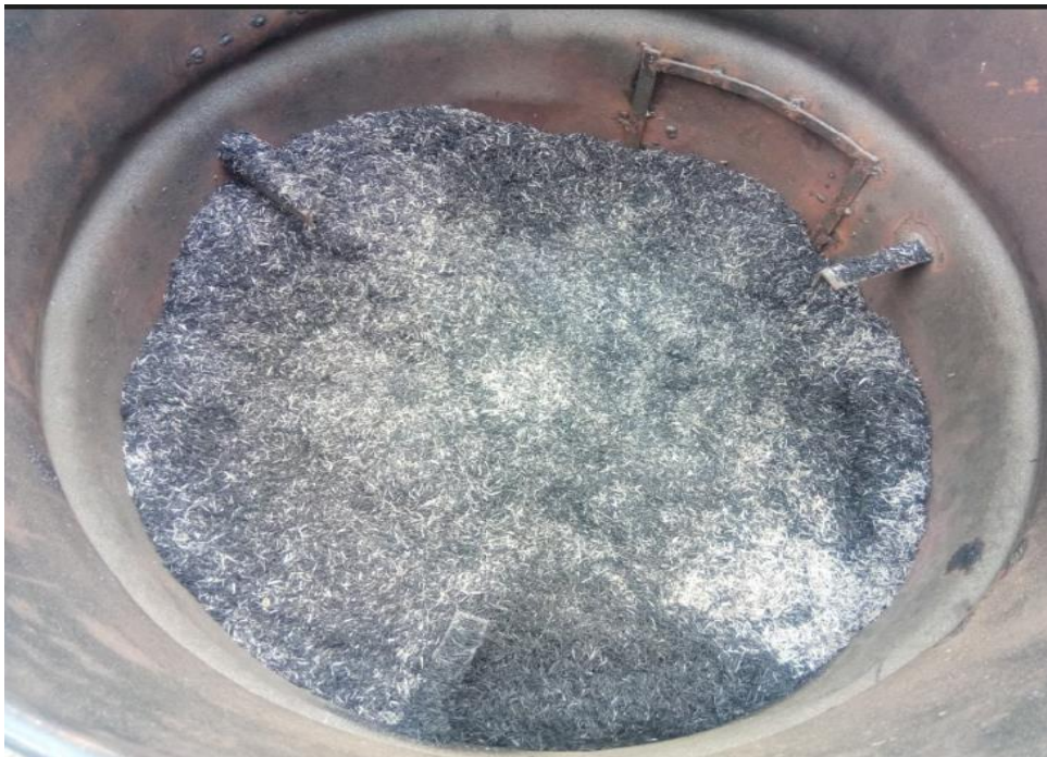
Foto 14 Ceniza resultante de la incineración de la cáscara de arroz
