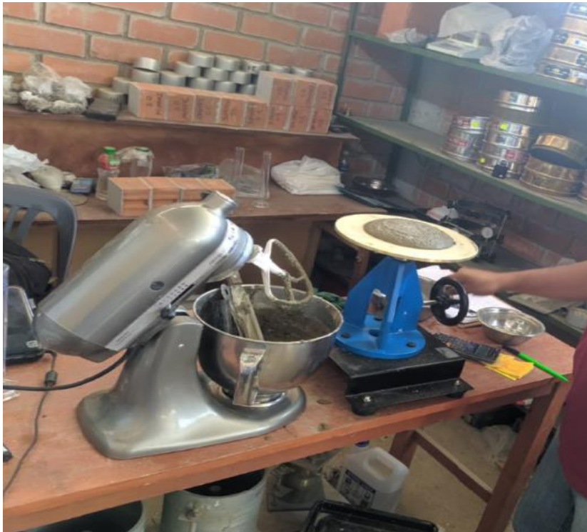
Foto 17 Ensayo de flujo para índice puzolánico
