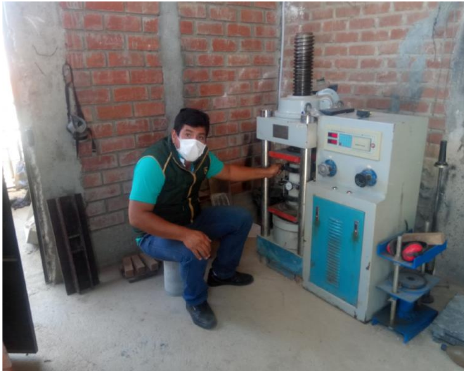
Foto 29 ensayo a compresión de muestras cilíndricas
