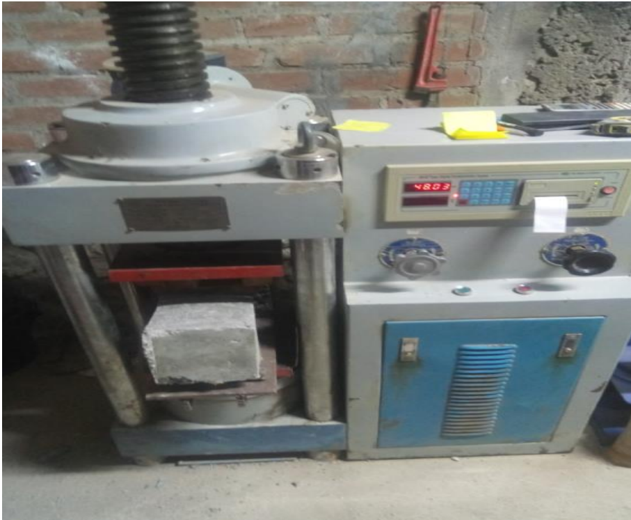
Foto 31 Ensayo a flexión de las muestras prismáticas
