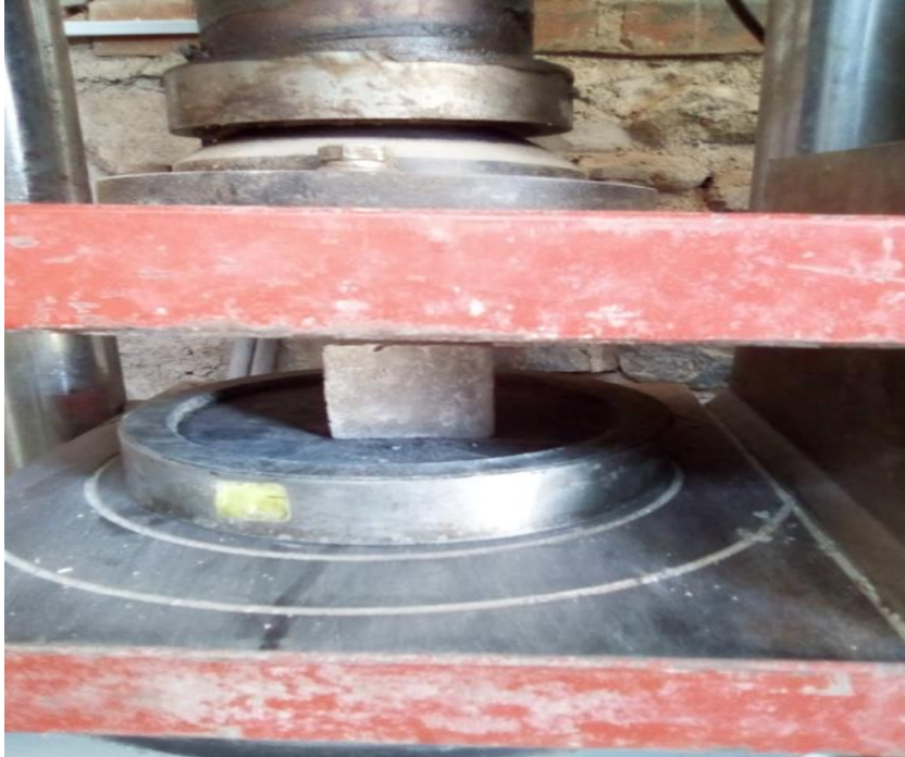
Foto 20 Ensayo de compresión de los cubitos de concreto.
