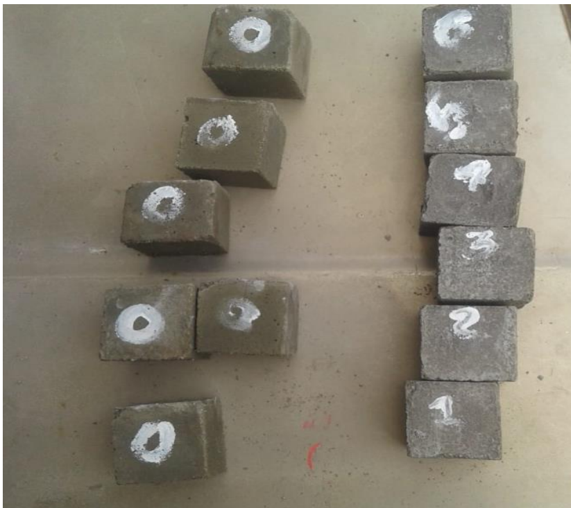
Foto 18 Cubos de concreto con y sin adición de ceniza
