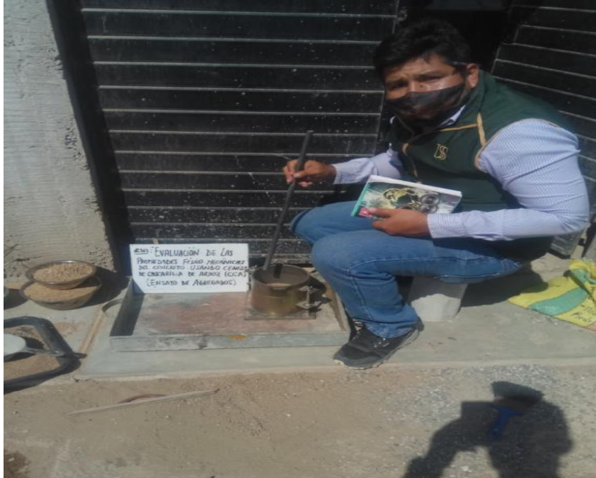
Foto 11 Ensayo de compactación del agregado grueso
