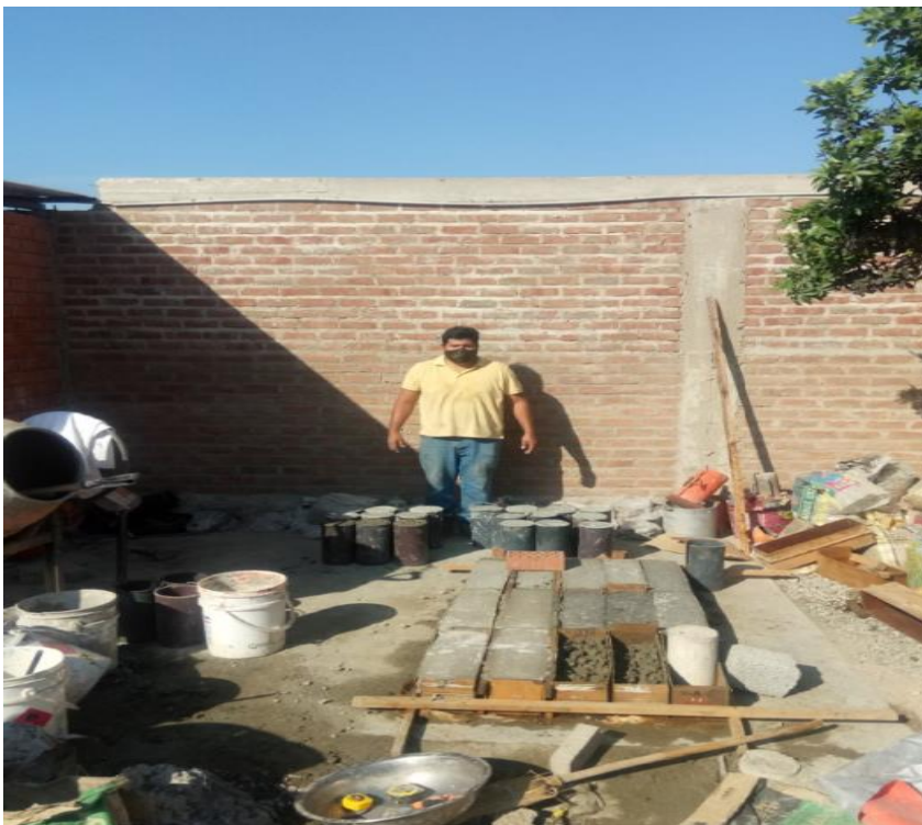
Foto 26 Vaciado de probetas Cilíndricas y prismáticas
