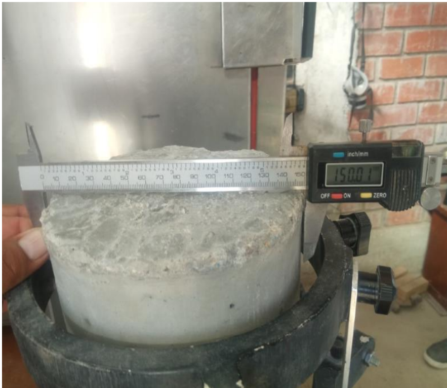
Foto 28 Medida del diámetro del espécimen cilíndrico endurecido
