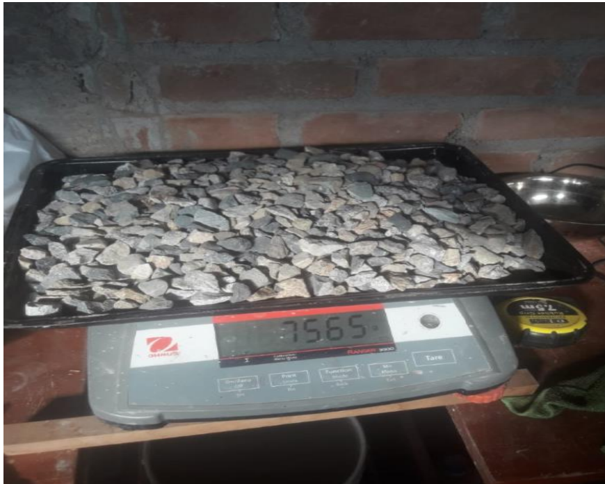
Foto 3 Pesaje del agregado Grueso
