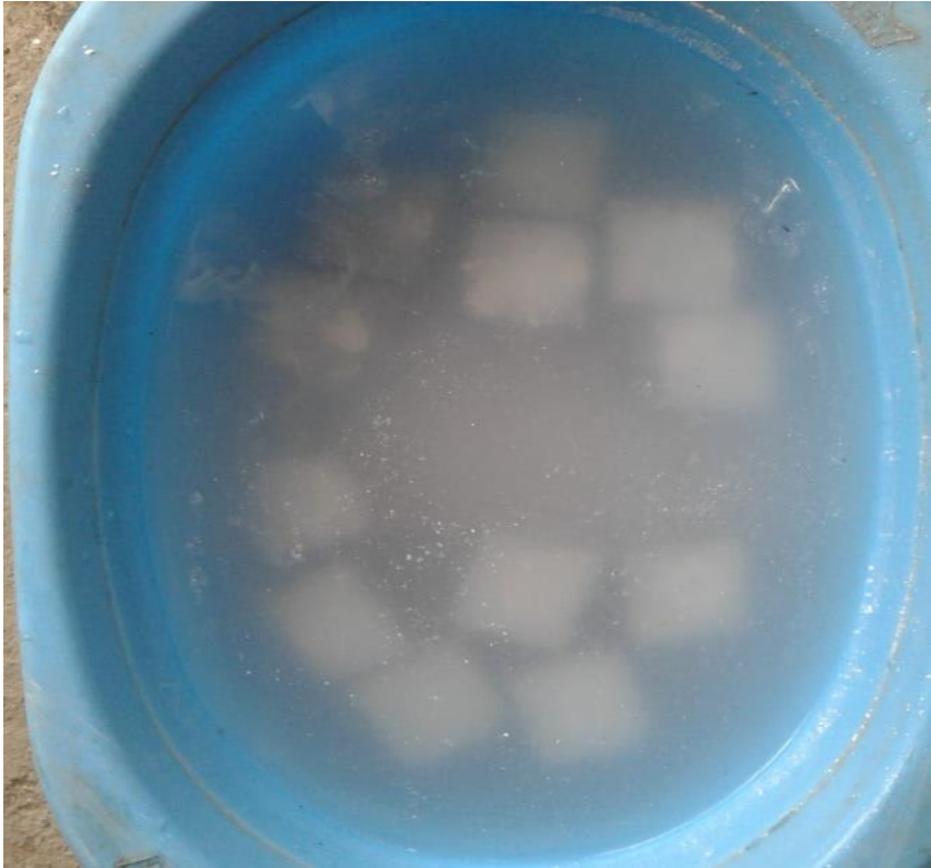
Foto 19 Curado de cubos de concreto en agua con cal
