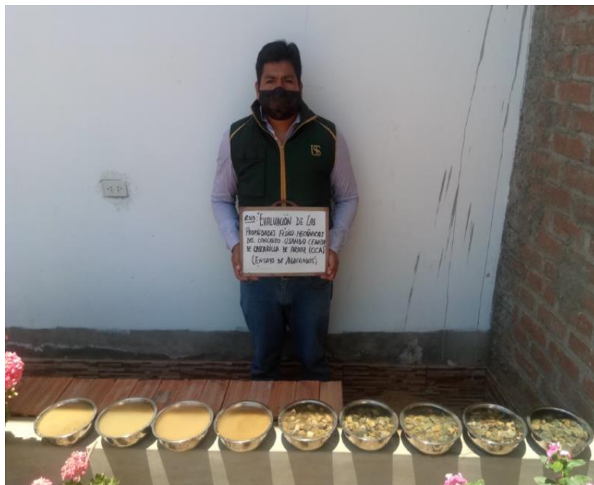
Foto 6 Ensayo de contenido de humedad para los áridos
