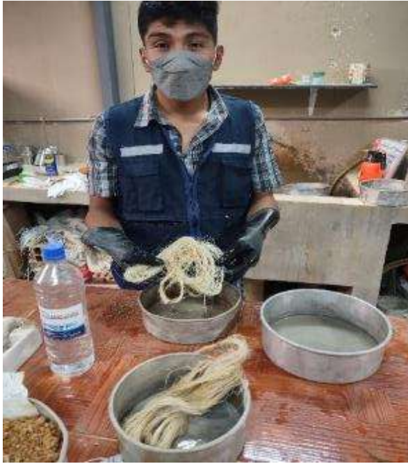
Fig. 26. Lavado con agua destilada.
