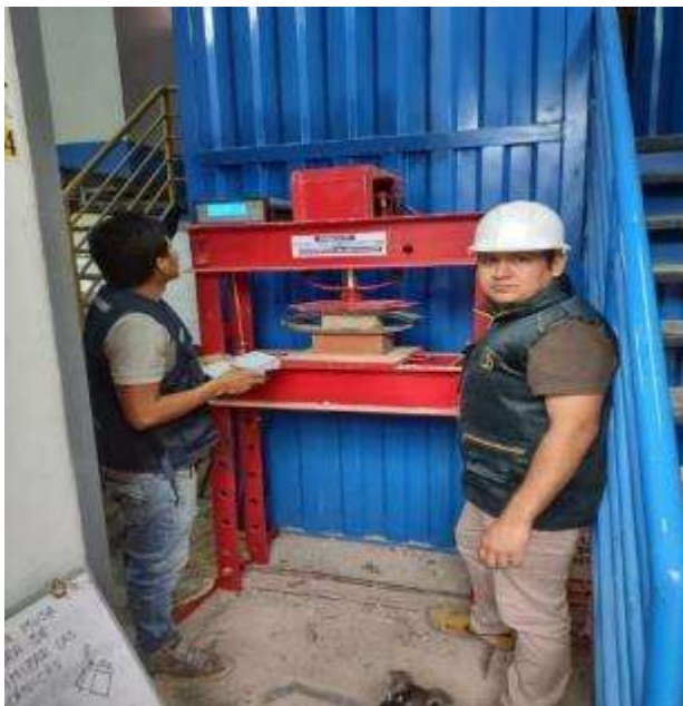
Fig. 39. Comportamiento de la unidad sometida a ensayo de resistencia a la compresión, ensayo a los 28 días.
