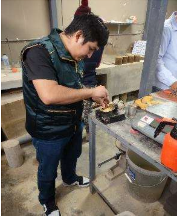
Fig. 18. Proceso de acanalado.
