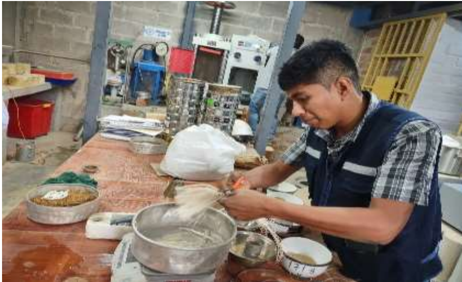
Fig. 28. Pesado respectivo de la fibra de musa paradisíaca 5.9 gr. y fibra de agave 5.9 gr.
