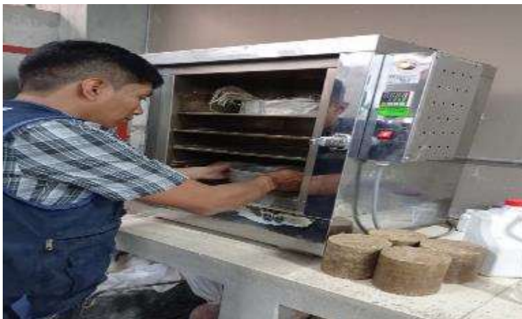
Fig. 16. Ingresando la muestra al horno, por un tiempo de 24 horas; para posteriormente realizar el pesado.
