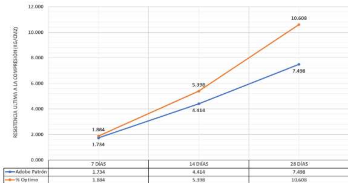
Fig. 59. Evolución de Resistencia a Compresión en pilas con adobe patrón y con adiciones de MP y AG, a los 7, 14 y 28 días de curado.
