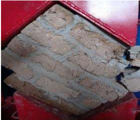
Fig. 46. Comportamiento del murete sometido a ensayo de resistencia a la compresión diagonal, ensayo a los 14 días.
