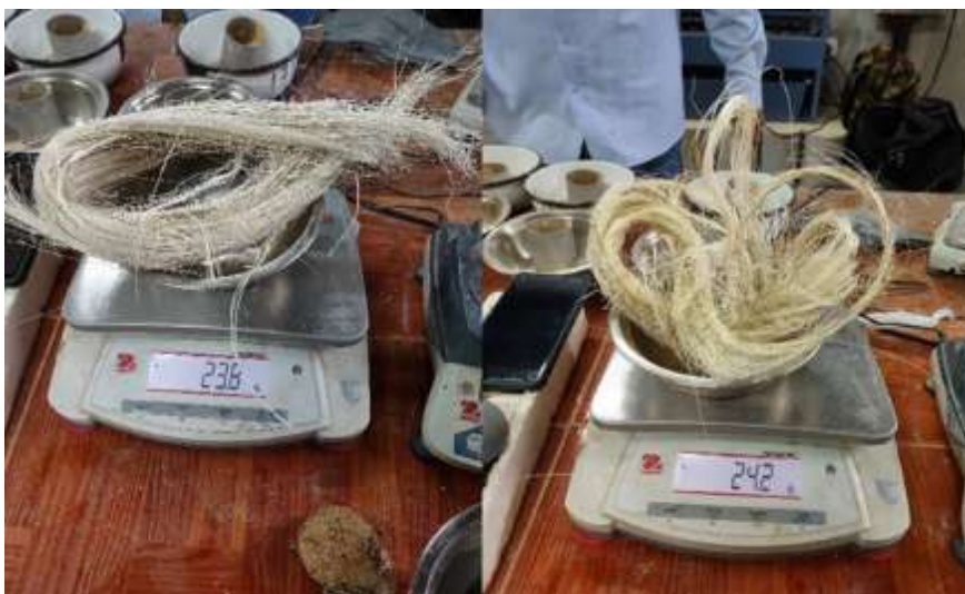
Fig. 23. Muestra de la fibra a emplear para realizar el mercerizado (fibra de musa paradisiaca 23.8 gr. Fibra de agave 24.2 gr).
