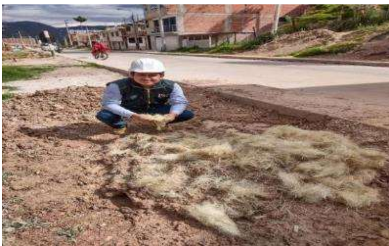
Fig. 31. Distribución de la fibra de musa paradisiaca y fibra de agave en el suelo.
