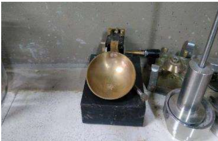
Fig. 17. Copa de Casagrande para determinar el LL del suelo.
