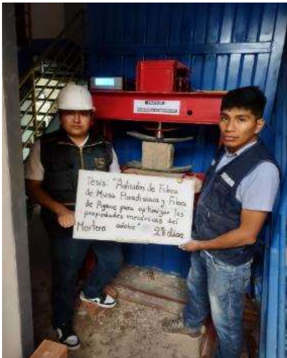
Fig. 35. Ensayo de resistencia a la tracción del mortero.
