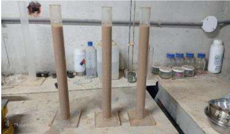
Fig. 20. Proceso de ensayo para determinar la cantidad de arena.
