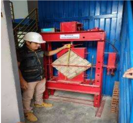
Fig. 44. Colocación del murete de adobe a la prensa y toma de lectura de la carga aplicada.
