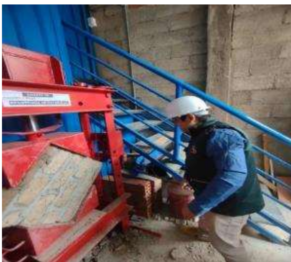
Fig. 47. Comportamiento del murete sometido a ensayo de resistencia a la compresión diagonal, ensayo a los 28 días.
