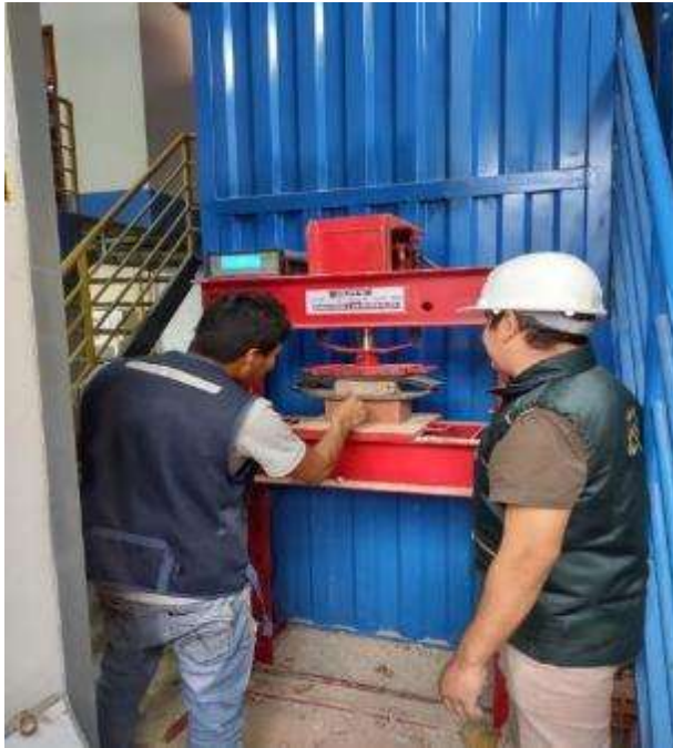
Fig. 36. Colocación de la unidad de adobe a la prensa y toma de lectura de la carga aplicada.
