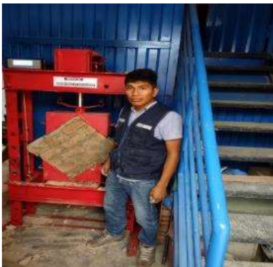
Fig. 45. Comportamiento del murete sometido a ensayo de resistencia a la compresión diagonal, ensayo a los 7 días.
