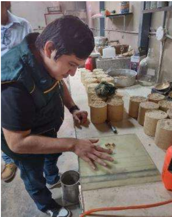
Fig. 19. Proceso de formado de los cilindros en una placa de vidrio liso para determinar el límite plástico del suelo a usar.
