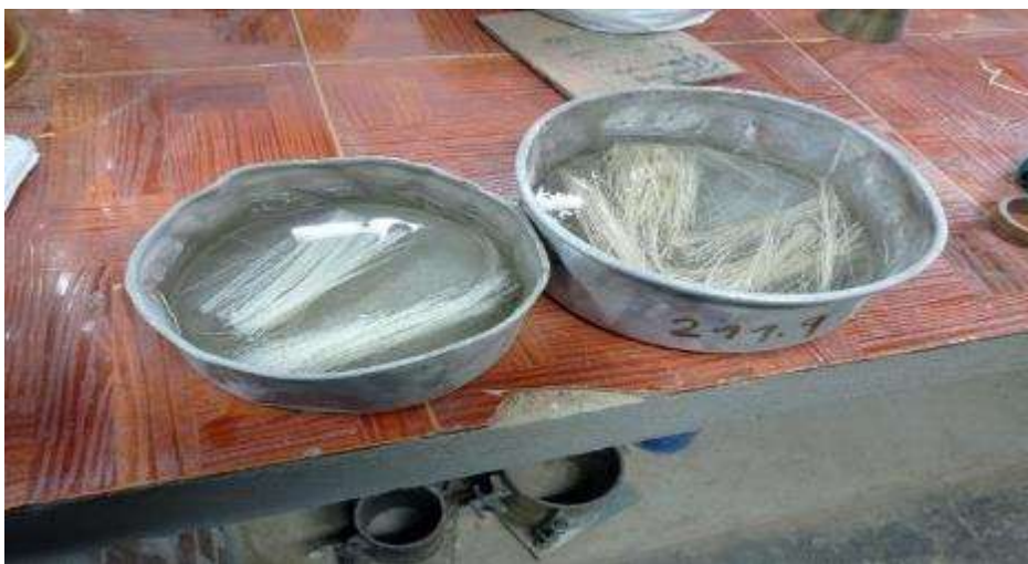
Fig. 29. Proceso de saturación en agua a las fibras de musa paradisíaca y fibra de agave, por un tiempo de 24 horas.
