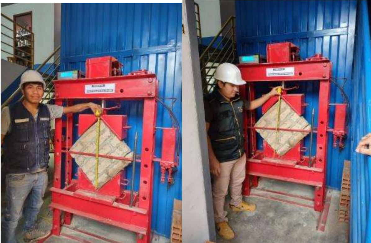
Anexo 3.5.10. Ensayo de resistencia a compresión diagonal en muretes
