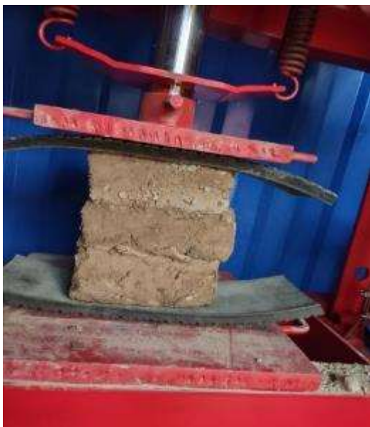
Fig. 41. Comportamiento de la pila sometida a ensayo de resistencia a la compresión, ensayo a los 7 días.
