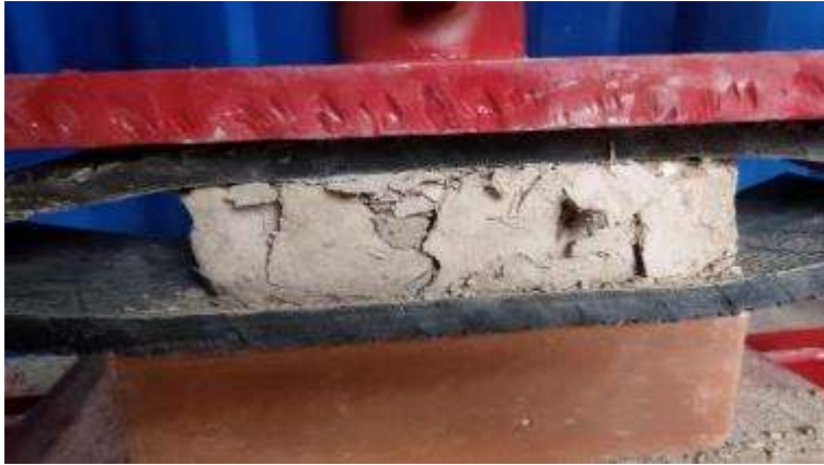
Fig. 38. Comportamiento de la unidad sometida a ensayo de resistencia a la compresión, ensayo a los 14 días.
