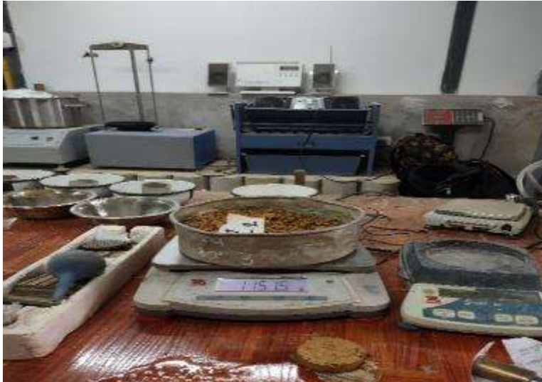
Fig. 15. Pesado del material en su estado natural.
