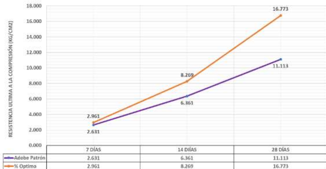
Fig. 54. Evolución de resistencia a compresión en unidades de adobe patrón y con adiciones de MP y AG, a los 7, 14 y 28 días de secado.
