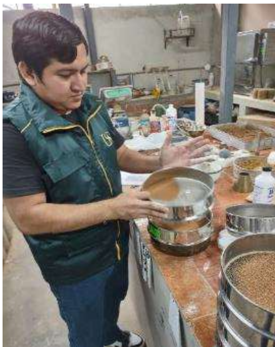
Fig. 14. Tamizado respectivo del suelo seleccionado.
