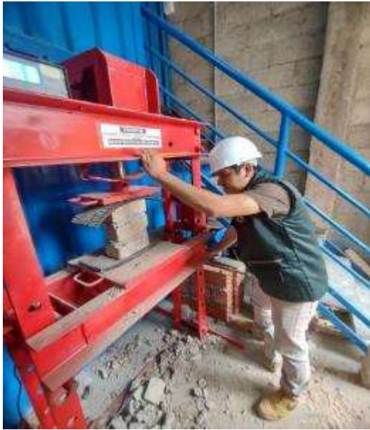
Fig. 40. Colocación de la pila de adobe a la prensa y toma de lectura de la carga aplicada.
