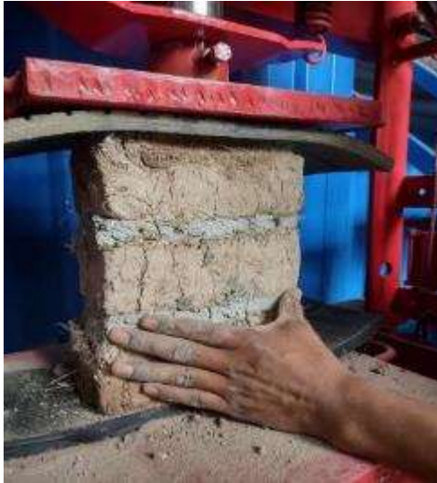
Fig. 42. Comportamiento de la pila sometida a ensayo de resistencia a la compresión, ensayo a los 14 días.
