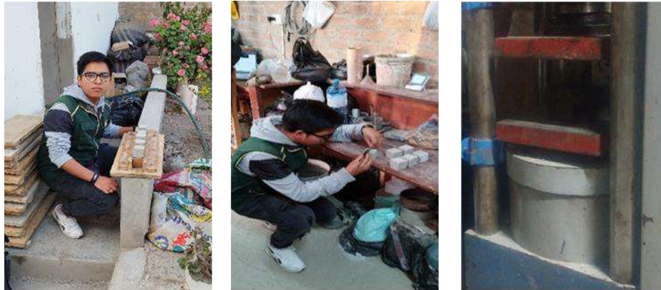
Fig. 11. Análisis de los cubos de concreto con CCH
