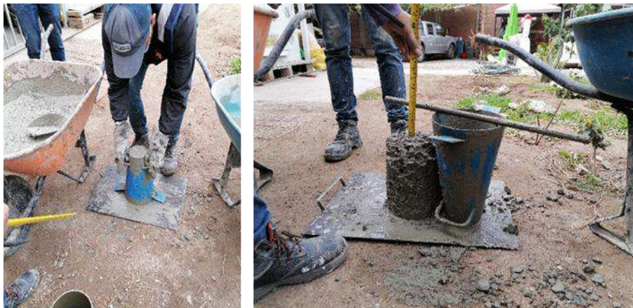
Fig. 14. Ensayo de mezcla de concreto en estado fresco – Slump
