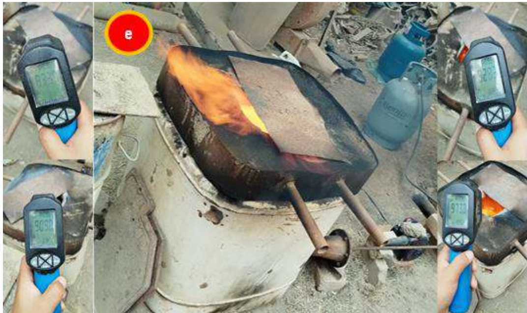
Fig. 8. Calcinación de la CH a 850°C, 900°C, 950°C y 1000°C
