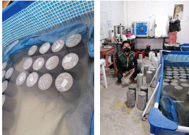
Fig. 16. Curado de los testigos de concreto
