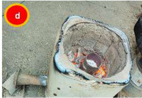
Fig. 7. Preparación del horno para la calcinación de la CH
