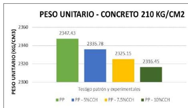
Fig. 20. Peso unitario de muestra patrón y sustituciones, concreto 210 kg/cm 2
