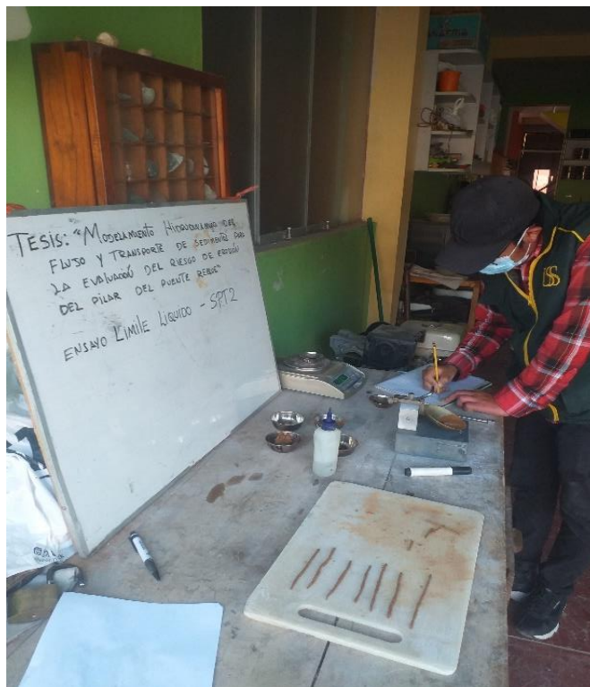
REALIZACION DEL ENSAYO LIMITES DE CONSISTENCIA
