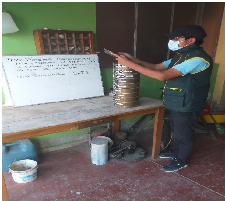
Fig. 23. Realización de ensayos en el Laboratorio. Nota. En la figura 23 se observa el ensayo Granulométrico de la Calicata N°01, cuyos resultados se encuentran en la Figura N°24
