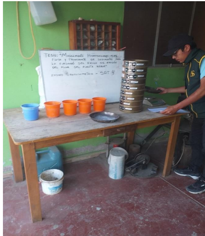
REALIZACION DEL ENSAYO GRANULOMETRICO
