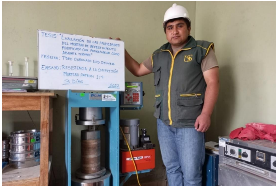
Fig. 15. Resistencia a la compresión
