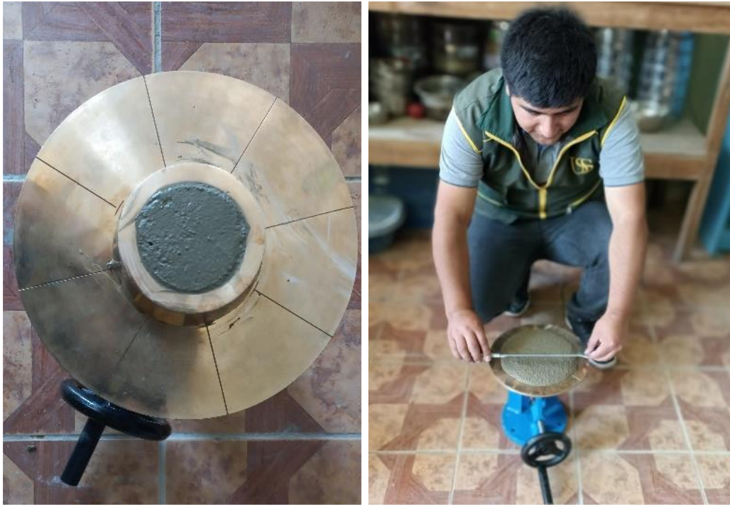
Ensayo de fluidez del mortero.
