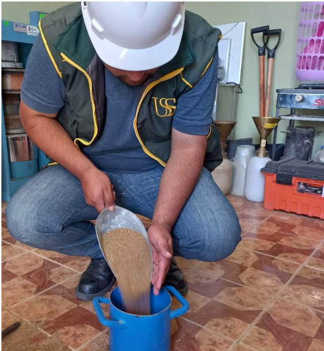
Peso unitario del agregado fino.
