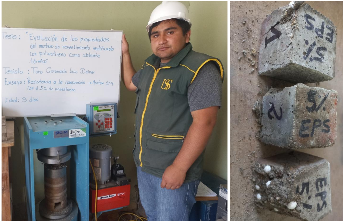
Resistencia a la compresión del mortero en cubos de 50 mm de lado.
