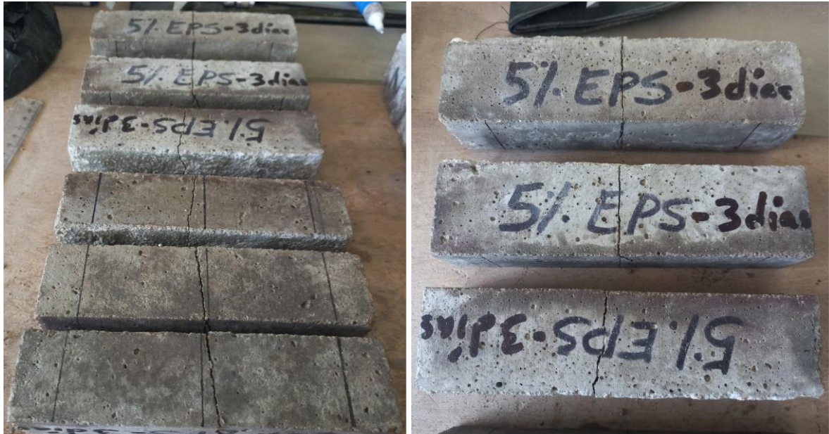
Fig. 18. Prismas ensayados a los 3 días
