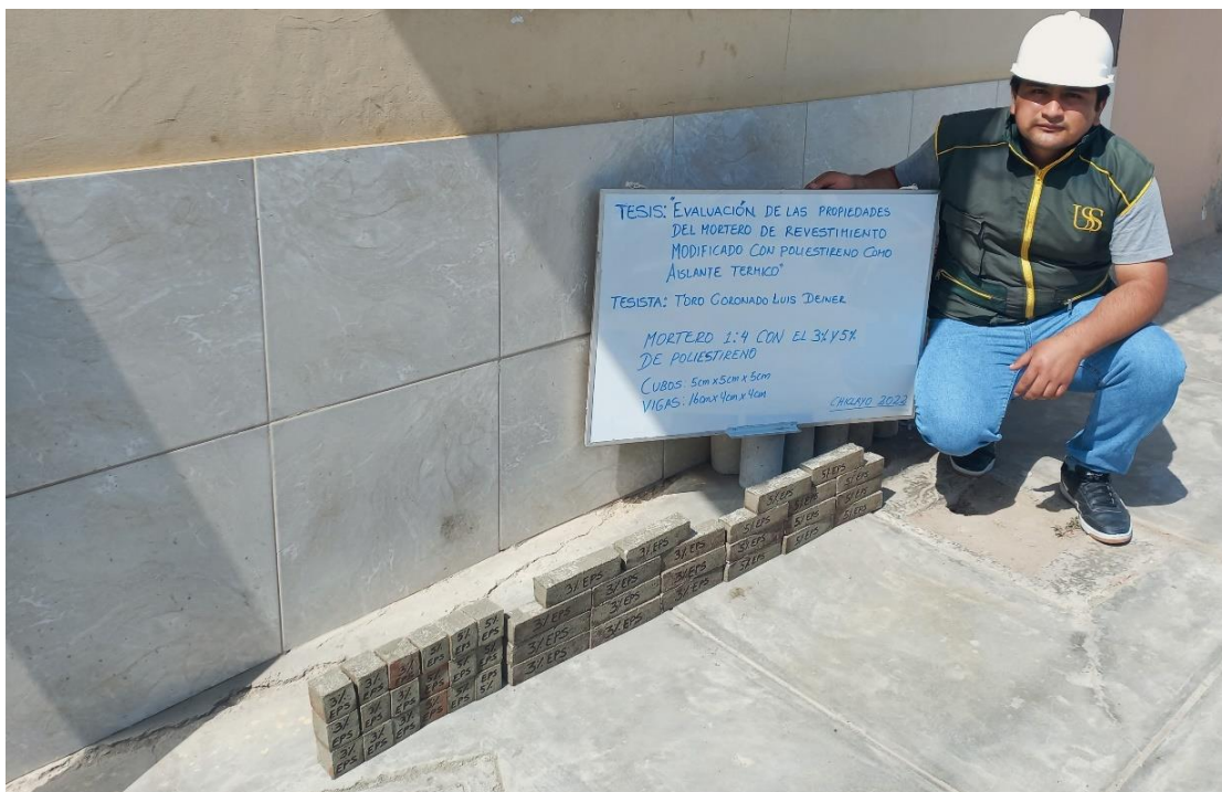
Especímenes para ensayos de resistencia a la compresión y flexión.
