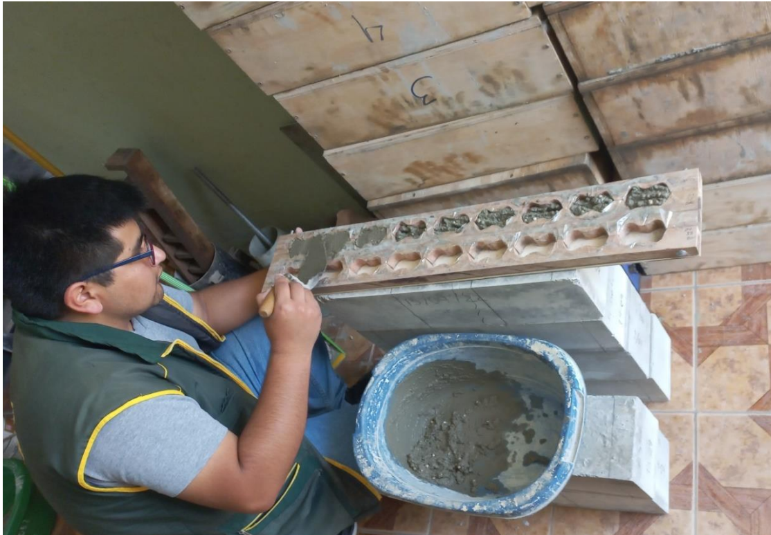
Especímenes de mortero con el 7% y 9% de Poliestireno.
