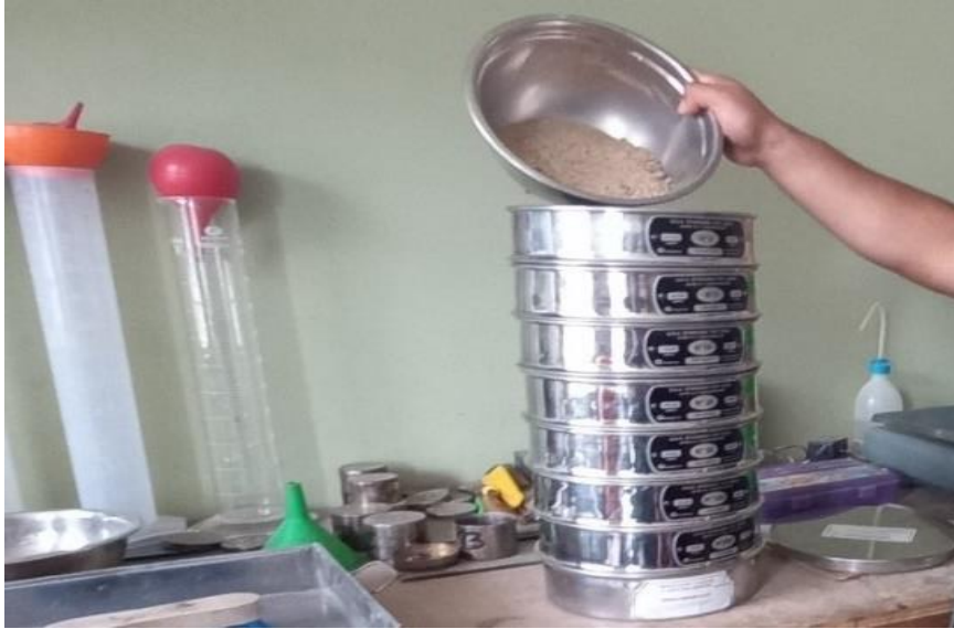
Fig. 8. Granulometría del agregado fino
