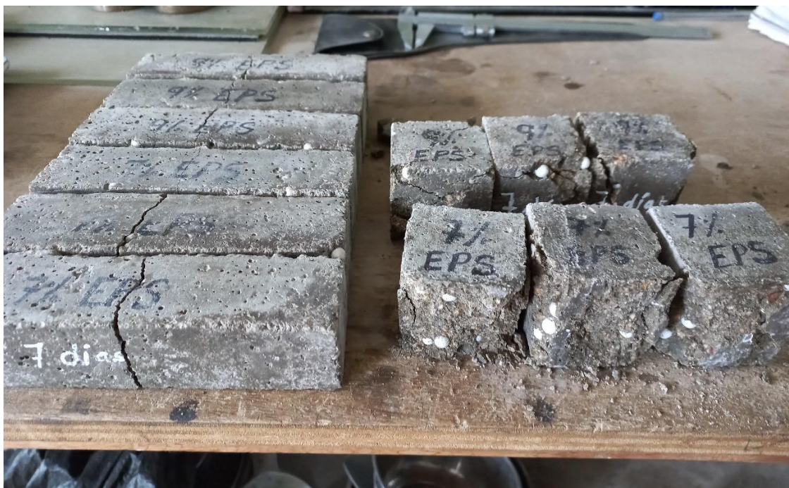
Resistencia a la compresión y flexión de especímenes a la edad de 7 días.
