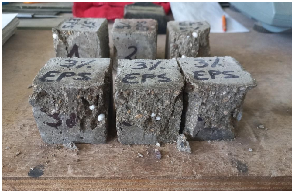
Fig. 16. Cubos ensayados a los 3 días
