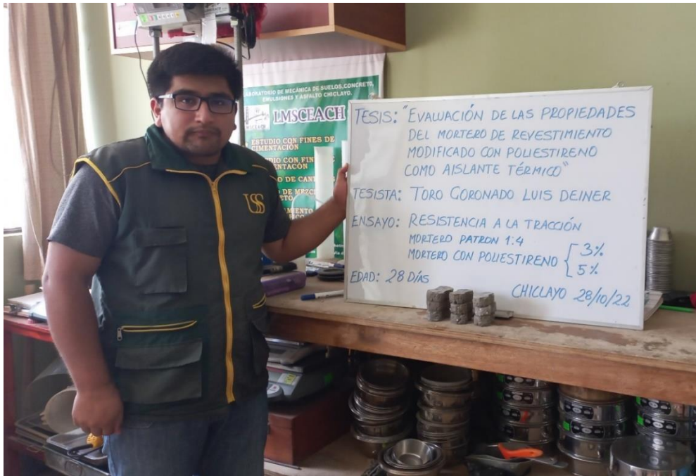
Resistencia a la tracción del mortero con 3% y 5% de poliestireno a los 28 días.
