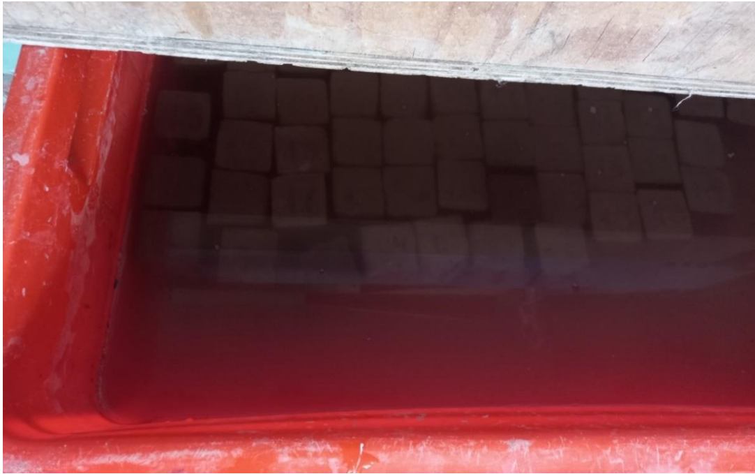
Curado de las muestras de mortero.
