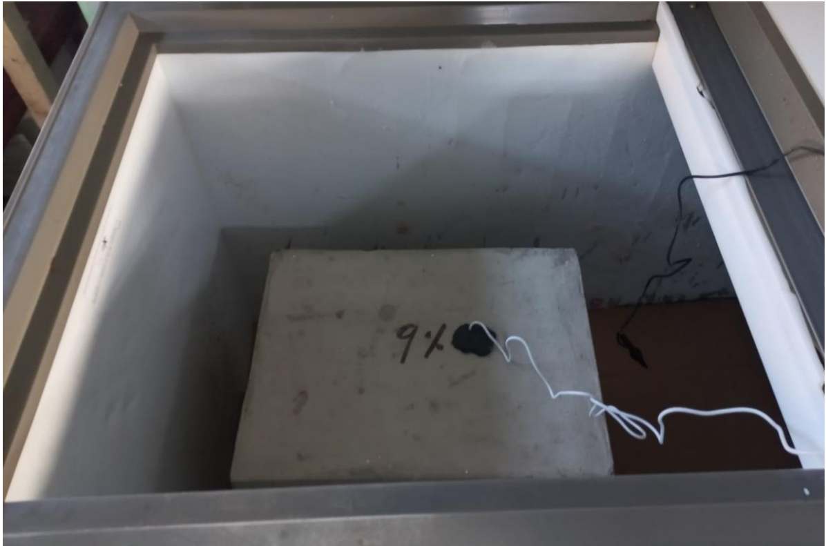
Ensayo de maqueta de mortero 1:4 con 9% de poliestireno.
