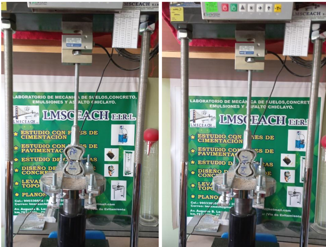
Resistencia a la tracción del mortero patrón 1:4 y mortero 1:4 con 3% y 5% de poliestireno a los 28 días.
