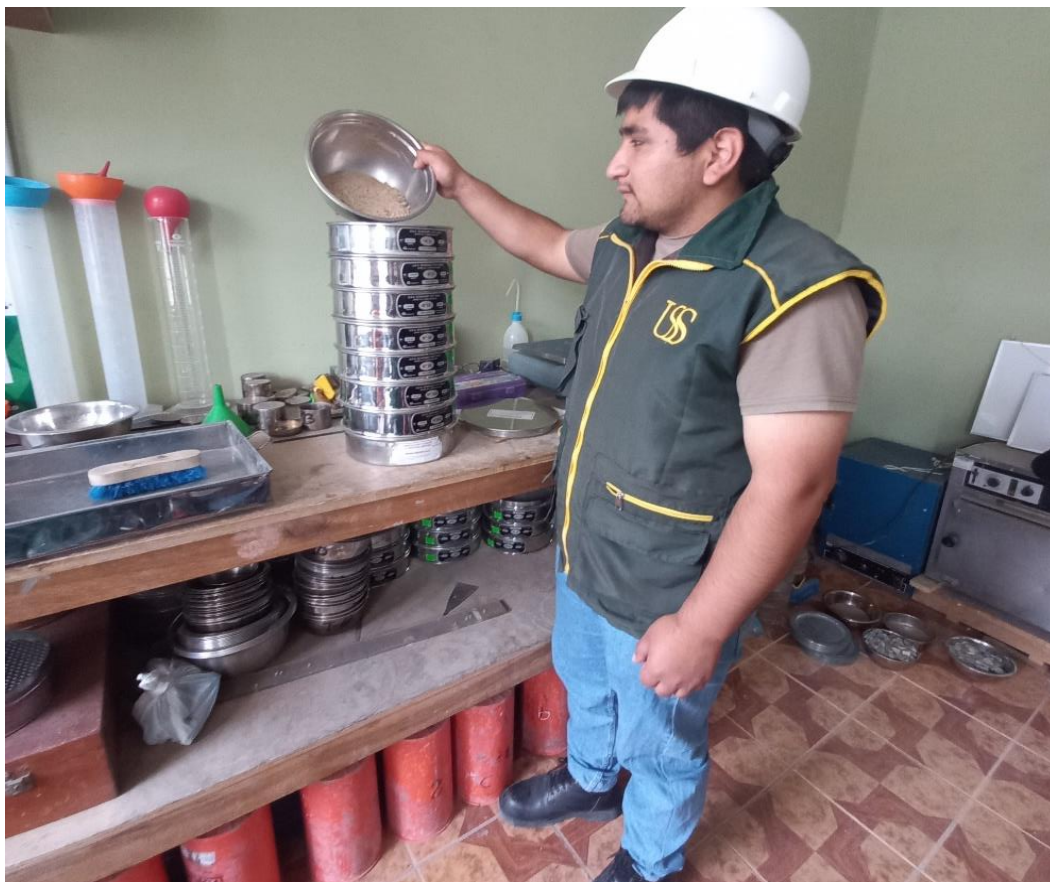
Análisis granulométrico del agregado fino.
