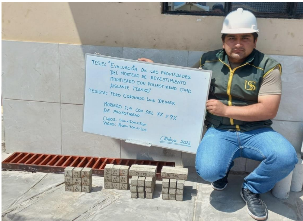
Especímenes para ensayos de resistencia a la compresión y flexión.
