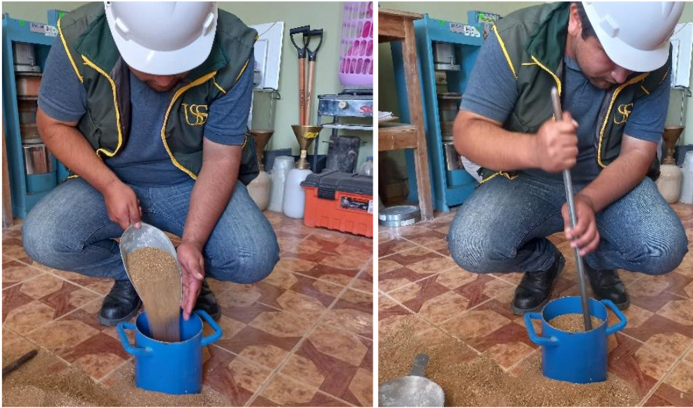
Fig. 9. Peso unitario del agregado fino
