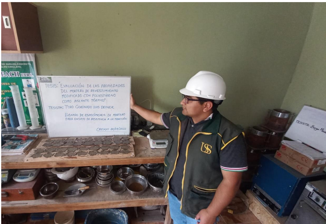
Muestras de mortero patrón y mortero con 3% y 5% de Poliestireno.
