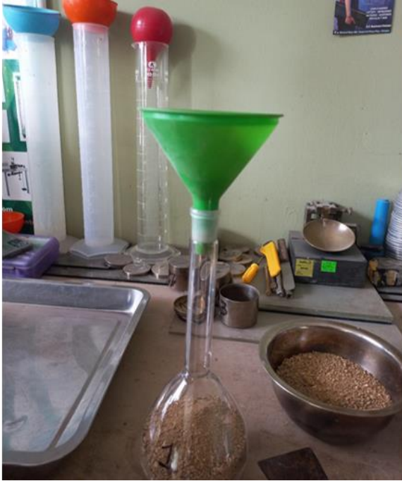
Peso específico del agregado fino.
