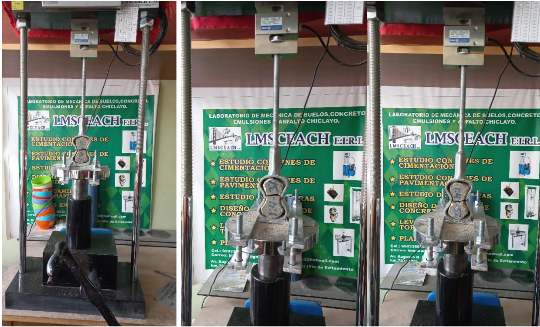
Especímenes ensayados a los 3 días – Mortero patrón 1:4 y mortero 1:4 con 3% y 5% de poliestireno.
