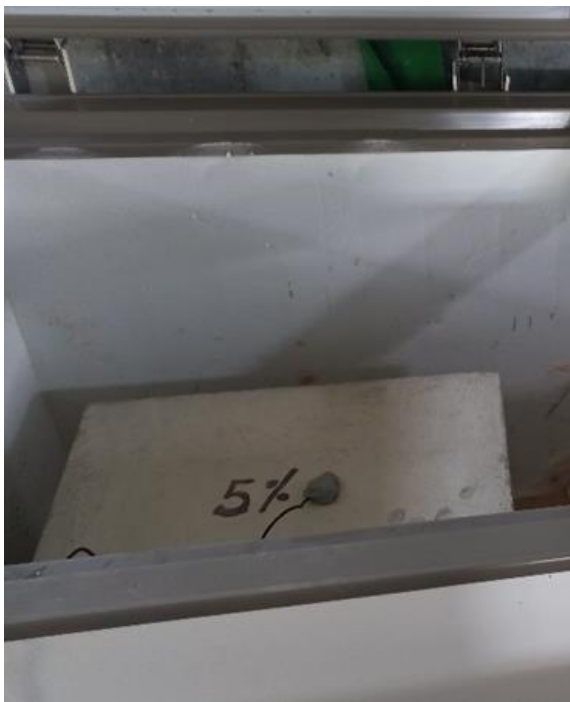
Ensayo de maquetas de mortero 1:4 con 5% y 7% de poliestireno.
