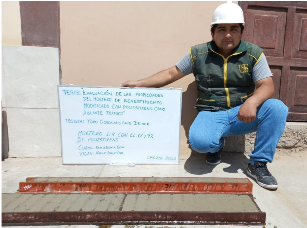
Especímenes de mortero con el 7% y 9% de Poliestireno.
