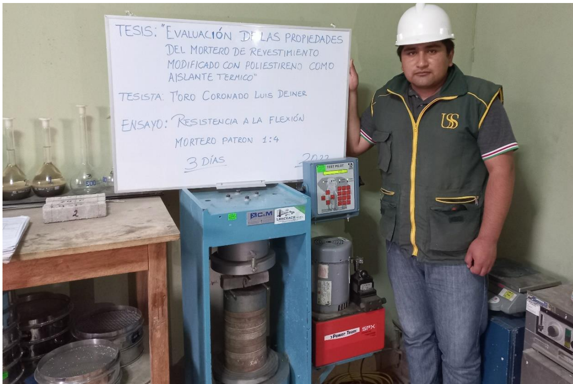
Fig. 17. Resistencia a la flexión de prismas
