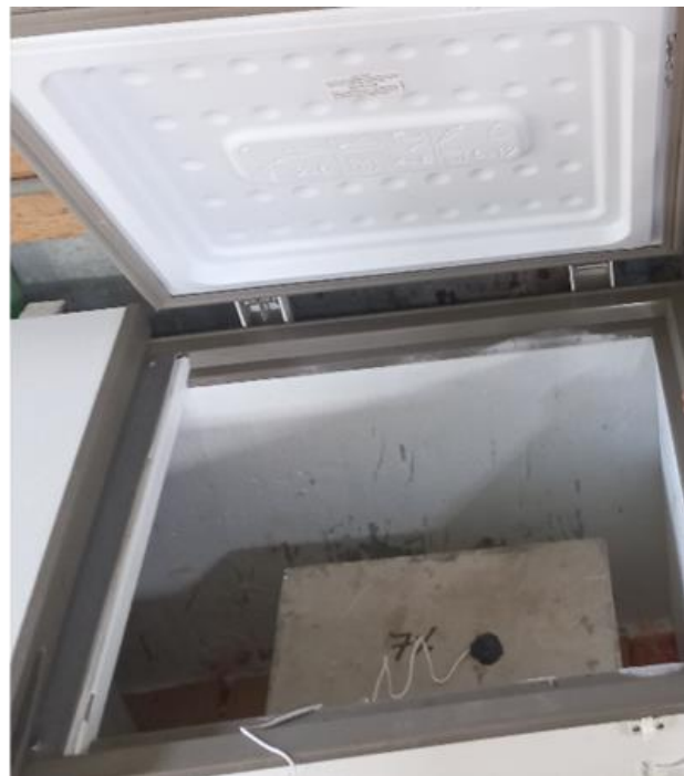
Ensayo de maquetas de mortero 1:4 con 5% y 7% de poliestireno.
