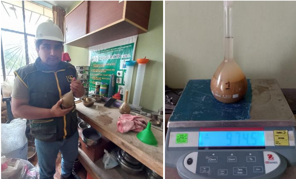
Fig. 11. Saturación del agregado fino hasta alcanzar un volumen de 500 cm 3
