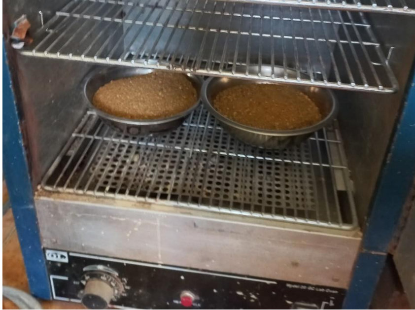
Fig. 12. Muestras para el ensayo de contenido de humedad
