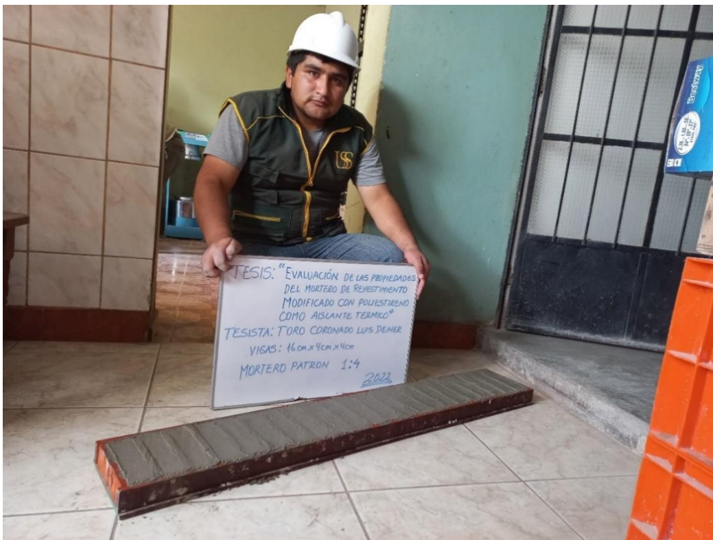
Elaboración de especímenes de mortero patrón 1:4.
