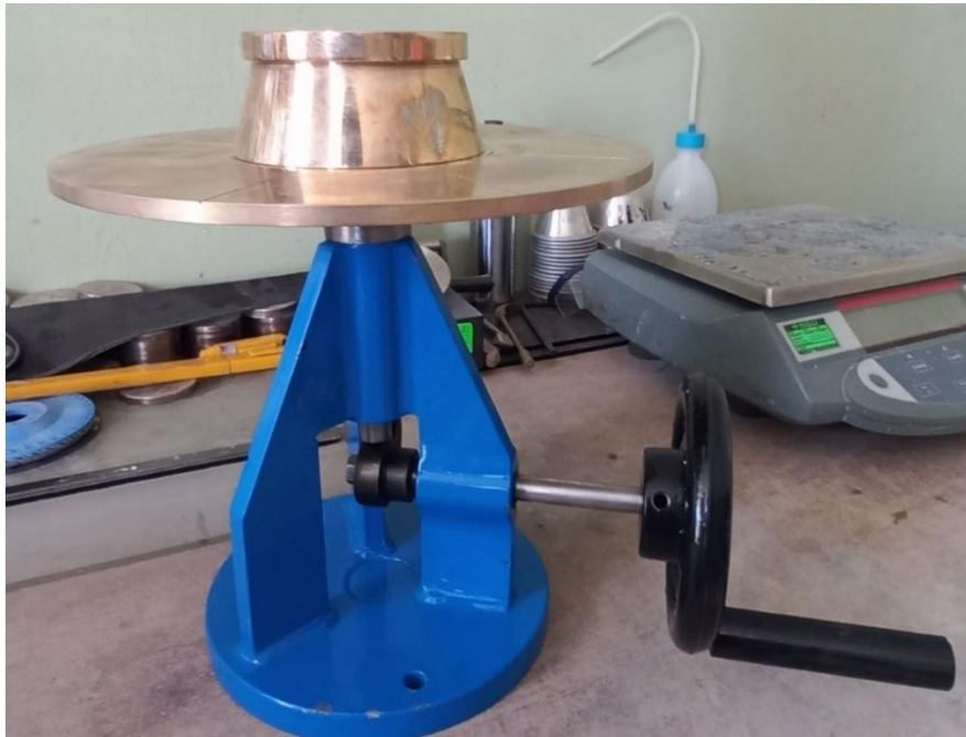
Fig. 13. Mesa de flujo para el ensayo de fluidez
