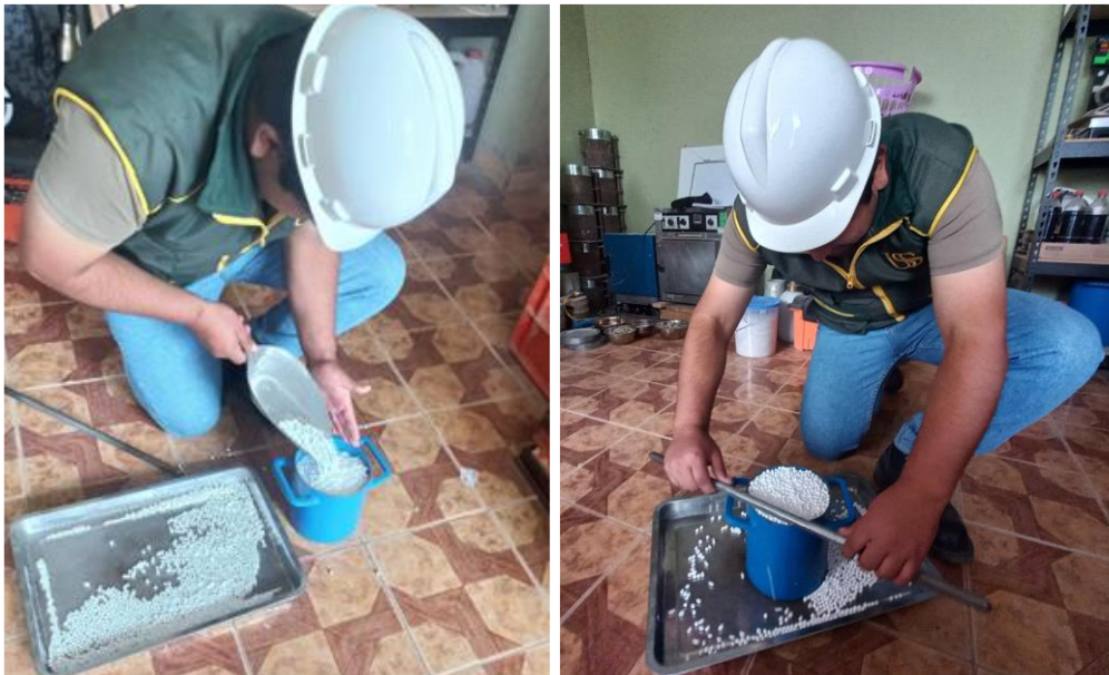
Fig. 10. Peso unitario del poliestireno
