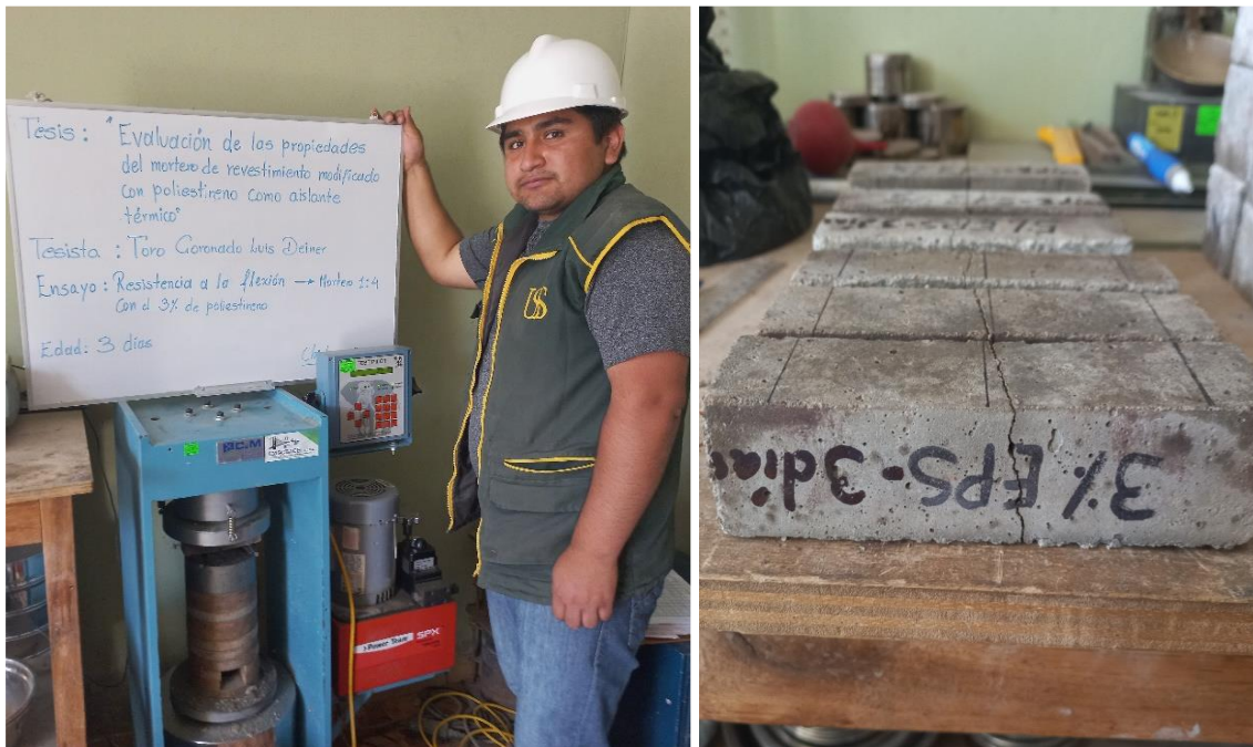
Resistencia a la flexión del mortero.
