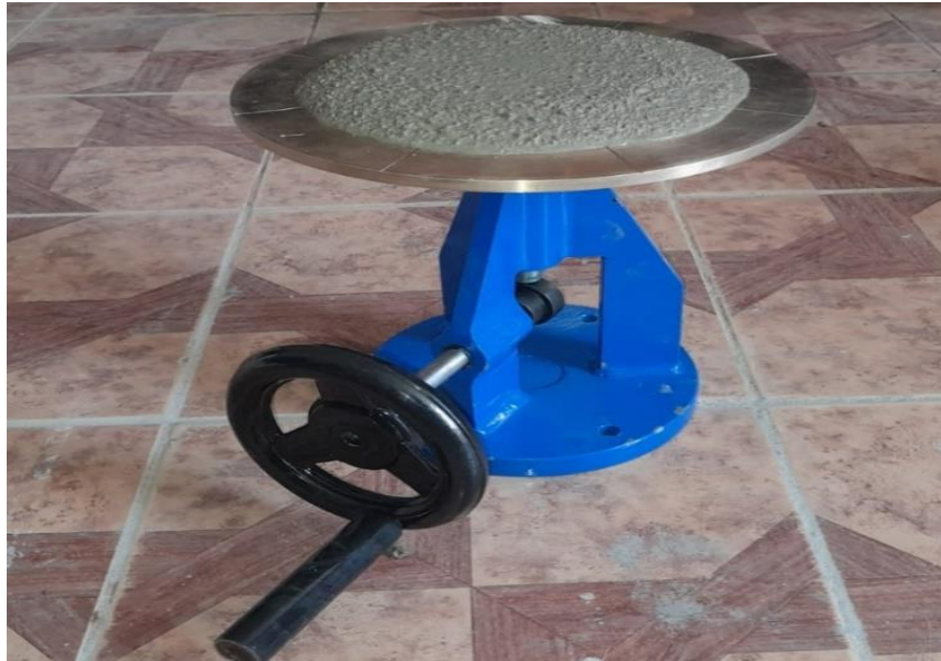
Fig. 14. Ensayo de fluidez del mortero
