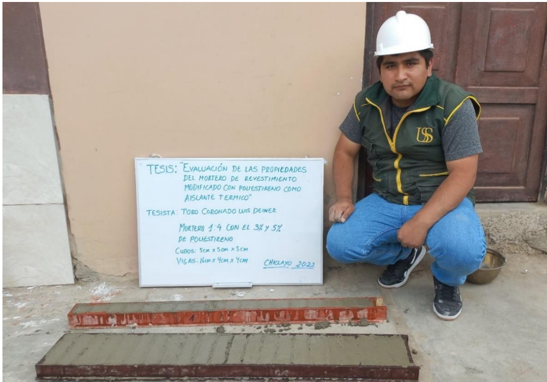
Especímenes de mortero 1:4 con el 3% y 5% de Poliestireno.
