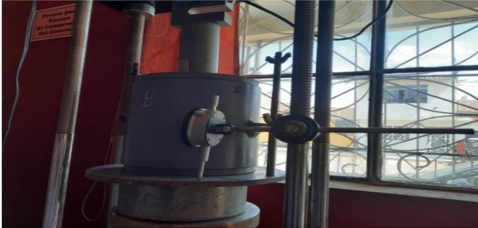
Fig. 22. Ensayo para determinar el CBR (California Bearing Ratio)
