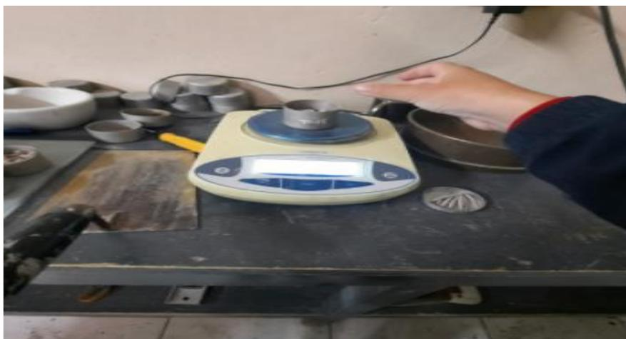
Fig. 19. Determinación del contenido de humedad natural
