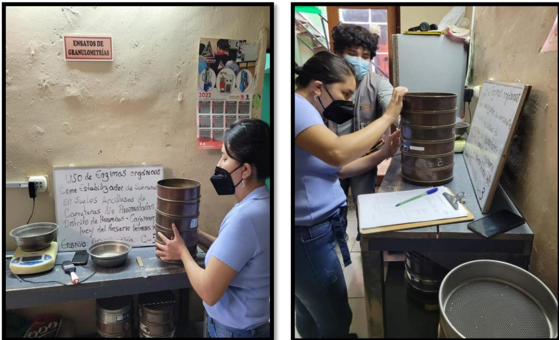
**FOTO 05:** Ensayo de análisis granulométrico
