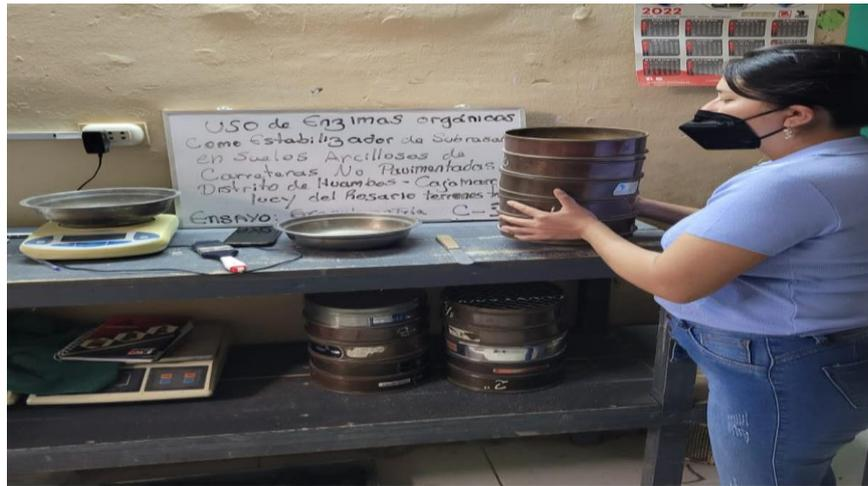
Fig. 18. Análisis granulométrico por tamizado.
