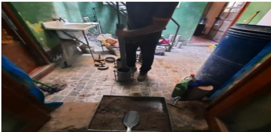
Fig. 21. Determinación de la compactación mediante proctor modificado.
