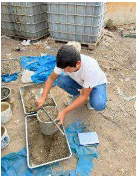
**Fig. 10.** Peso unitario suelto del material granular
