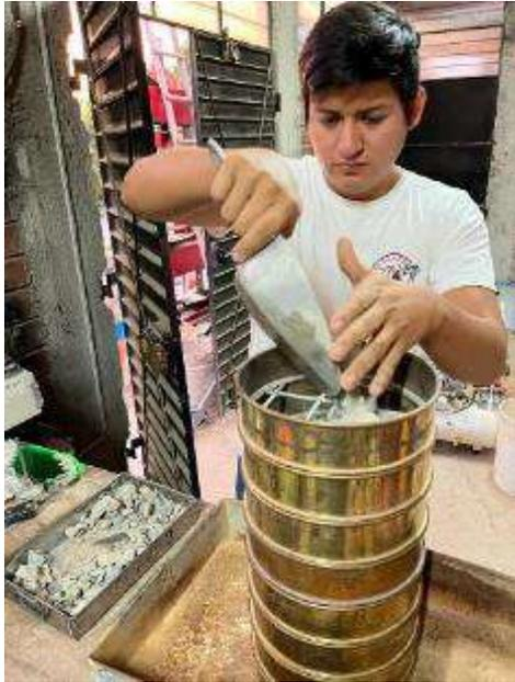
**Fig. 6.** Ensayo granulométrico del agregado fino y grueso
