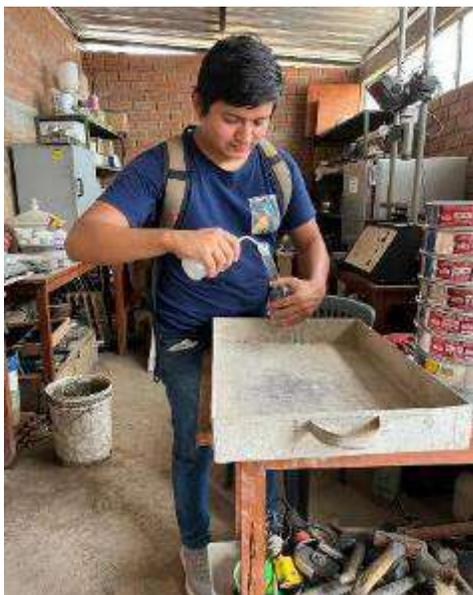
**Fig. 7.** *Ensayo de peso específico del material granular fino*
