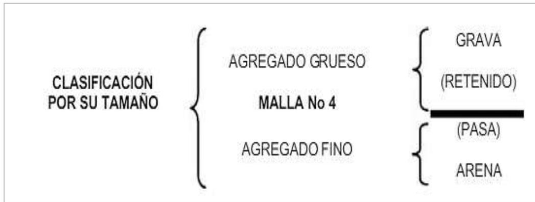
**Fig. 2.** Clasificación de agregado
