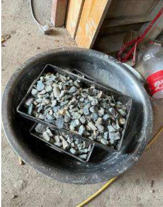
**Fig. 8.** Ensayo de peso específico del material granular grueso
