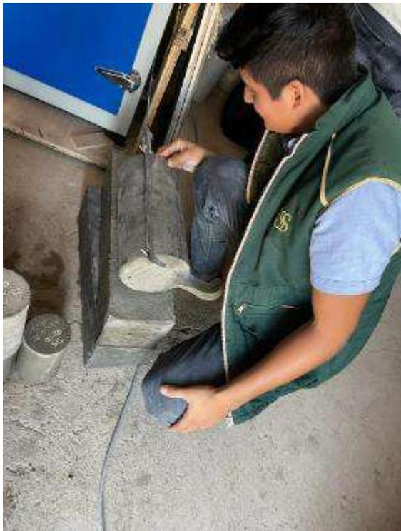
**Fig. 13.** Rotura de probeta cilíndrica al ensayo de compresión axial
