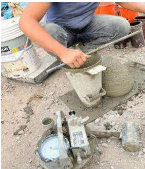
**Fig. 12.** Ensayo de revenimiento en el concreto fresco en el cono de Abrams.
