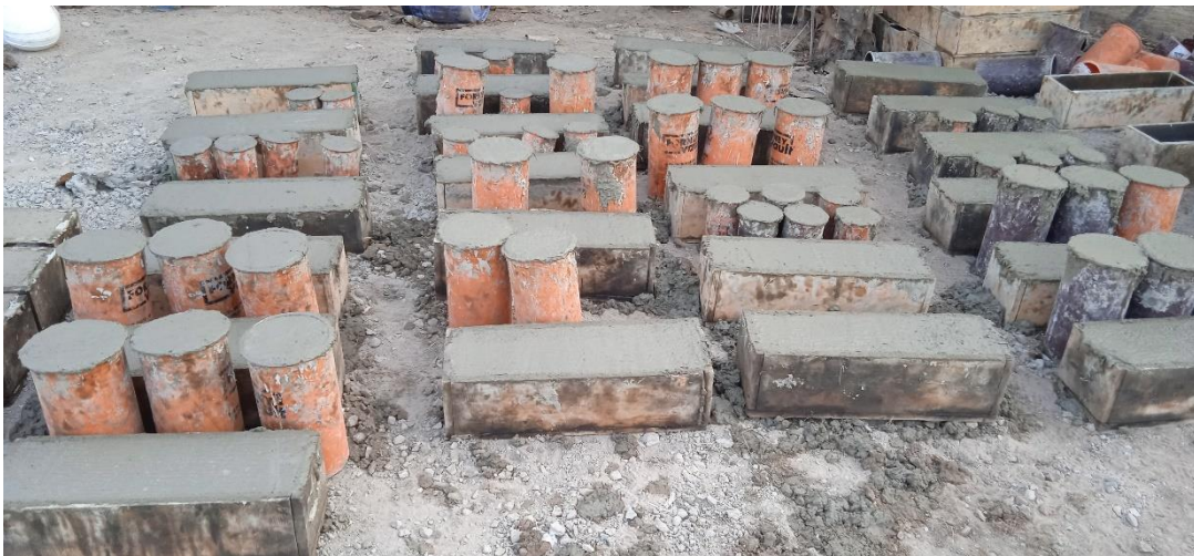
Fotografía 06. Moldes llenados de mezcla de concreto de f'c=210 \text{ kg/cm}^2 .
