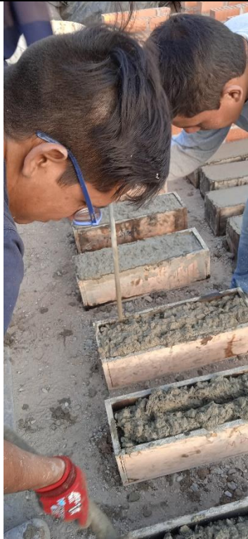
Fotografía 05. Vaciado de mezcla de concreto hacia el molde de forma de viga para ensayo a flexión.
