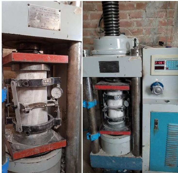
Fotografía 08. Rotura de probetas cilíndricas para resistencia a compresión a los 7 días de tiempo de curado de f'c=210 kg/cm 2 .
