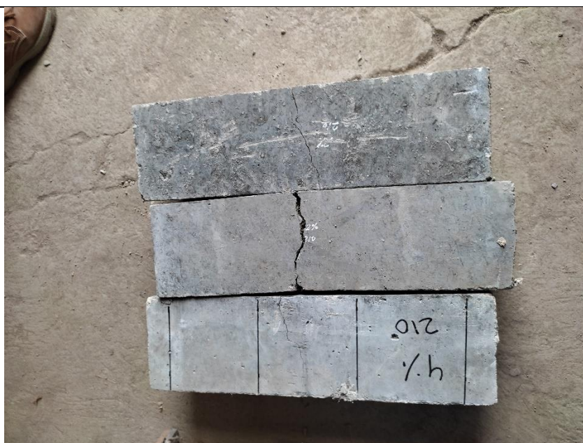
Fotografía 10. Rotura de las vigas a resistencia a flexión de 210 \text{ kg/cm}^2 , las fallas generadas para las tres muestras de 4% de adición de fibra de sisal.
