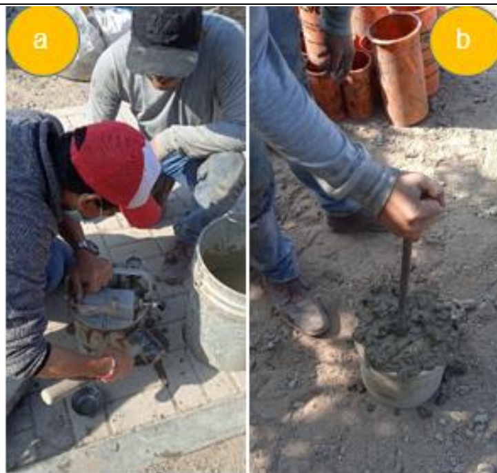
Fotografía 04. (a) El molde metálico se tiene instalando para luego vaciar la mezcla de concreto en la probeta cilíndrica por capas (b).
