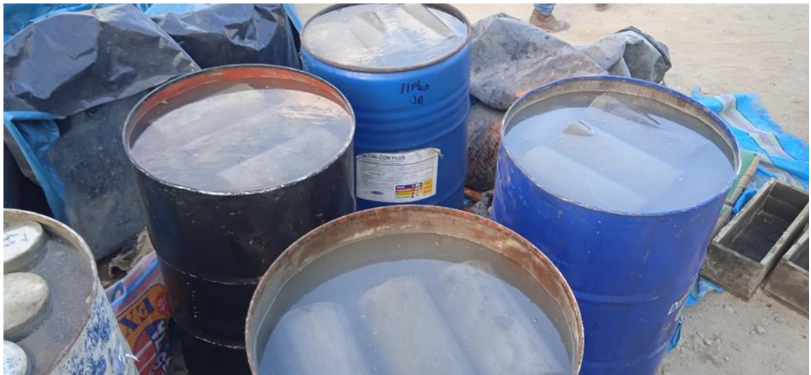
Fotografía 07. Curado de probetas a los 7, 14 y 28 días de curado de f'c=210 kg/cm 2 y 280 kg/cm 2 .
