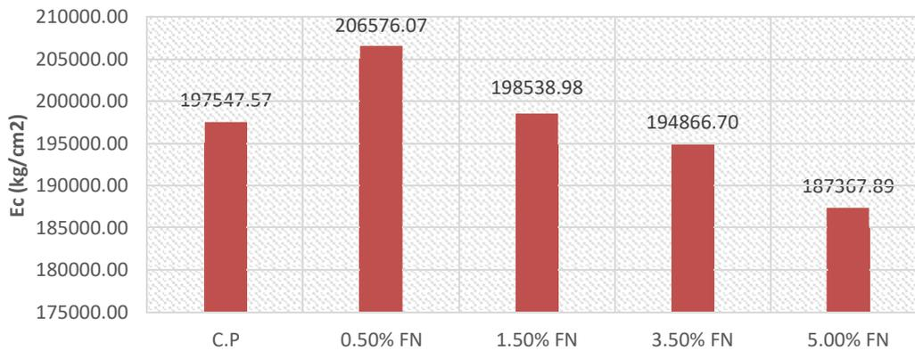
**Fig 46.** Comparativa de módulos de elasticidad de un f'c 210 y la adición de FN a los 14 días de edad
