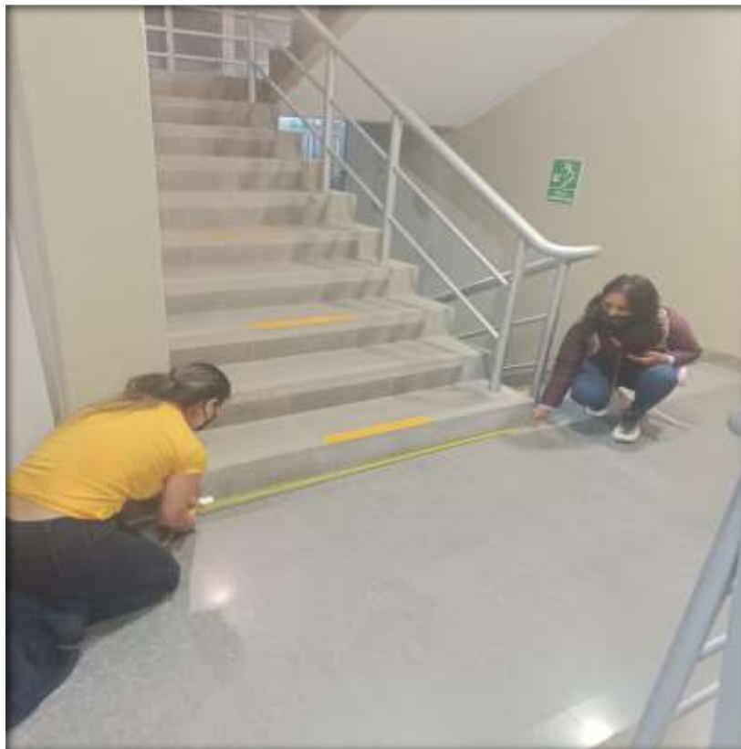
Toma de medida del ancho de la escalera principal
