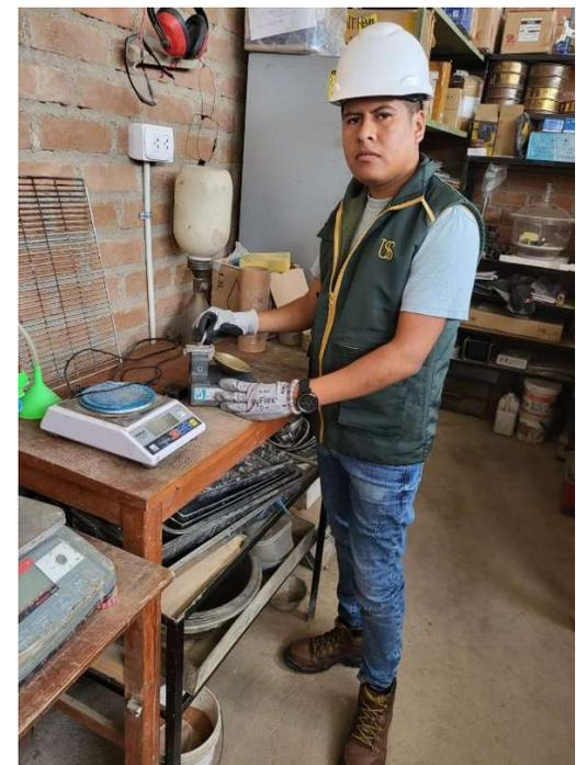
**Fotografía 4.** Ensayo de límite de líquido y límite plástico para obtención del índice de plasticidad
