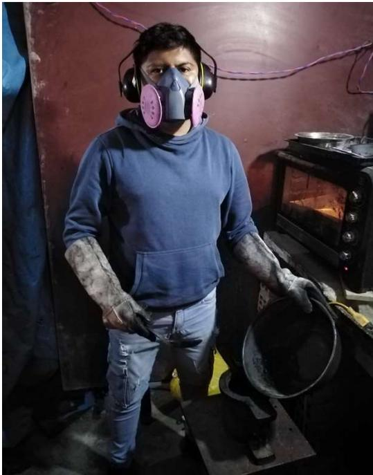
**Fotografía 10.** Colocación de la mezcla asfáltica al molde de acero para ser compactada a 75 golpes cada lado a 130 °C
