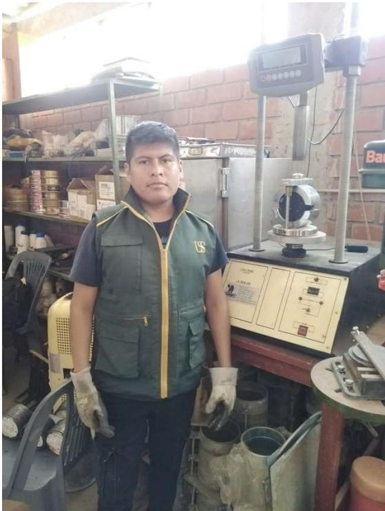
**Fotografía 18.** Prueba de estabilidad y flujo para cada briqueta colocada en el cabeza de prueba calibrado
