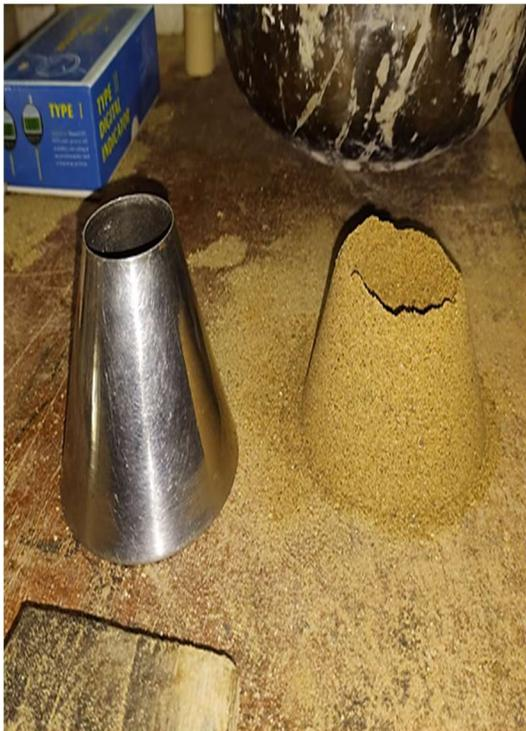
**Fotografía 6.** Ensayo de pesos específico y absorción del agregado fino
