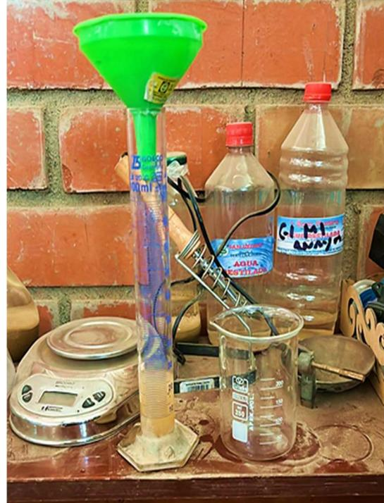
**Fotografía 7.** Ensayo de contenido de sales del agregado fino y grueso
