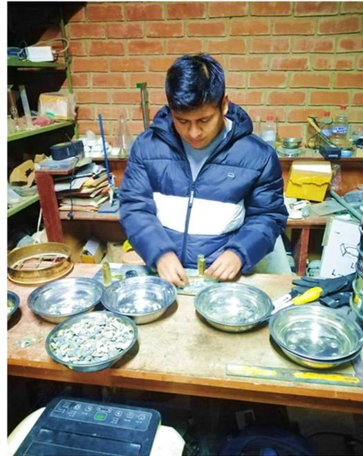
**Fotografía 3.** Ensayo de partículas chatas y alargadas del agregado grueso
