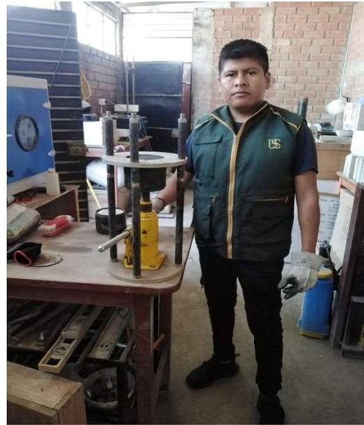
**Fotografía 11.** Retiro de briqueta empleando una gata, para así remover del molde de acero la muestra.
