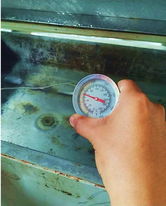
**Fotografía 17.** Control de temperatura del agua a 60°C
