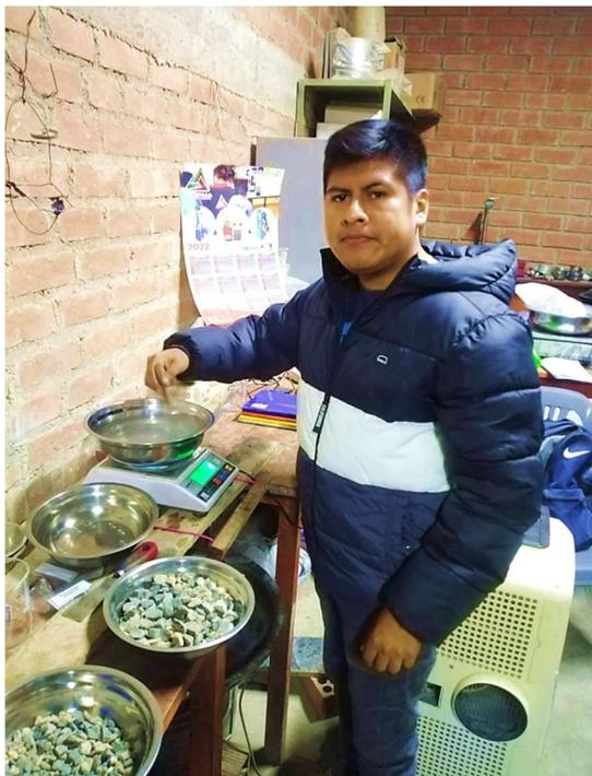
**Fotografía 2.** Ensayo de durabilidad al sulfato de magnesio de los agregados pétreos
