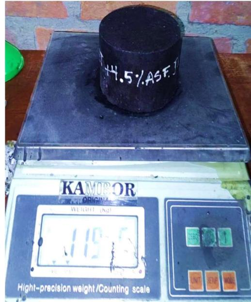
**Fotografía 15.** Peso húmedo de la briqueta luego de haber sido sumergida
