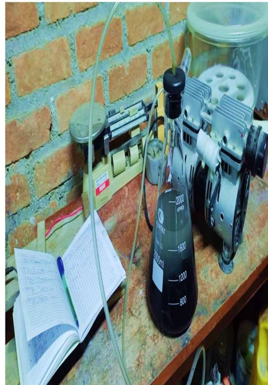
**Fotografía 20.** Retiro de contenido de vacíos en el ensayo de Rice.
