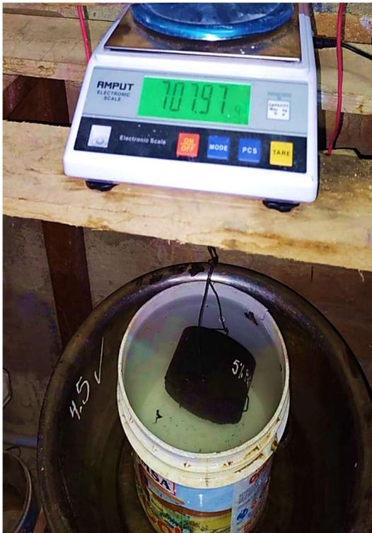
**Fotografía 14.** Peso sumergido de la briqueta a 25°C
