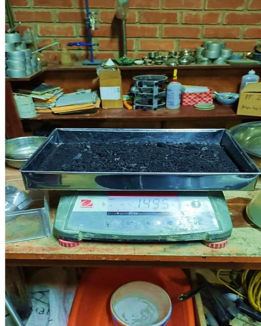
**Fotografía 19.** Peso de la mezcla asfáltica suelta para prueba de Gravedad específica teórica máxima (Rice)
