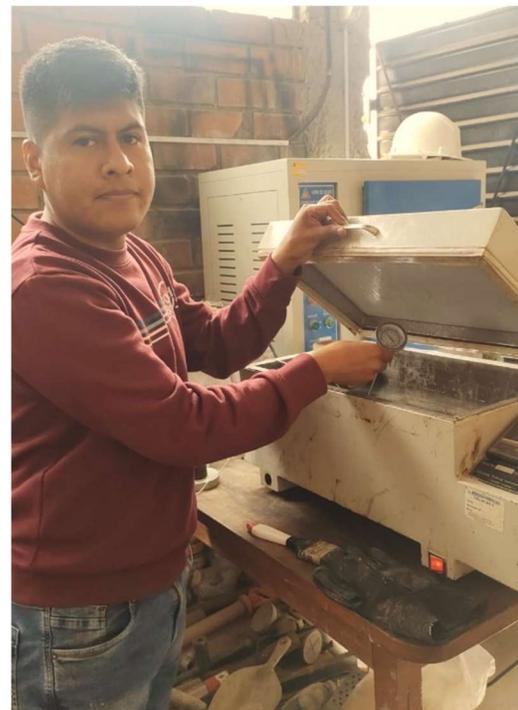
**Fotografía 16.** Briqueta sumergida a 60 °C durante 30 minutos para poder pasar la prueba de estabilidad y flujo en equipo Marshall
