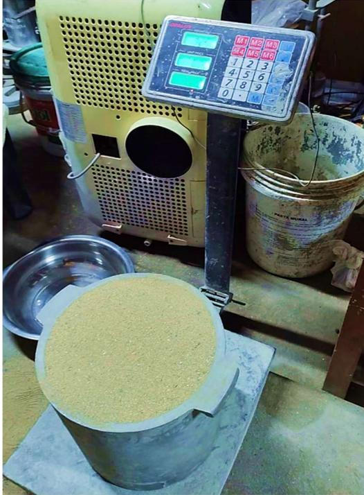
**Fotografía 5.** Ensayo de peso unitario suelto y compactado de los agregados pétreos
