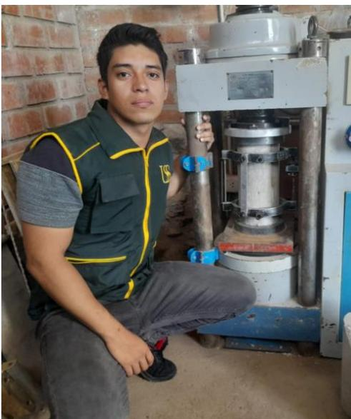
**Fig. 48.** Ensayo de módulo de elasticidad
