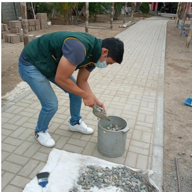
**Fig. 36.** Ensayo del peso unitario suelto y compactado del agregado
