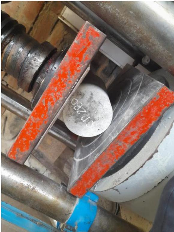
**Fig. 46.** Ensayo de resistencia a la tracción
