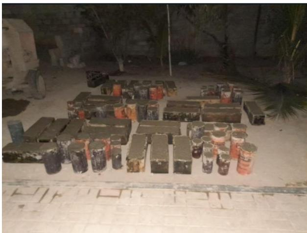
**Fig. 42.** Vaciado de probetas y vigas
