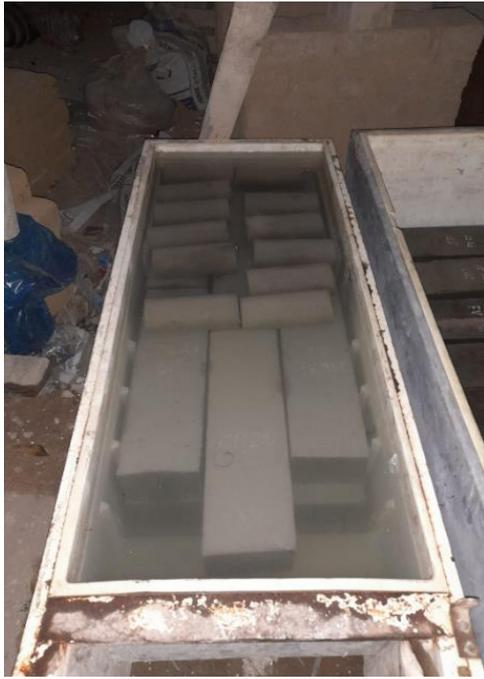
**Fig. 43.** Curado de probetas
