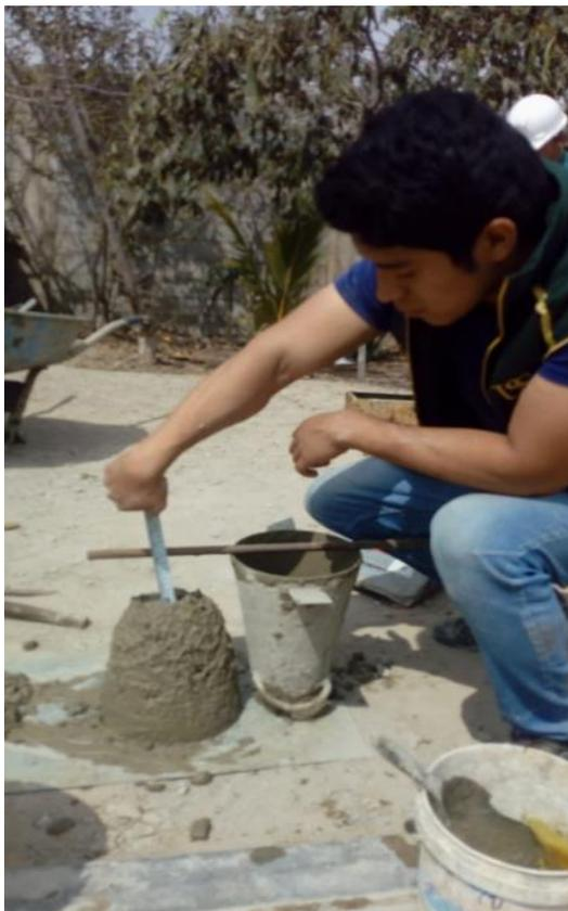
**Fig. 38.** Asentamiento del concreto
