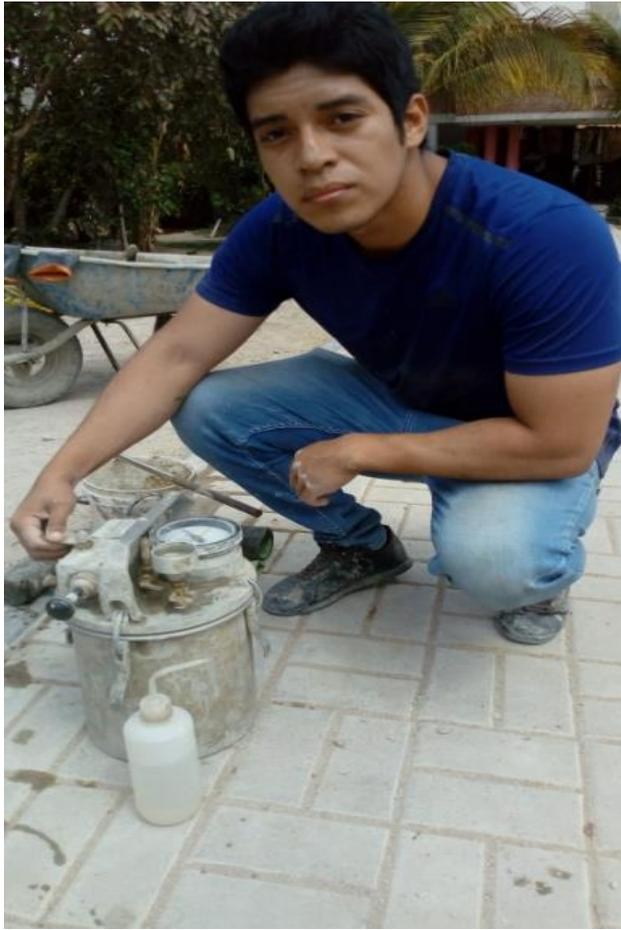
**Fig. 41.** Contenido de aire atrapado en el concreto
