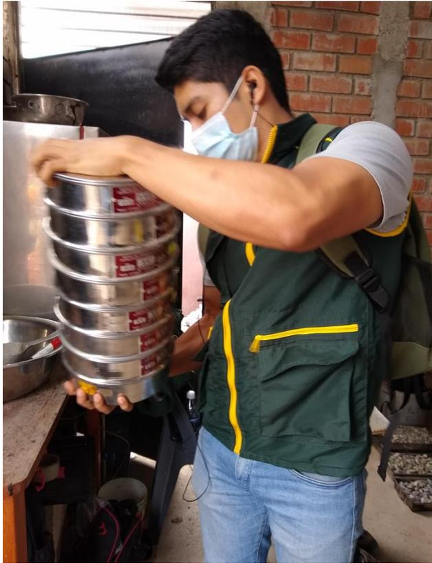
**Fig. 35.** Ensayo de análisis granulométrico de los agregados finos y grueso.
