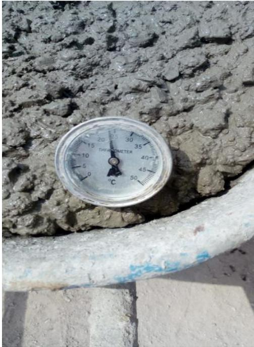
**Fig. 39.** Temperatura del concreto
