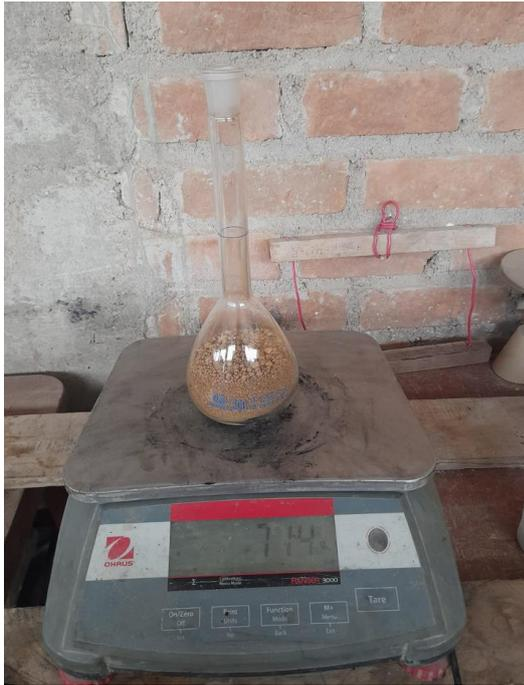
**Fig. 37.** Peso específico y absorción del agregado fino
