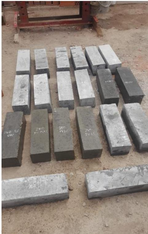
**Fig. 44.** Desencofrado de probetas y vigas
