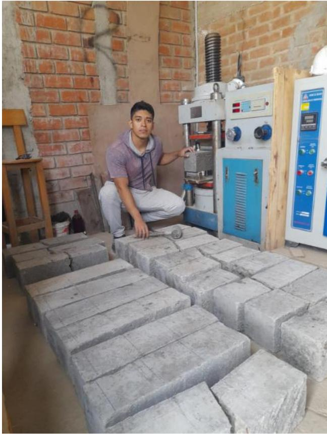
**Fig. 47.** Ensayo de resistencia a la flexión
