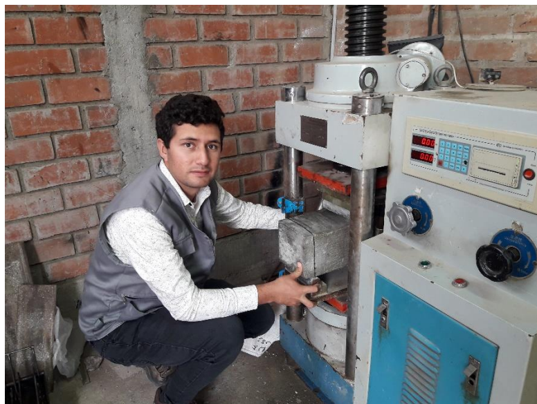
Prueba de resistencia a flexión de prismas de concreto
