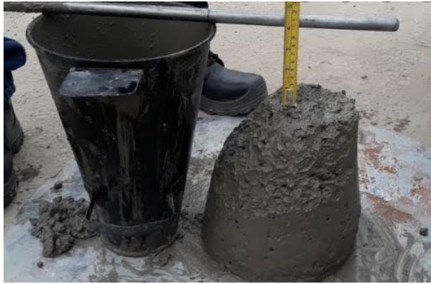
Fig. 23. Control de Slump, para determinar el estado de trabajabilidad.
