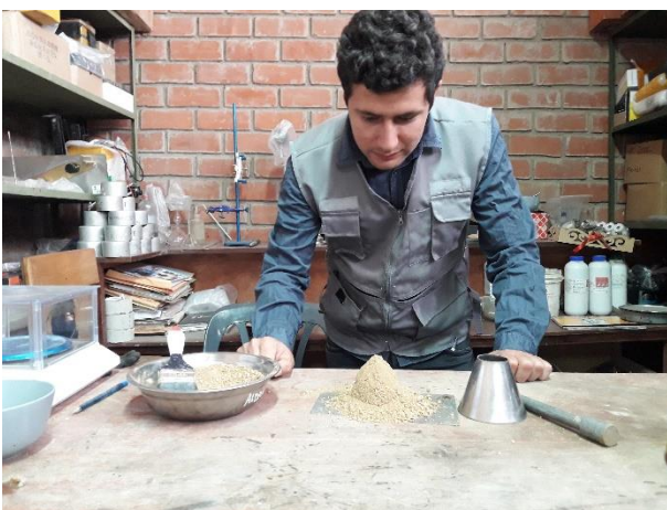
Fig. 20. Retiro de cono para determinar la condición superficialmente seca.
