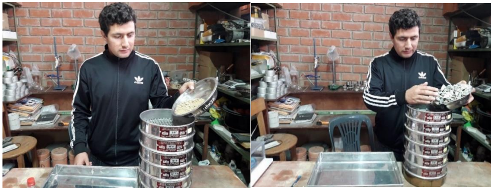
Fig. 13. Tamizado de agregado fino y grueso.
