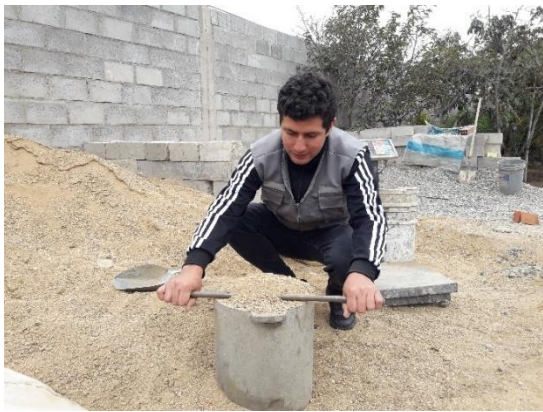
Fig. 14. Determinación de masa por unidad de volumen de agregado Fino.
