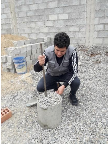
Fig. 15. Determinación de masa por unidad de volumen de agregado Grueso.
