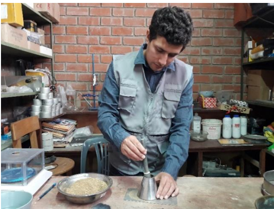
Fig. 19. 25 golpes con el piso a una altura de 5mm.
