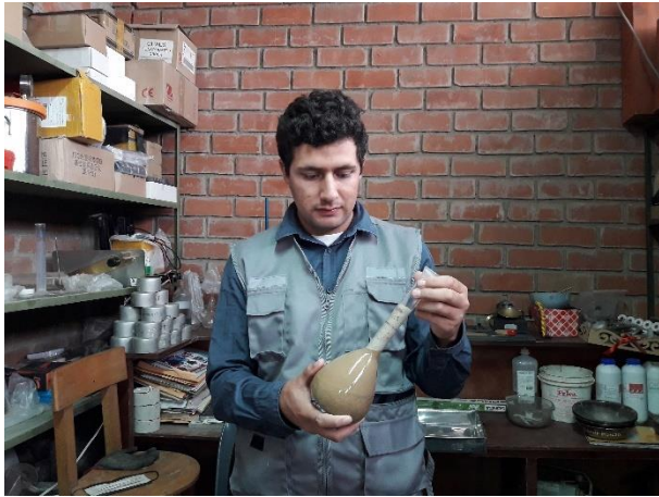
Fig. 21. Proceso de eliminación de burbujas de aire.
