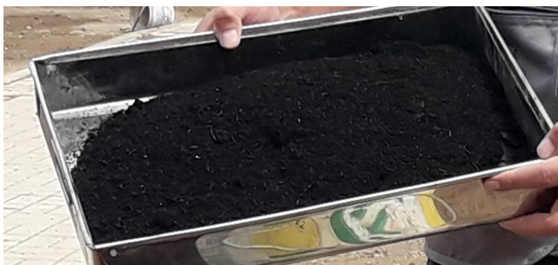
Fig. 12. Obtención del caucho desmenuzado, listo para poder ser empleado.
