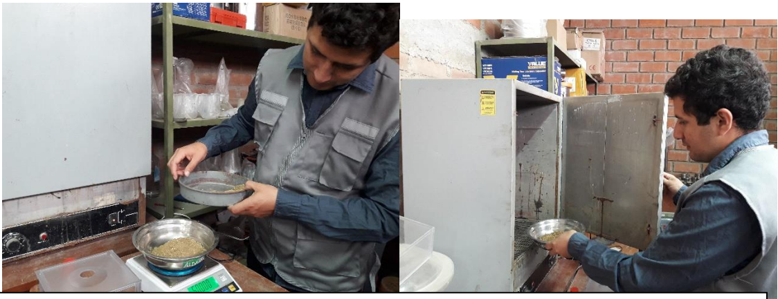
Prueba de absorción y contenido de humedad del árido fino
