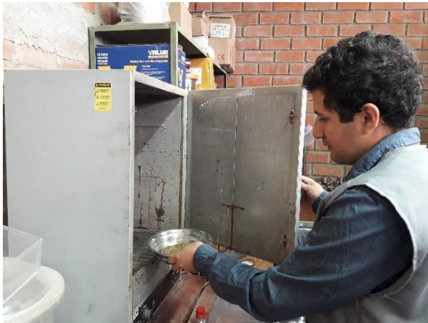
Fig. 22. Puesto al Horno para posterior lectura de muestra seca.
