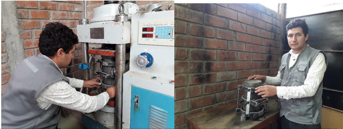
Prueba de resistencia a compresión sometida
