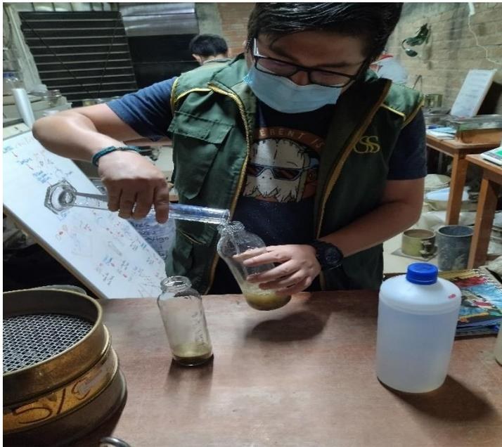
Ensayo de equivalencia de arena
