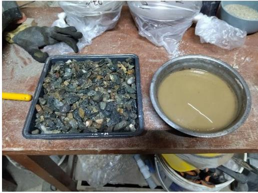
**Fig. 10.** Ensayo de absorción y peso específico de agregado grueso
