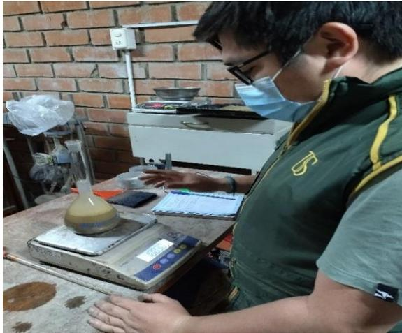
**Fig. 11.** Ensayo de absorción y peso específico de agregado fino
