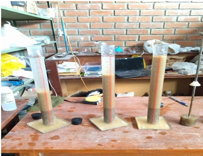
*Ensayo para peso específico*
