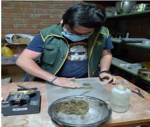
**Fig. 9.** Ensayo de limite plástico
