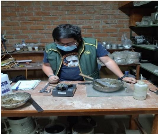
**Fig. 8.** Ensayo de limite liquido
