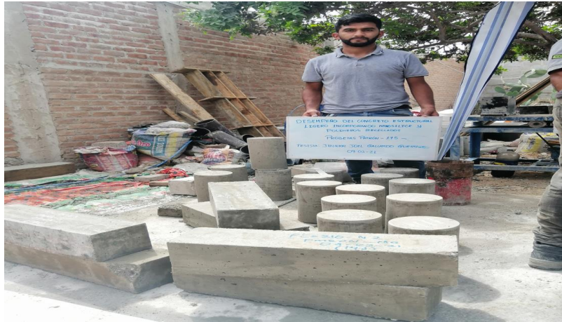
Fig. 28. Probetas cilíndricas y prismáticas de muestra a edad de 7 días, para evaluar su resistencia.
