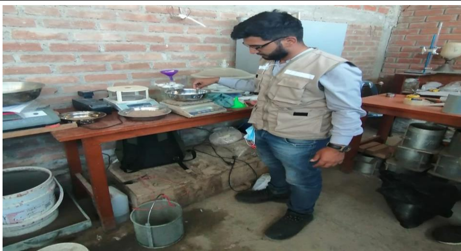
Fig. 27. Peso del material tamizado por la malla N°200 - Abertura de 75 \mu m.
