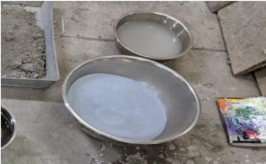
Fig. 11. Nanosilice (líquido blanco) y Microsilice (polvo gris/acero), pesadas antes del mezclado del concreto. [14]
