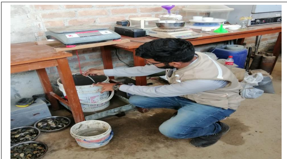
Fig. 25. Realización del ensayo de peso específico y absorción del agregado grueso.
