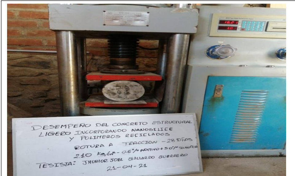
Fig. 33. Rotura - ensayo a tracción.
