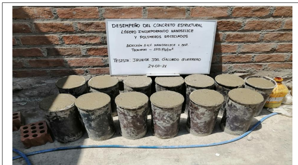
Fig. 31. Especímenes en estado fresco, en proceso de fraguado.
