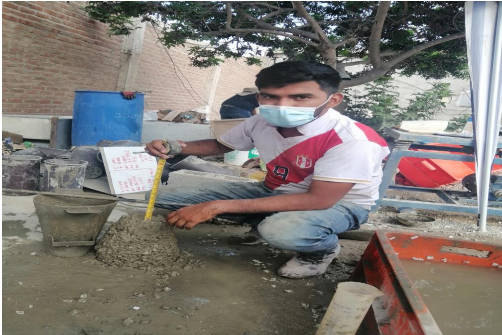
Ensayo de asentamiento del concreto patrón
