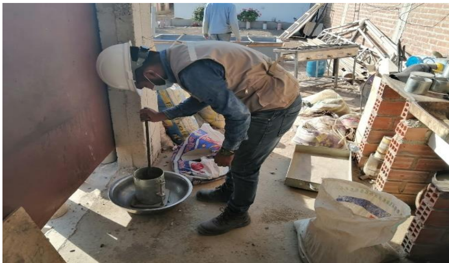
Fig. 23. Realización del ensayo de peso unitario compactado del agregado grueso.
