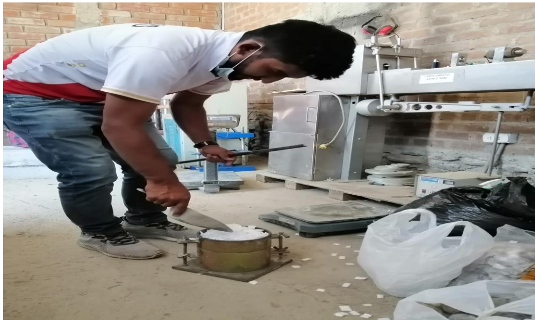
Ensayo de peso unitario (densidad) del polímero reciclado
