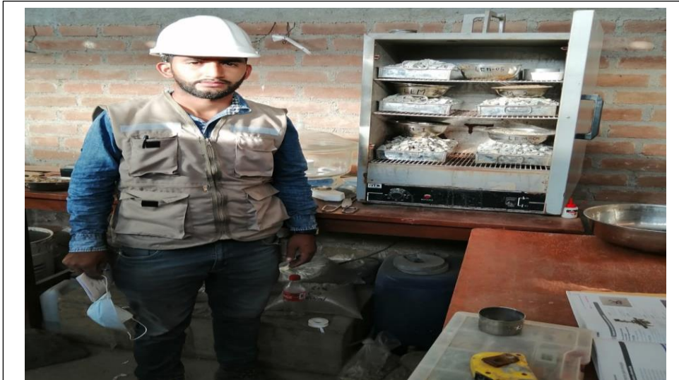
Fig. 24. Peso de la muestra seca al horno del agregado fino y grueso.
