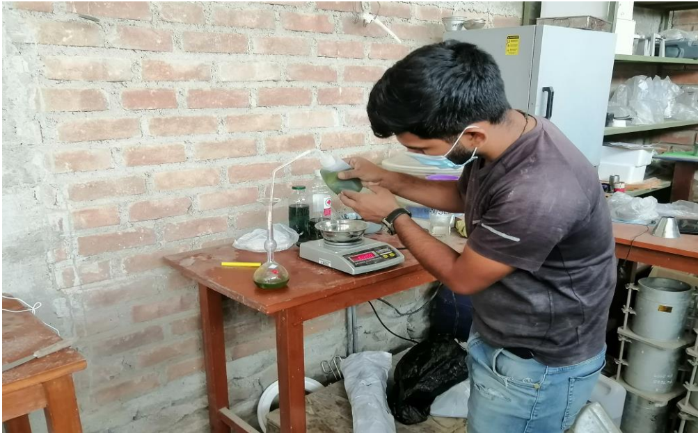
Ensayo de peso específico al cemento Pacasmayo tipo I – color verde
