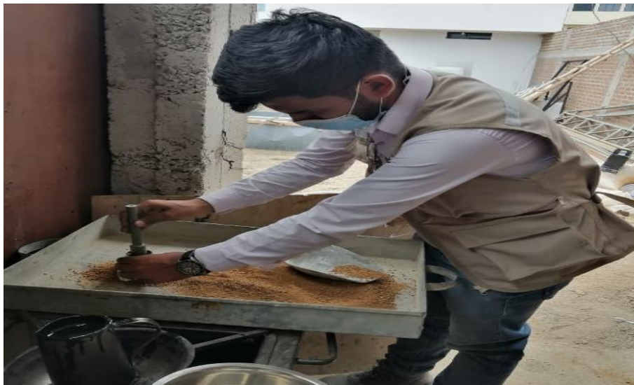
Fig. 26. Secado - agregado fino.
