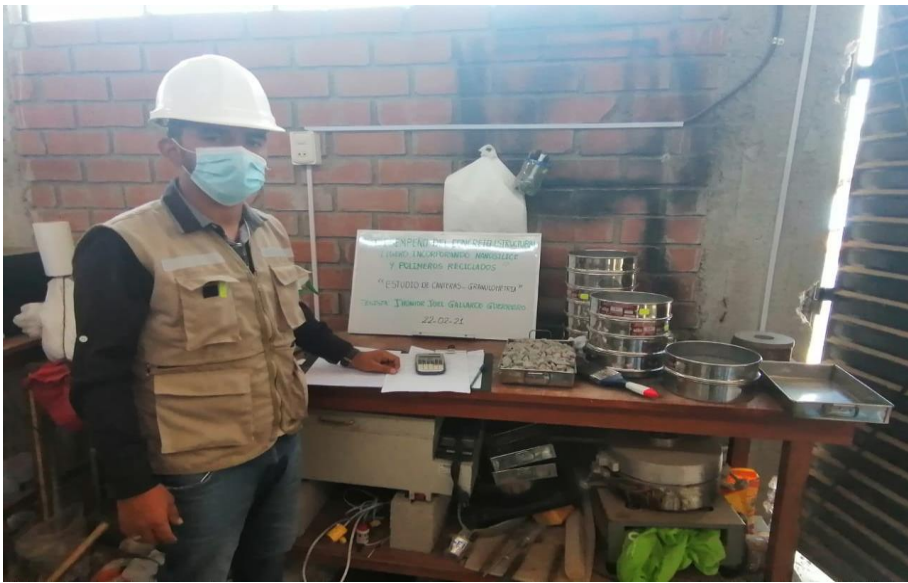
Fig. 22. Tamizado del agregado grueso con las mallas estandarizadas.
