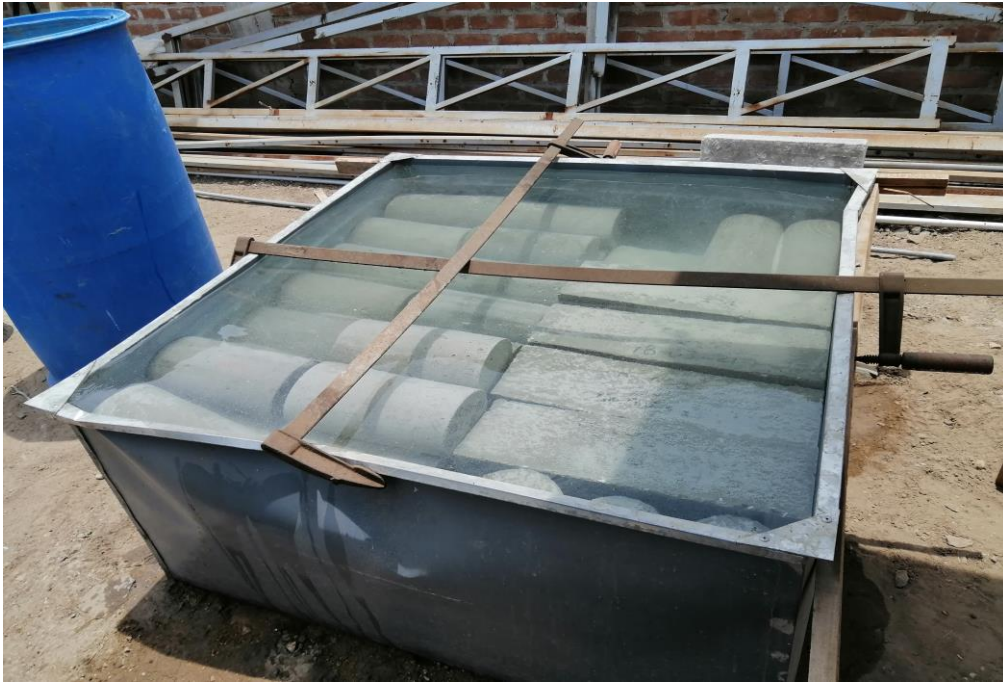
Curado de probetas patrón en agua potable
