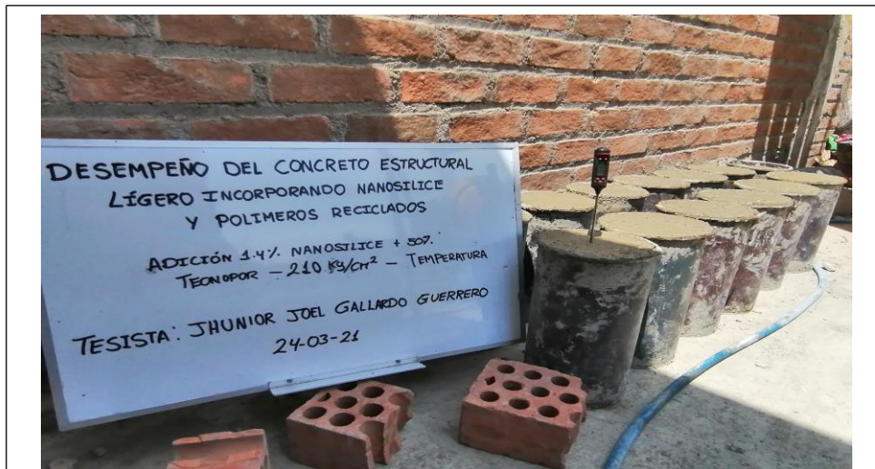
Fig. 30. Medición de la temperatura.
