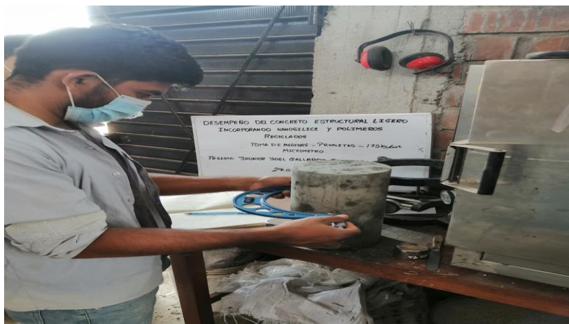
Fig. 36. Preparación de probeta cilíndrica para el Ensayo del módulo de elasticidad.
