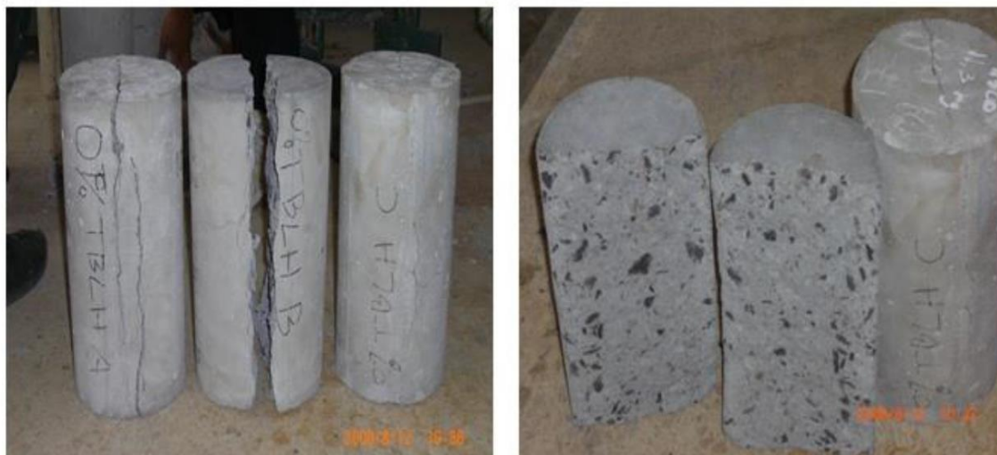
Fig. 1. Fallo del concreto agregado ligero simple. [35]
