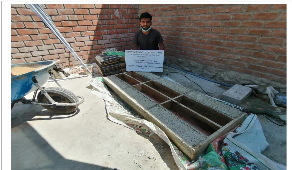
Fig. 34. Vigas de concreto- ensayadas a flexión.
