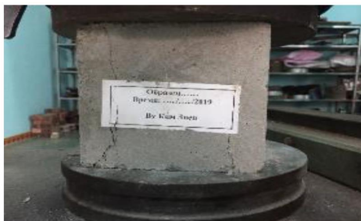
Fig. 3. Ensayo de la muestra bajo compresión. [43]
