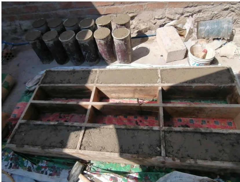
Fig. 32. Probetas en estado fresco, en proceso de fraguado.
