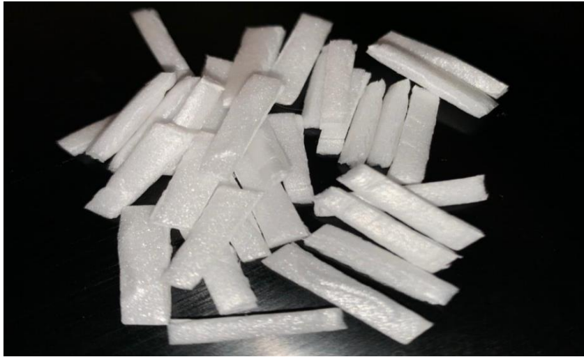
Fig. 51. Polímero reciclado cortado en 5 mm x 10 mm.
