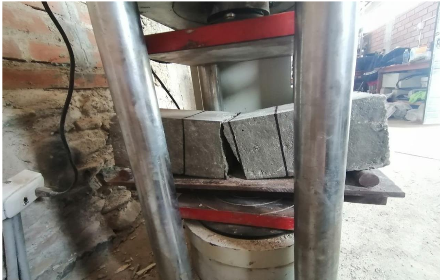
Fig. 35. Rotura de vigas de concreto - ensayo a flexión.
