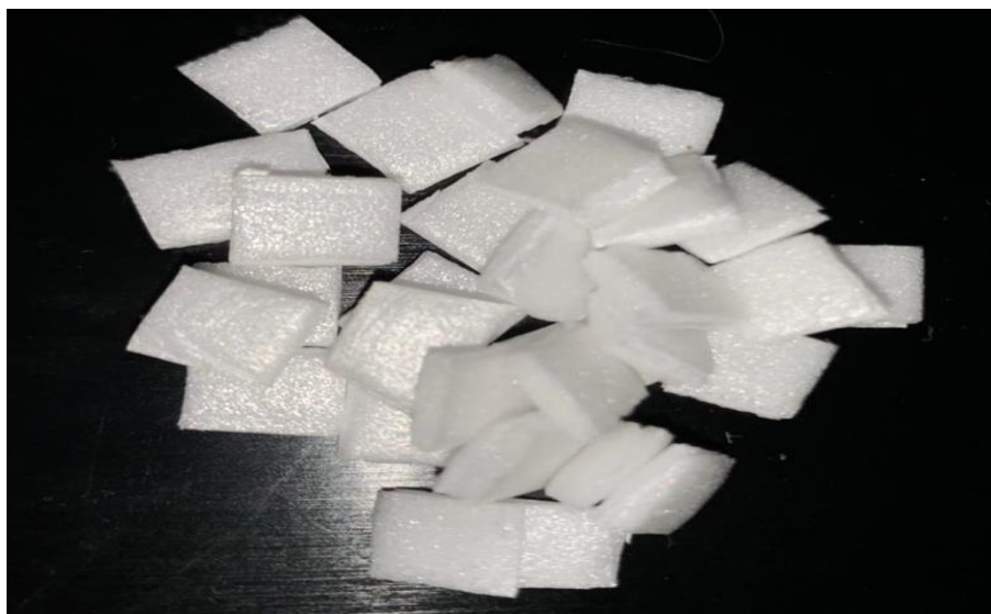
Fig. 50. Polímero reciclado cortado en 6 mm x 6mm.
