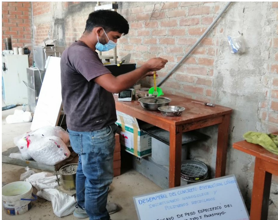
Fig. 18. Ensayo de peso específico al cemento Pacasmayo - Tipo I (42.5 kg).
