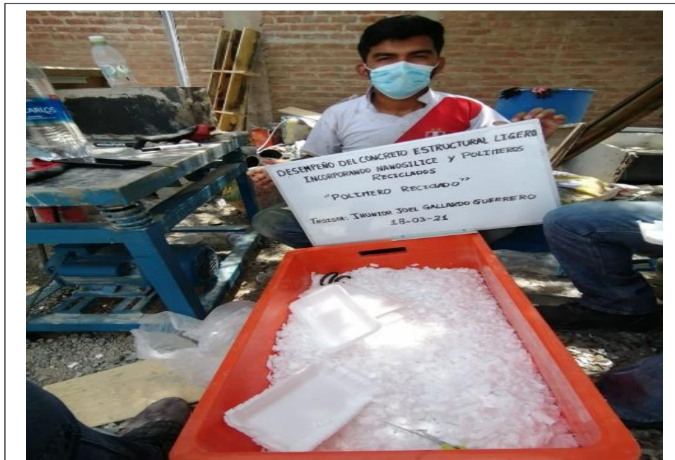
Fig. 21. Polímero reciclado recortado en forma cuadrada de 6mm.
