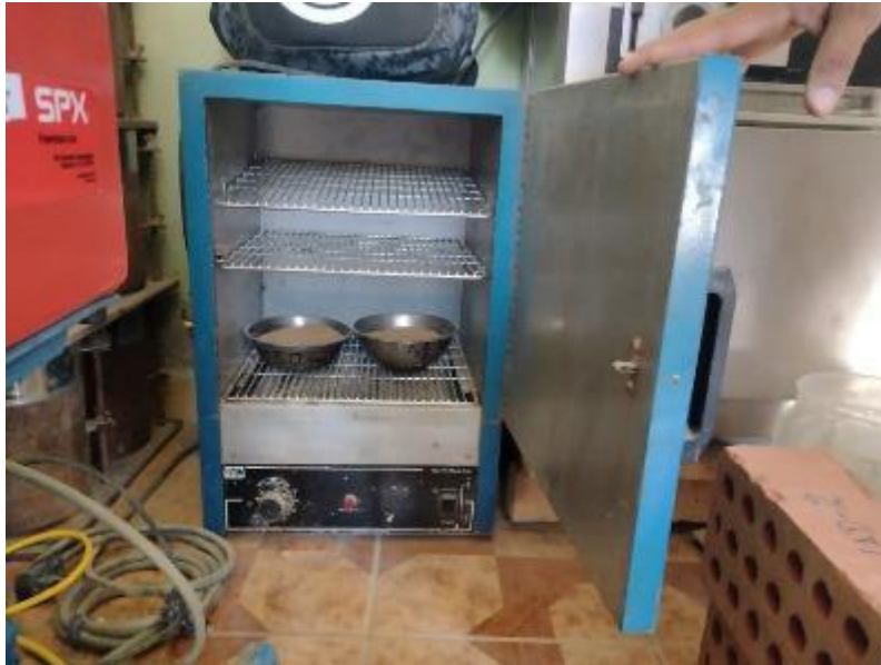
Fig. 31. Puesta en horno - Agregado fino.
