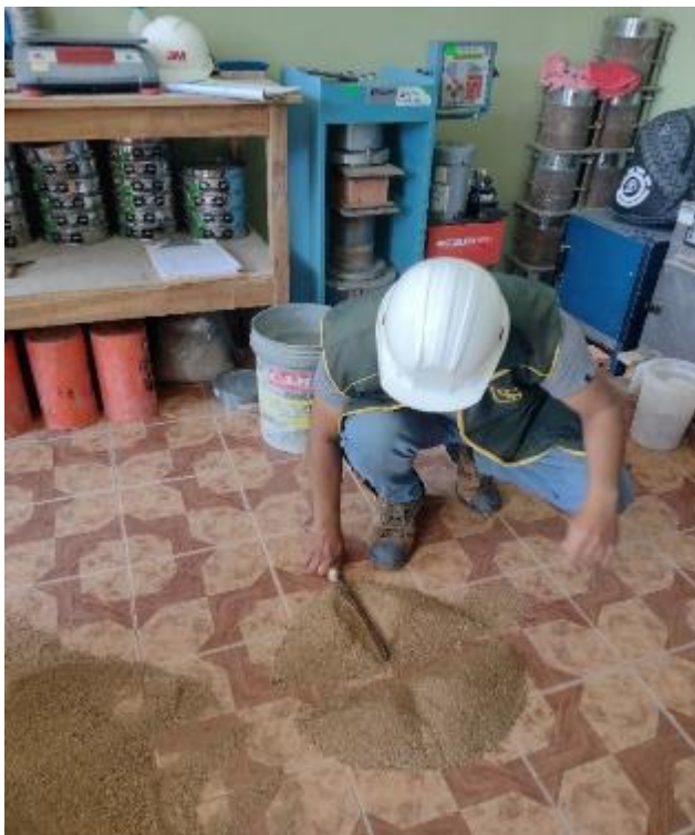
Realizando el cuarteo respectivo a la arena gruesa.
