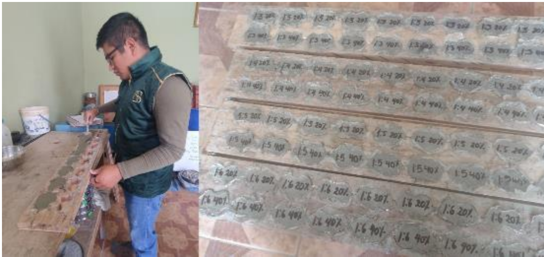
Vaciado de briqueta para el ensayo a tracción.
