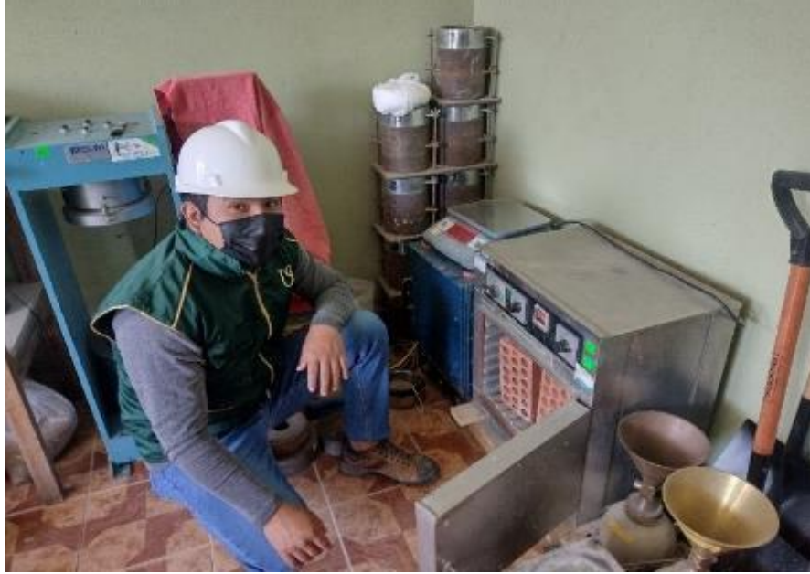
Fig. 36. Unidades de albañilería puestas en el horno.
