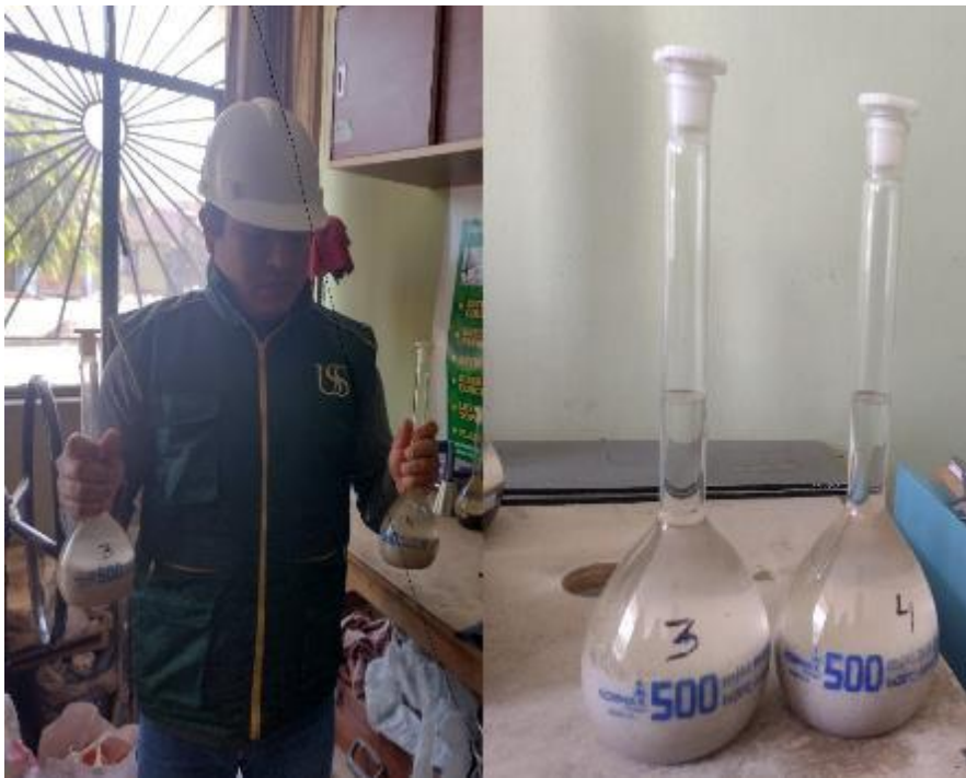
Arena gruesa - Porcelanato reciclado - Peso específico.
