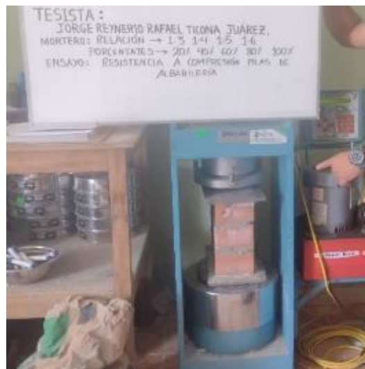
Fig. 55. Pilas de albañilería ensayadas a compresión axial.
