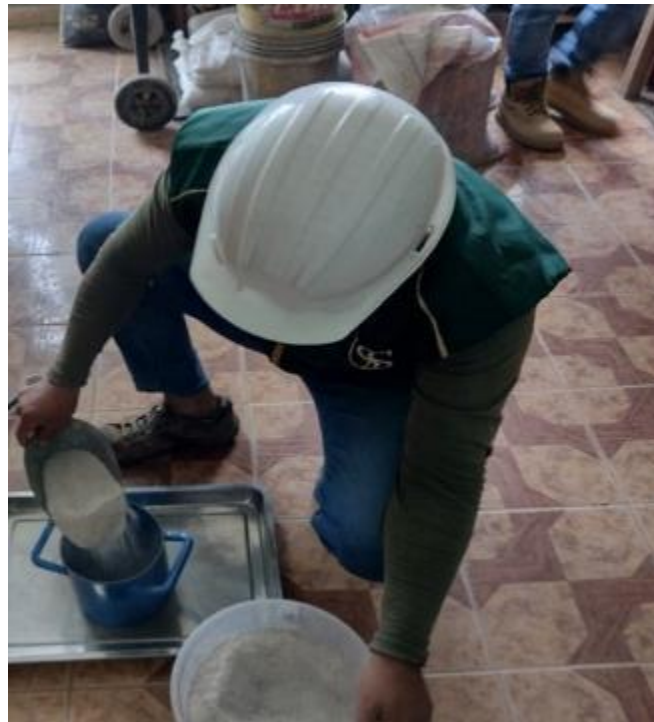
Fig. 24. Porcelanato reciclado - Peso unitario suelto.
