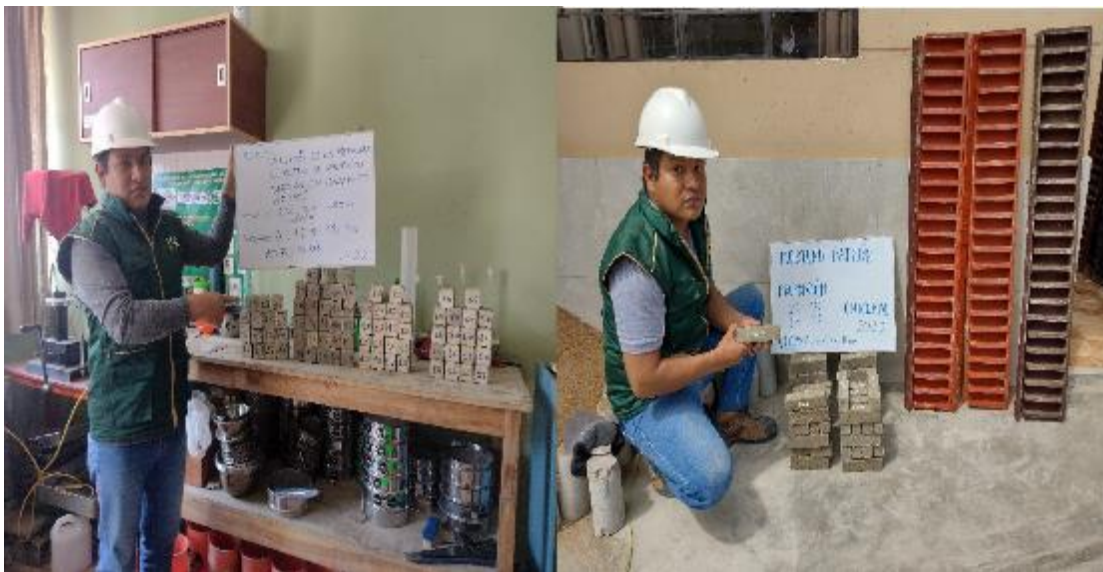
Desenformado de cubos y vigas.
