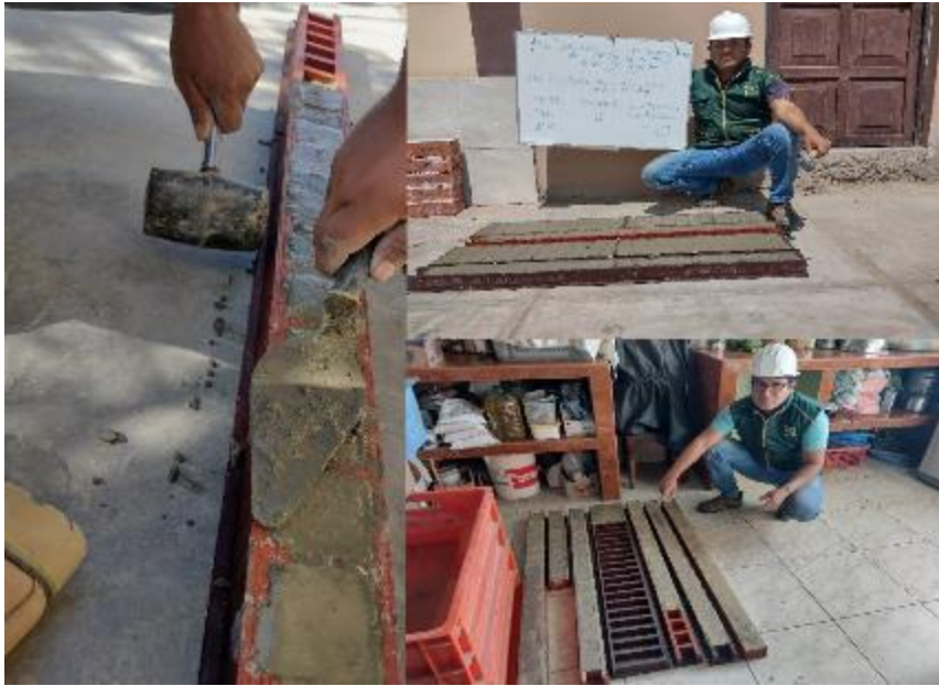
Vaciado del mortero - cubos y vigas.
