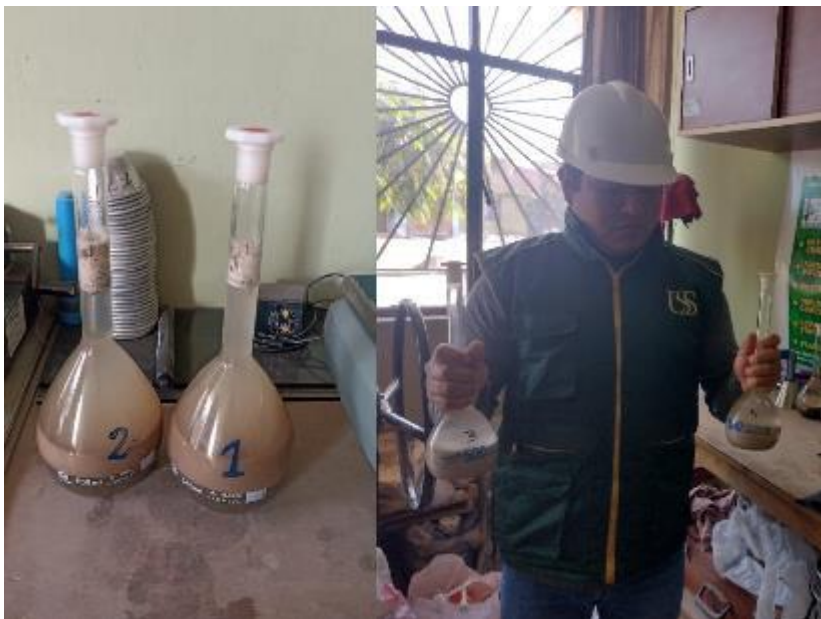
Arena gruesa - Peso específico.
