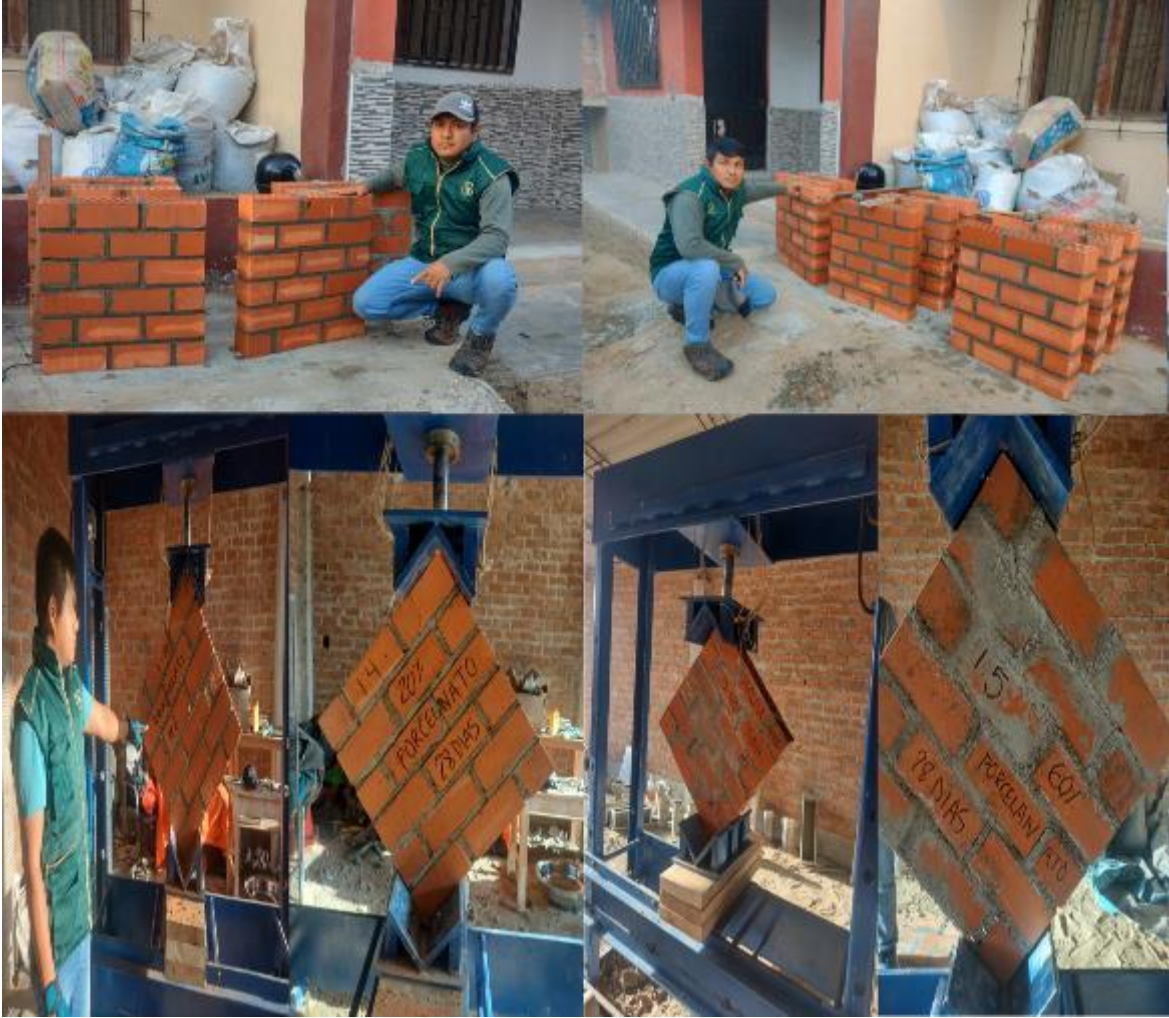
Ensayo a compresión diagonal de muretes.
