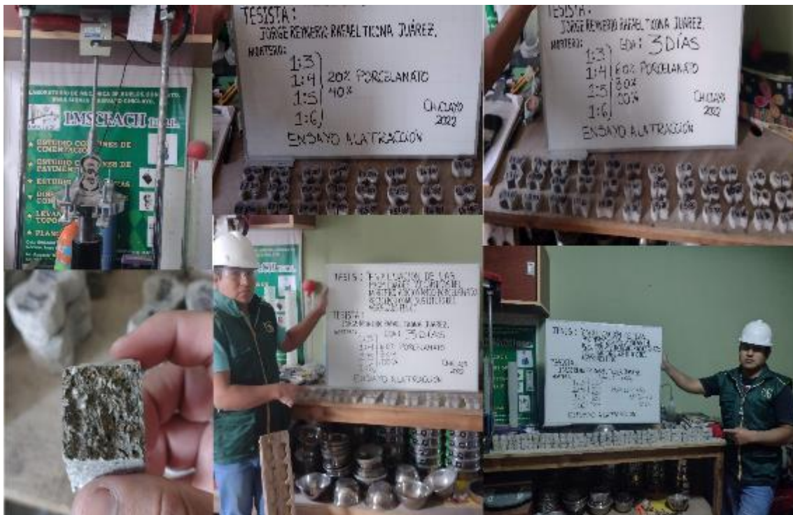
Ensayo de briquetas a tracción.
