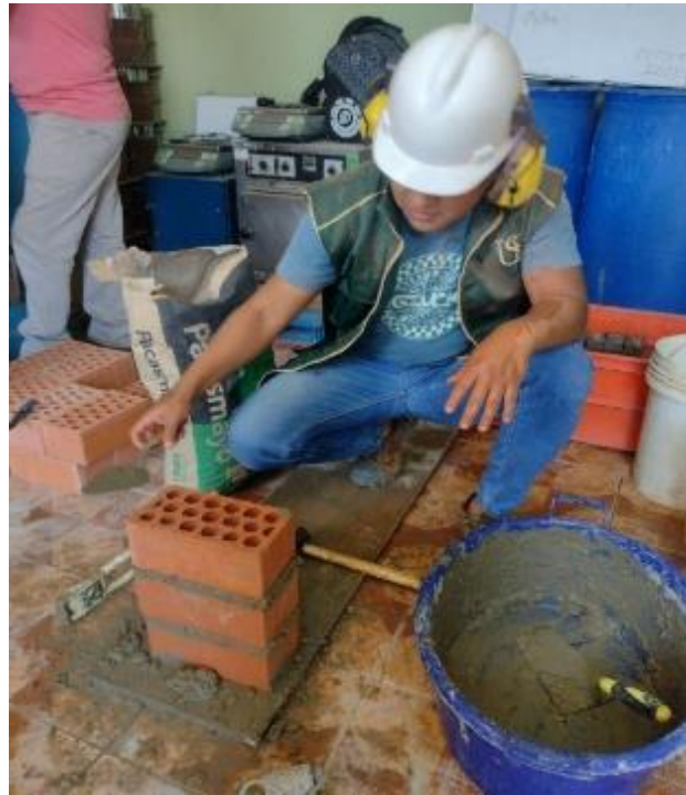
Fig. 51. Elaboración de las pilas de albañilería.
