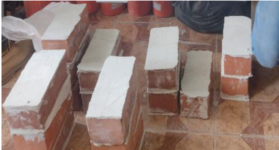
Fig. 41. Muestras colocadas con una capa de yeso/cemento.
