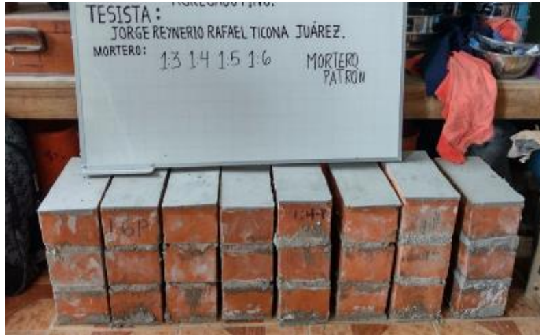
Fig. 54. Refrentado de las pilas de albañilería - ensayo compresión axial.
