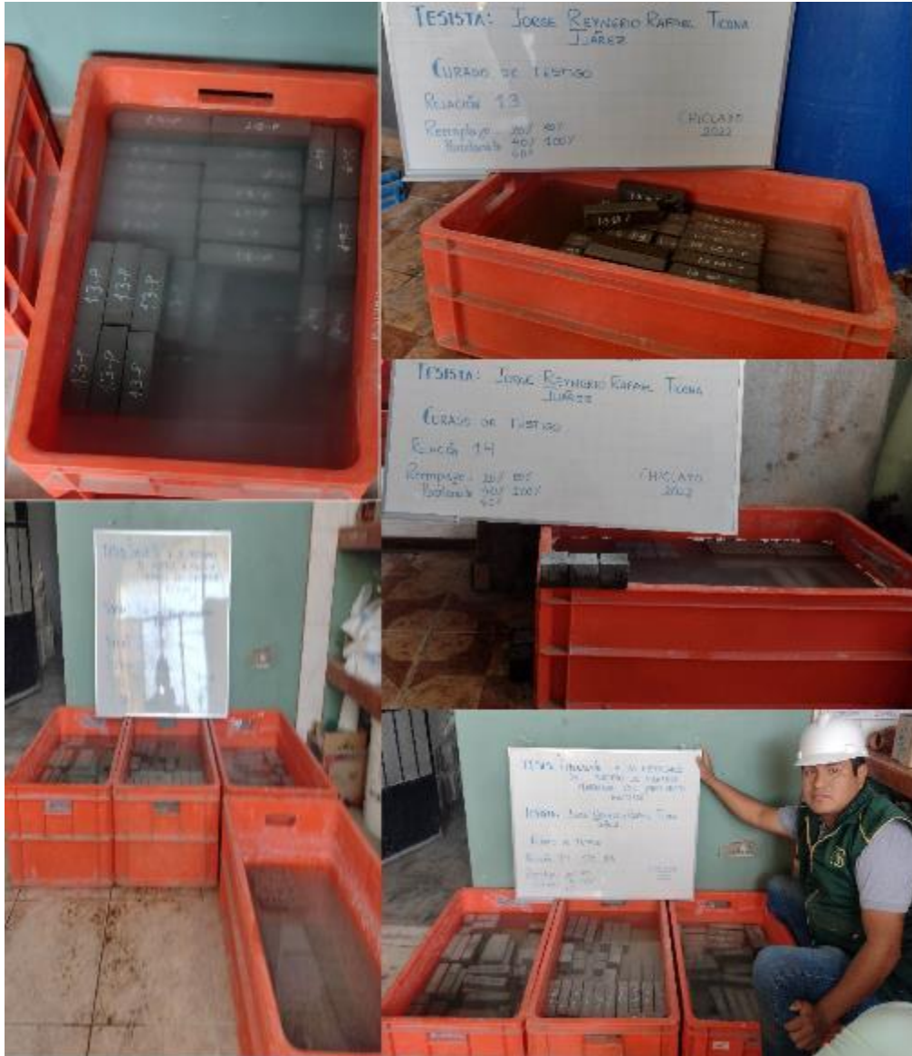
Curado de muestras cúbicas y vigas - 1:3, 1:4, 1:5, 1:6.
