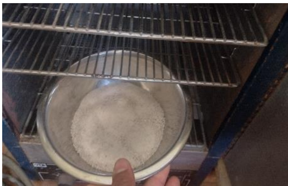
Fig. 30. Puesta en horno - Porcelanato reciclado.
