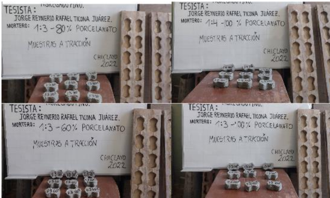
Desencofrado de briquetas.
