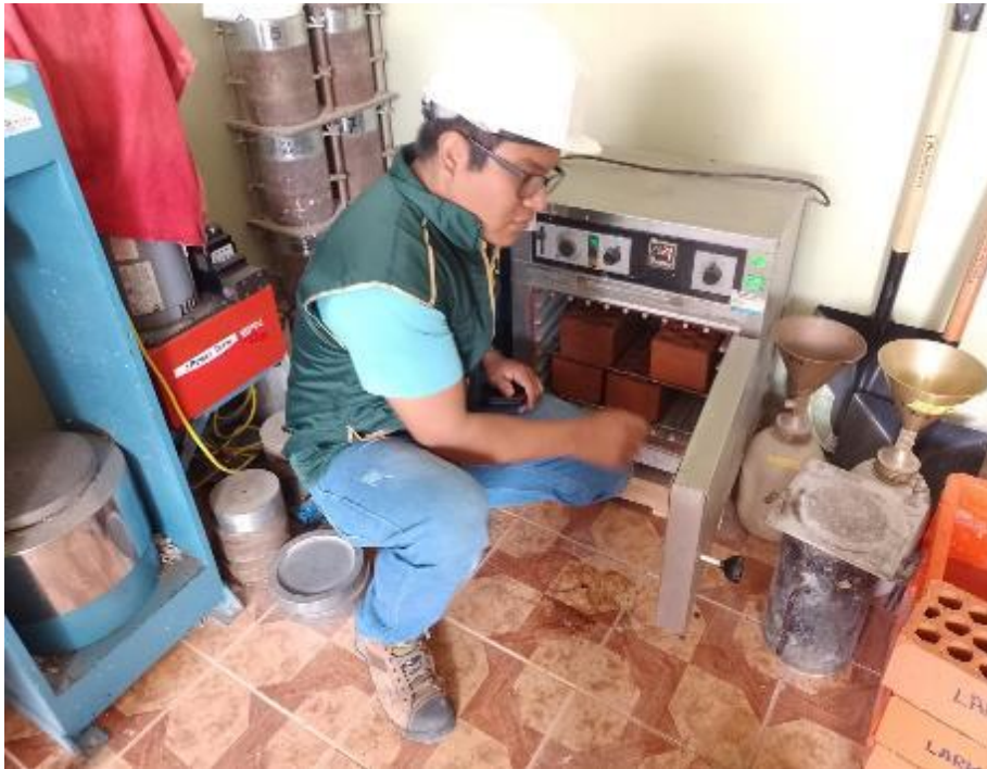
Fig. 39. Unidades de albañilería puestas en el horno - Ensayo de succión.
