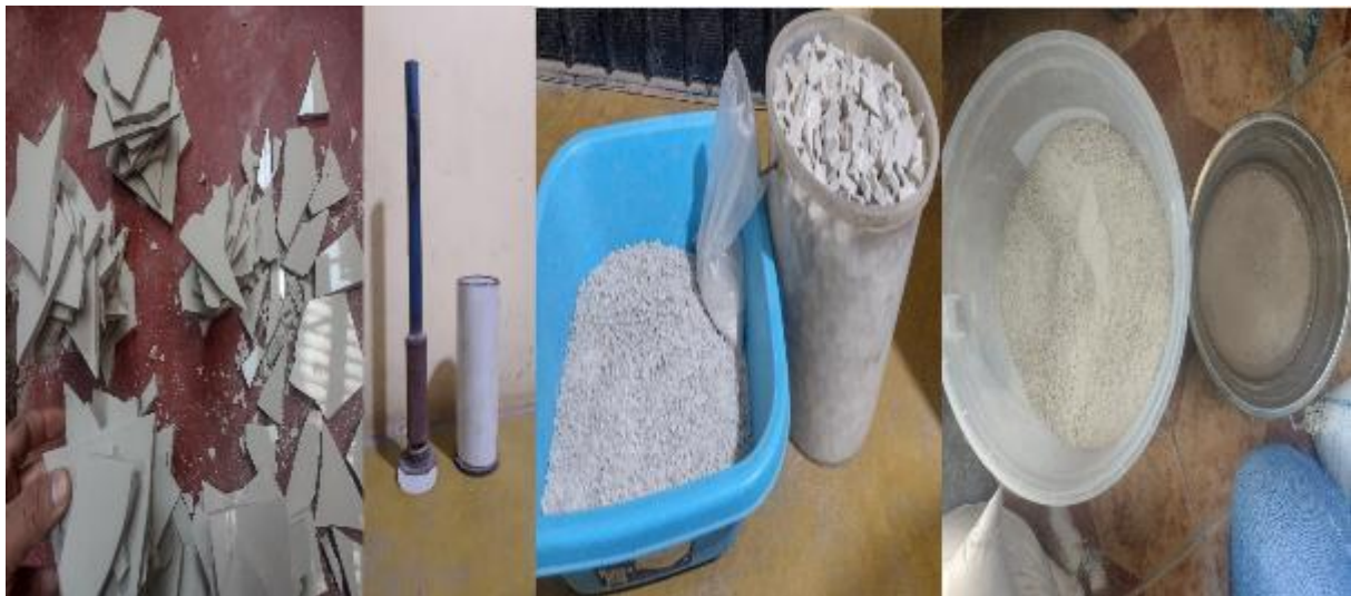
Proceso de trituración del porcelanato reciclado.
