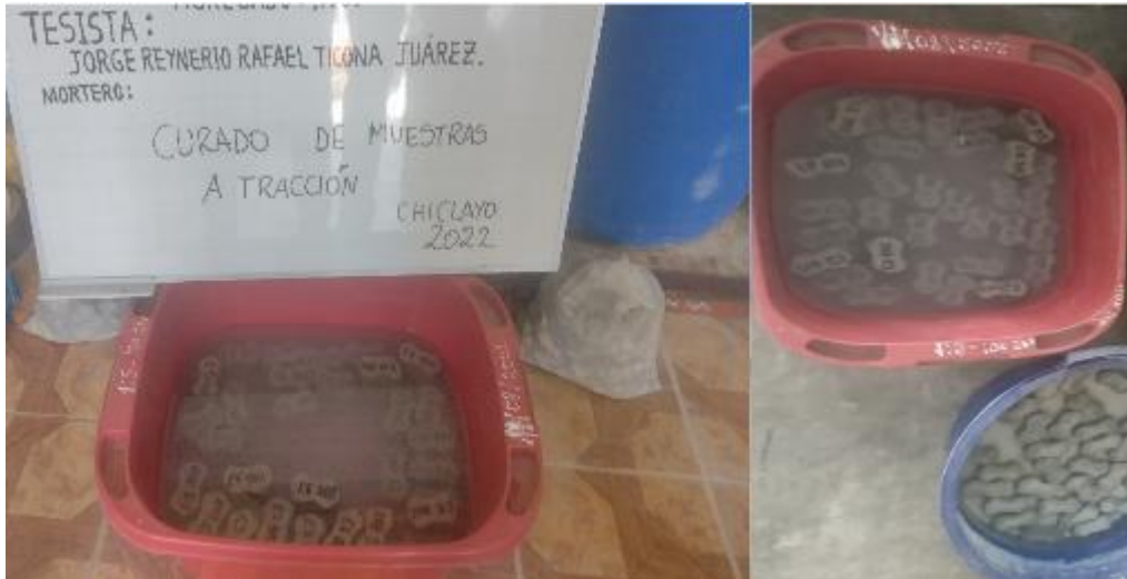
Curado de muestras - briquetas.
