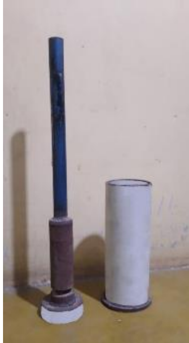
Fig. 17. Instrumento para triturar el porcelanato.
