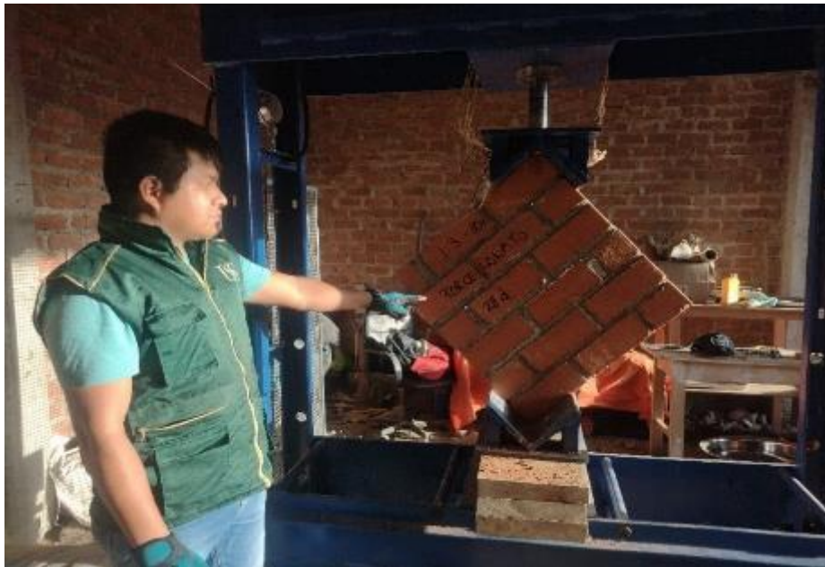
Fig. 57. Muretes ensayados a compresión diagonal.
