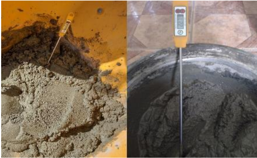
Temperatura del mortero.
