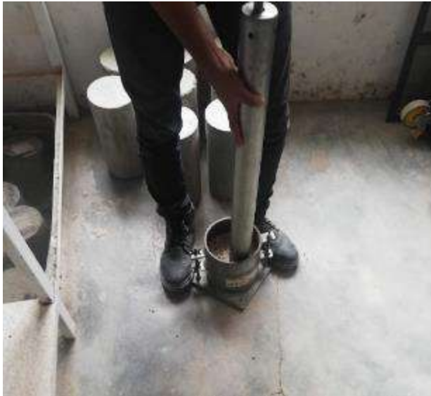
Fig. 15. Compactación con pisón
