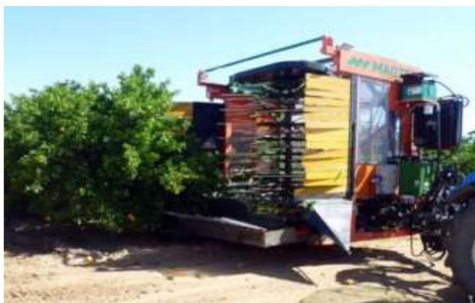
Figura 8 Prototipo de sistema sacudidor de copa lateral
