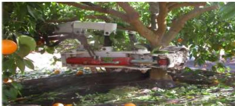
Figura 7 Vibradores de troncos en plantación de cítricos
