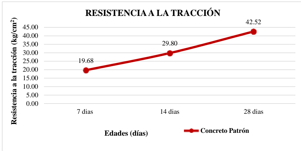
Figura 72. Resistencia a la tracción del diseño patrón f'c = 210 \text{ kg/cm}^2 a los 7, 14 y 28 días
