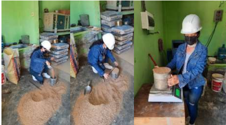
Figura 6. Ensayo de peso unitario suelto del agregado fino.
