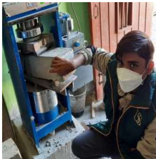
Figura 23. Rotura de probeta prismática (viga) ensayada a flexión.
