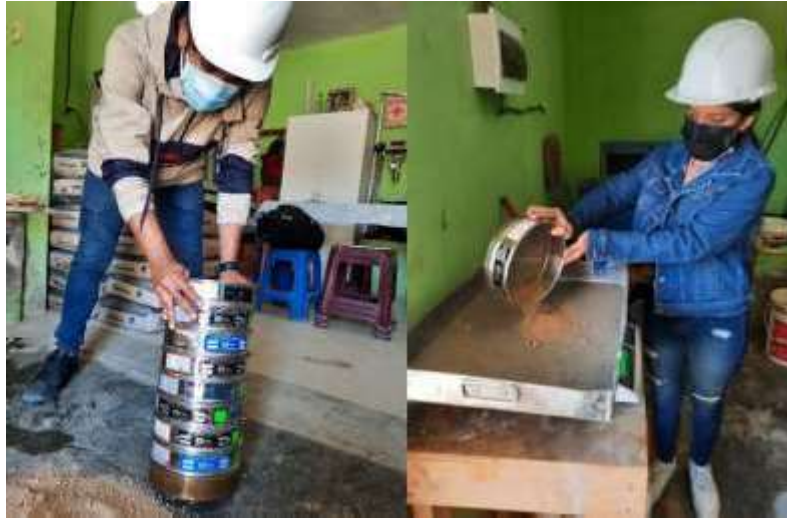
Figura 2. Tamizado del agregado fino y pesado del material retenido en los tamices.
