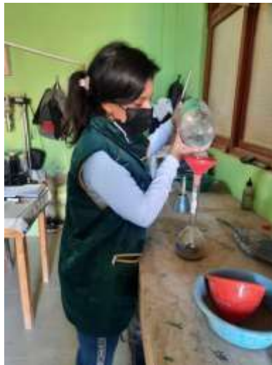
Figura 11. Ensayo de peso específico de agregado fino.
