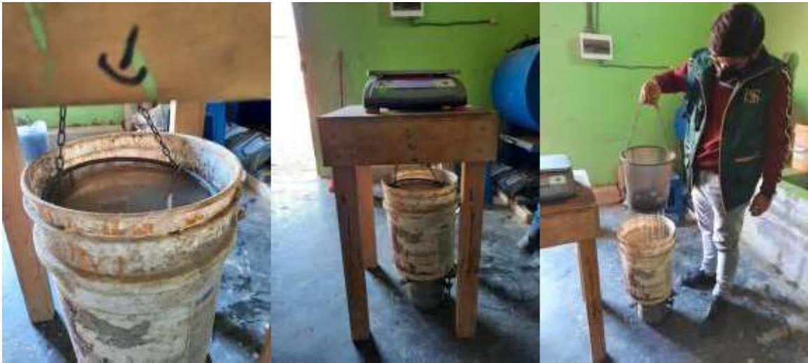
Figura 12. Ensayo de peso específico de agregado grueso.
