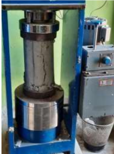
Figura 22. Rotura de probeta cilíndrica ensayada a compresión.
