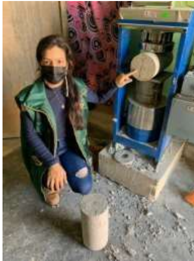
Figura 24. Rotura de probeta cilíndrica ensayada a tracción.
