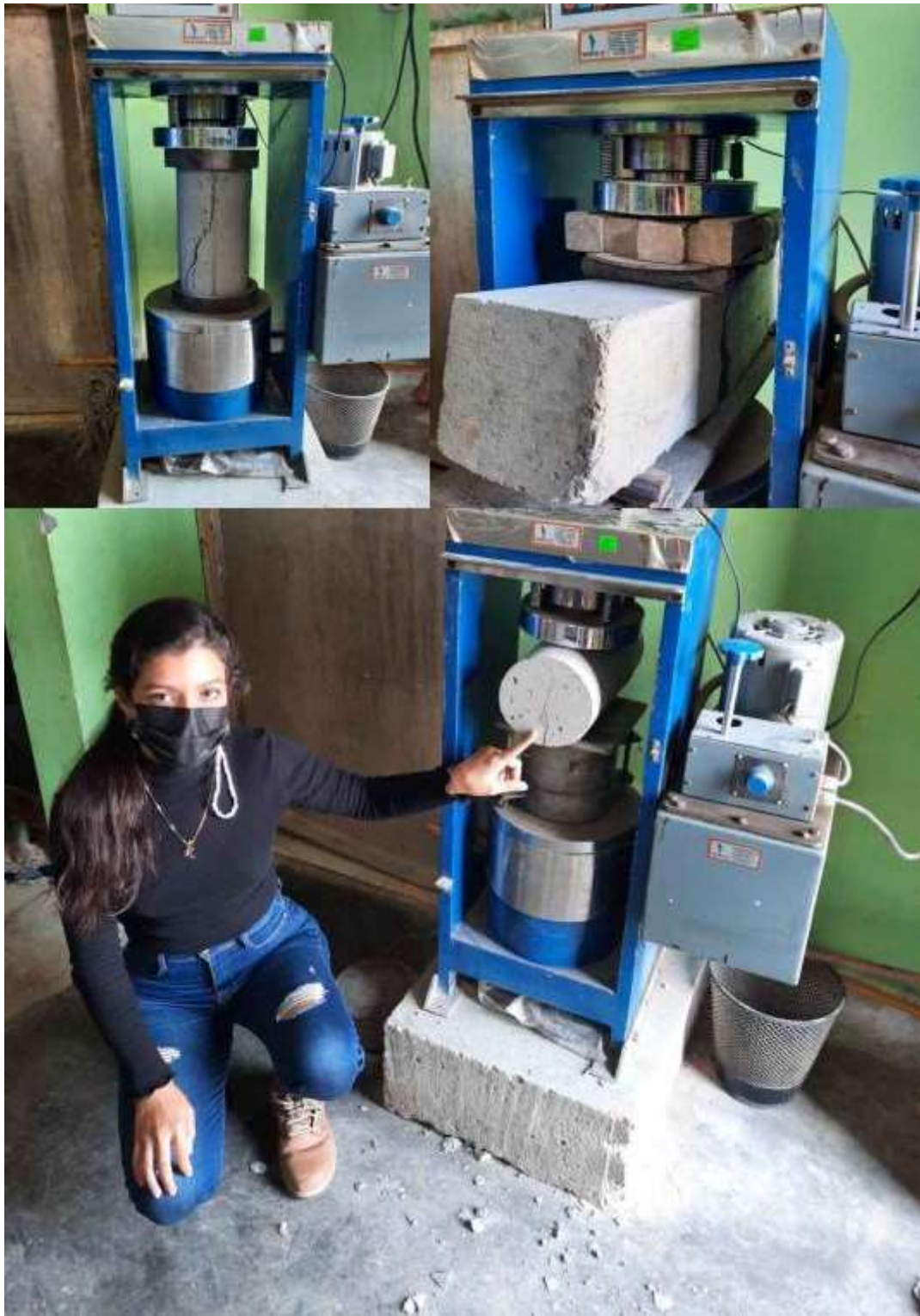
Roturas de probetas cilíndricas y prismáticas sometidas a compresión, flexión y tracción en la prensa hidráulica.
