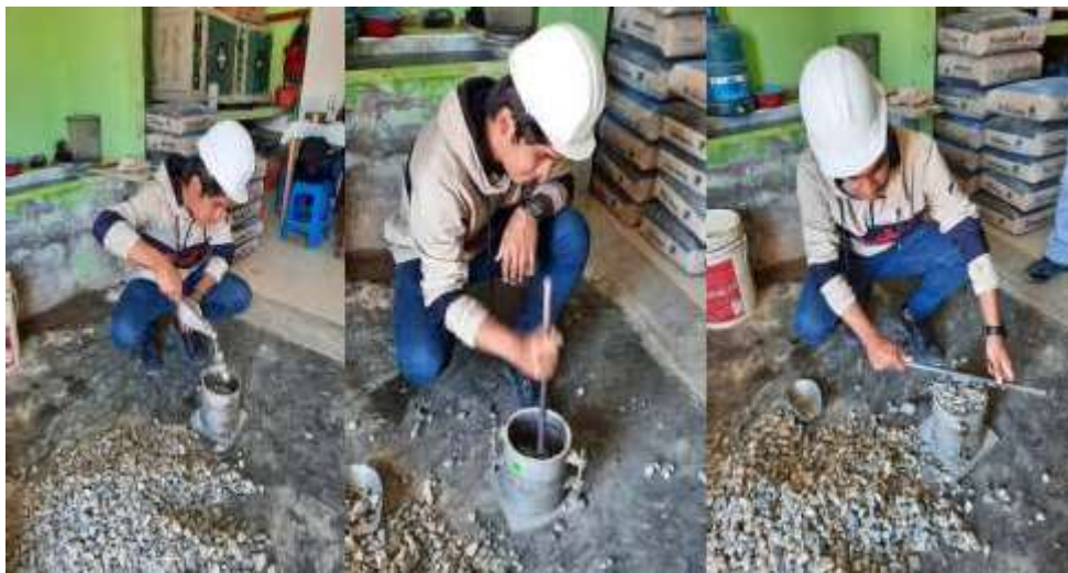
Figura 8. Ensayo de peso unitario compactado del agregado grueso.
