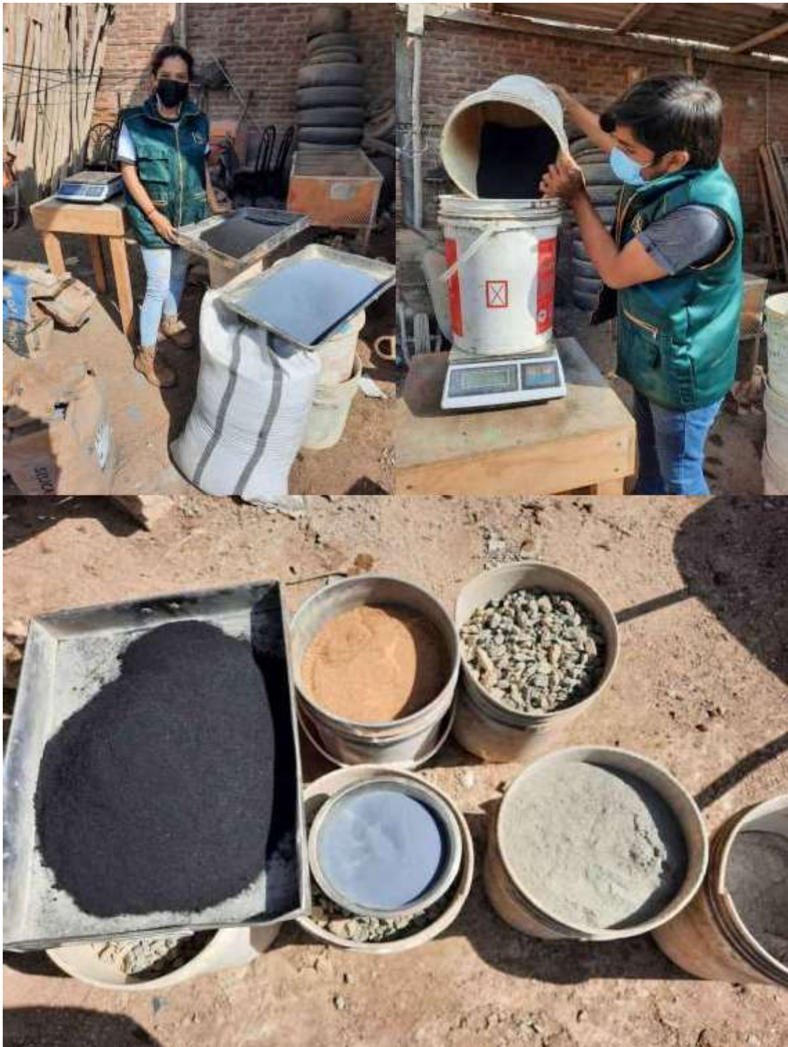
Pesado de materiales según los diseños de mezcla realizados para la elaboración de las muestras de concreto.
