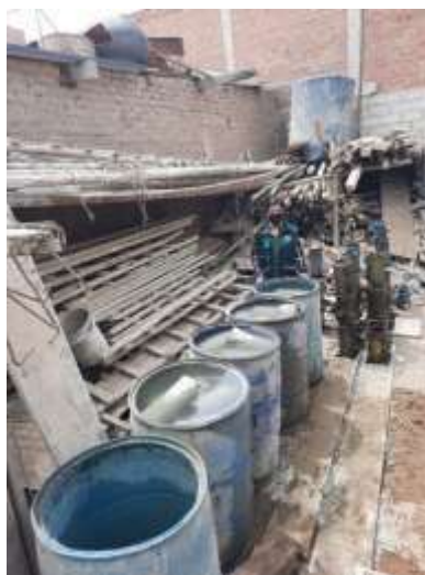
Figura 19. Curado de probetas y vigas.
