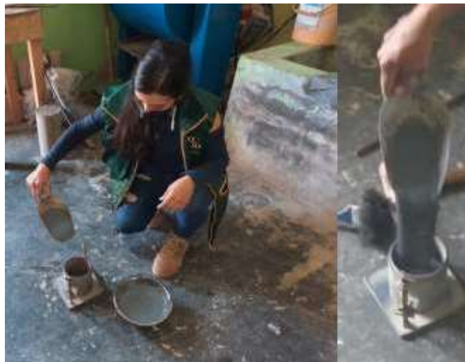
Figura 10. Ensayo de peso unitario suelto del humo de sílice.
