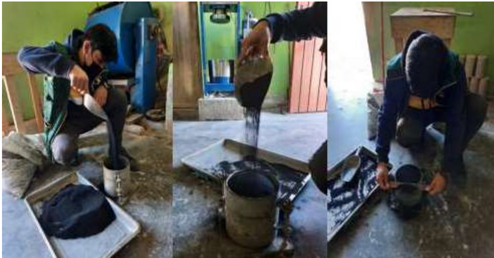
Figura 9. Ensayo de peso unitario suelto del polvo de caucho.
