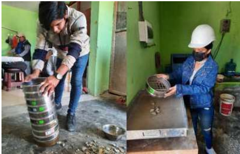
Figura 3. Tamizado del agregado grueso y pesado del material retenido en los tamices.
