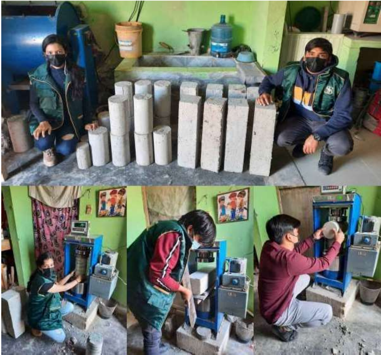
Colocación de probetas en prensa hidráulica para ser sometidas a ensayos de resistencia a la compresión., flexión y tracción.
