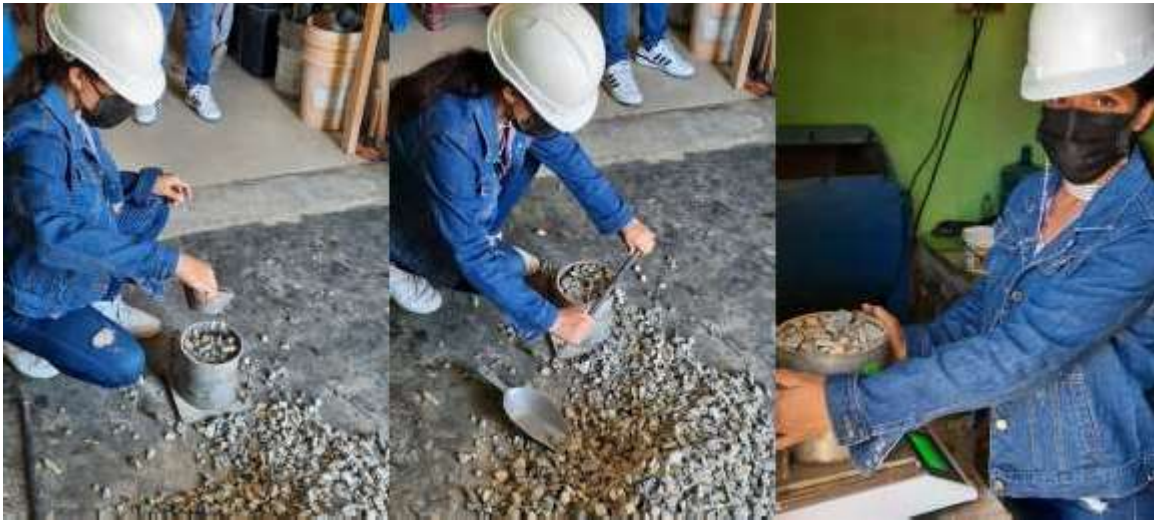
Figura 7. Ensayo de peso unitario suelto del agregado grueso.
