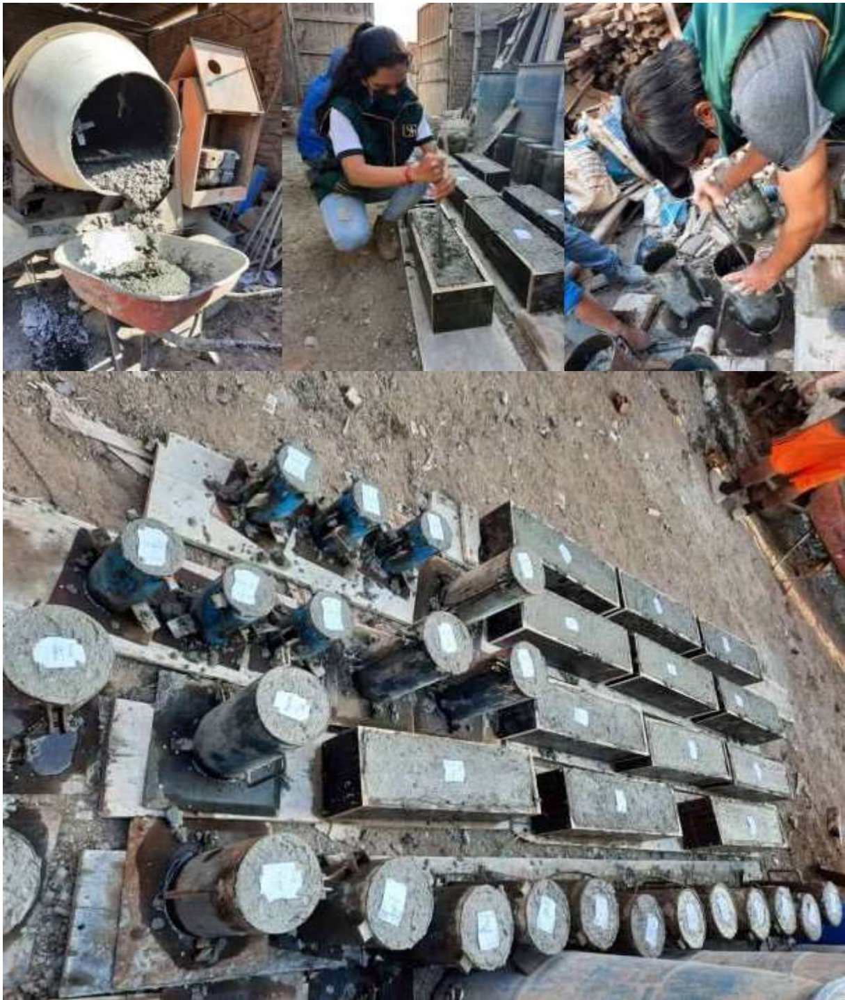
Elaboración de muestras cilíndricas y prismáticas de concreto patrón y concreto con polvo de caucho más humo de sílice.
