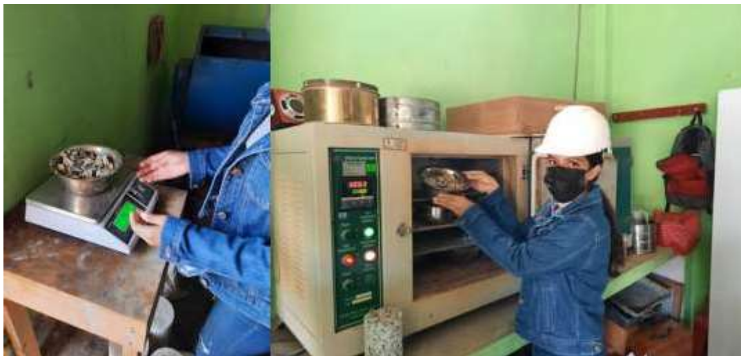
Figura 14. Agregado grueso puesto en horno para su secado.
