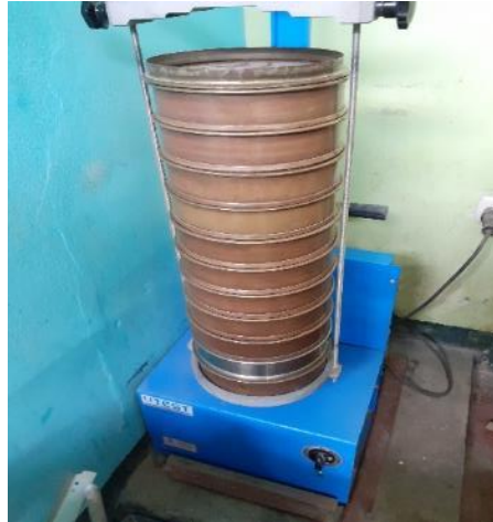
Figura 6 Análisis de tamizado de agregado grueso y fino.
