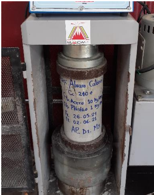
ENSAYO DE RESISTENCIA A LA COMPRESION DEL CONCRETO CON FIBRAS
