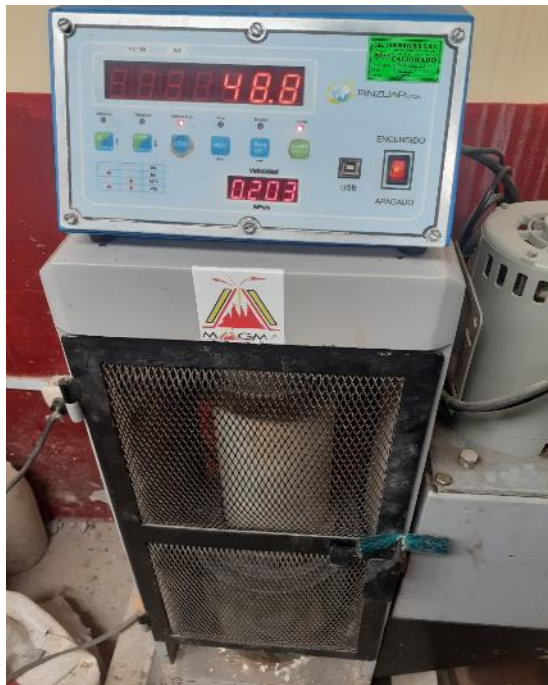
ENSAYO DE RESISTENCIA A LA COMPRESION DEL CONCRETO
