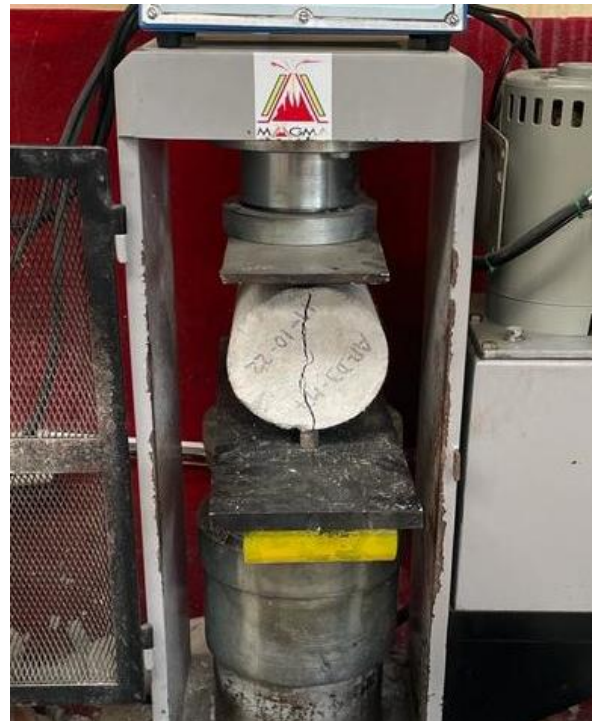
ENSAYO DE RESISTENCIA A LA TRACCION DEL CONCRETO CON FIBRAS
