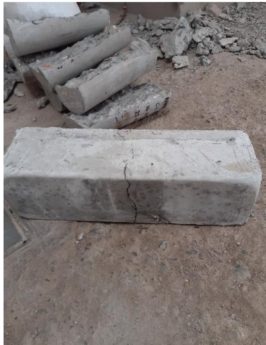
ENSAYO DE RESISTENCIA A LA FLEXION DEL CONCRETO CON FIBRAS
