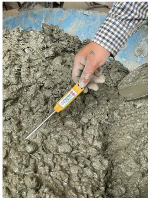
TEMPERATURA DE LAS MEZCLAS DE CONCRETO
