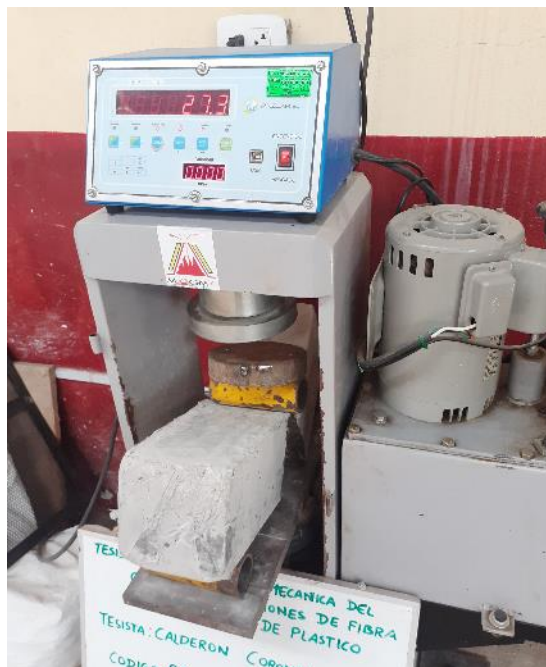
ENSAYO DE RESISTENCIA A LA FLEXION DEL CONCRETO SIN FIBRAS
