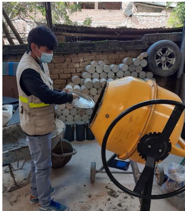
INCORPORACION DE LAS FIBRAS DE PLASTICO EN EL CONCRETO
