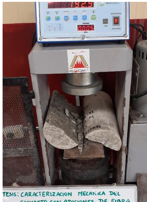
ENSAYO DE RESISTENCIA A LA TRACCION DEL CONCRETO SIN FIBRAS
