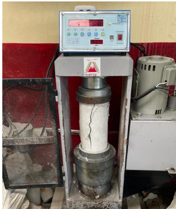
ENSAYO DE RESISTENCIA A LA COMPRESION DEL CONCRETO SIN FIBRAS
