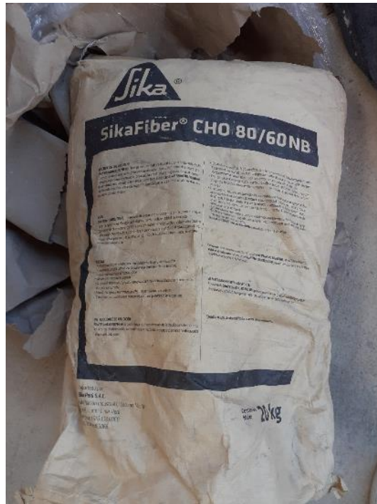
FIBRAS DE ACERO ADICIONADAS EN EL CONCRETO
