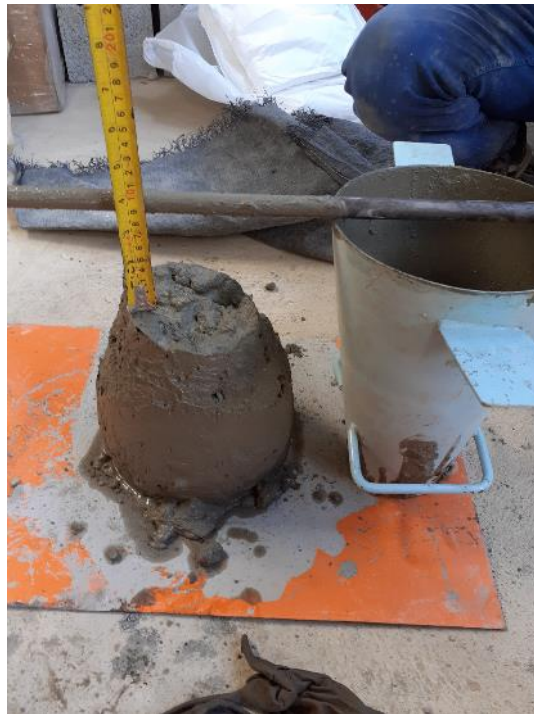
DETERMINACION DEL ASENTAMIENTO DE LAS MEZCLAS DE CONCRETO
