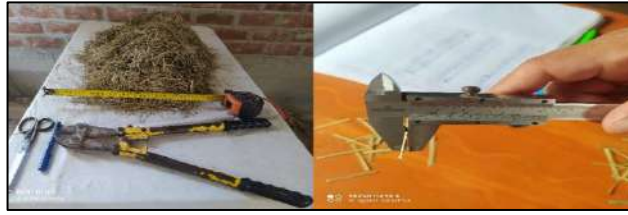
Figura 13. Procesado, cortado y medición de las fibras de palmera.
