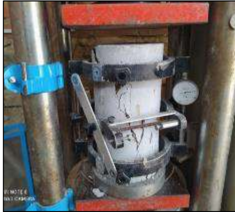
Figura 18. Ensayo del módulo de elasticidad del espécimen de estudio.
