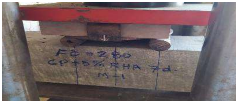
Figura 17. Ensayo a la flexión a los tercios de la viga de estudio.
