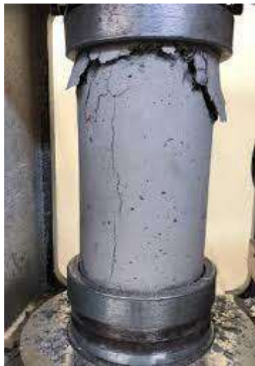
Figura 15. Ensayo de resistencia a la compresión.
