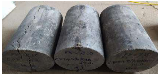
d) probetas ensayadas a la tracción diagonal.
