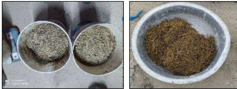
Figura 14. a) fibras de palmera sin tratar. b) fibras de palmera tratadas.
