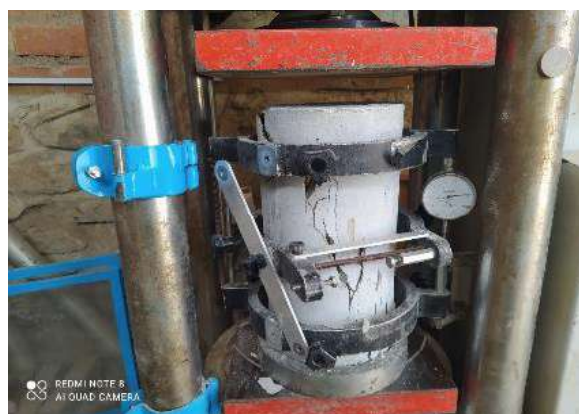
f) Ensayo del módulo de elasticidad de las muestras.
