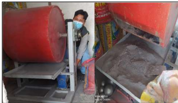
Figura 12. Molido de las cenizas de cascarilla de arroz (maquina los ángeles).
