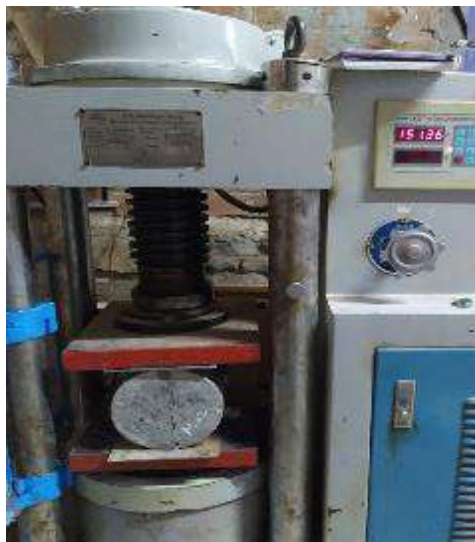
Figura 16. Ensayo de resistencia a la tracción de las probetas de estudio.
