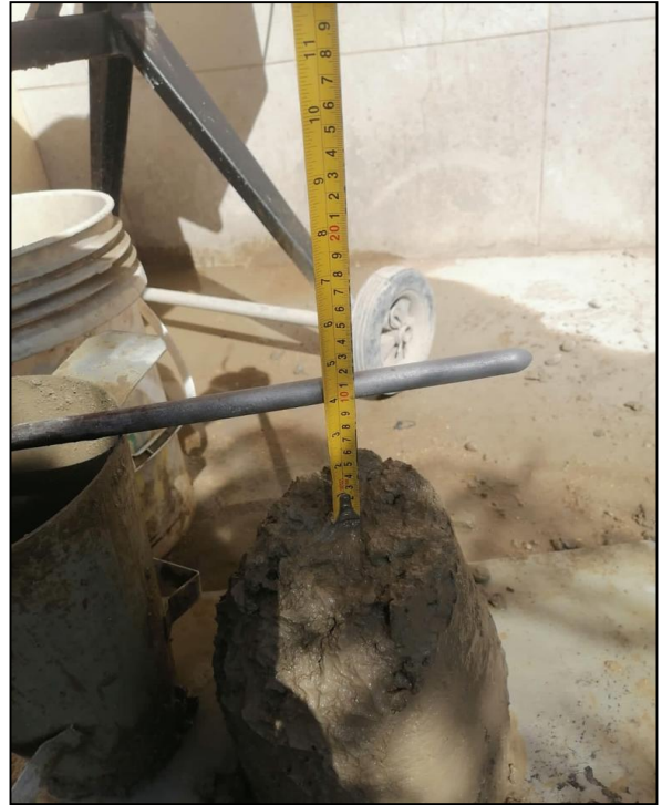
Ilustración 118. Ensayo de asentamiento
