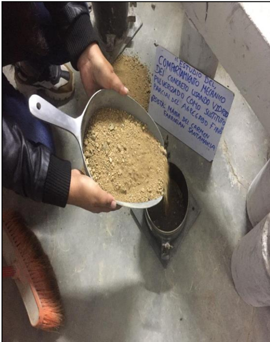
Ilustración 113. Peso unitario suelto (agregado fino)
