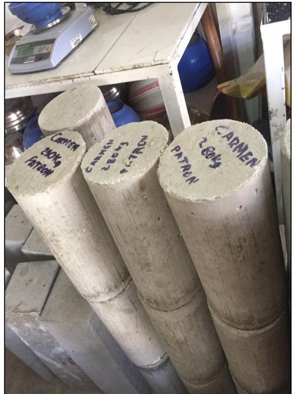
Ilustración 124. testigos de concreto
