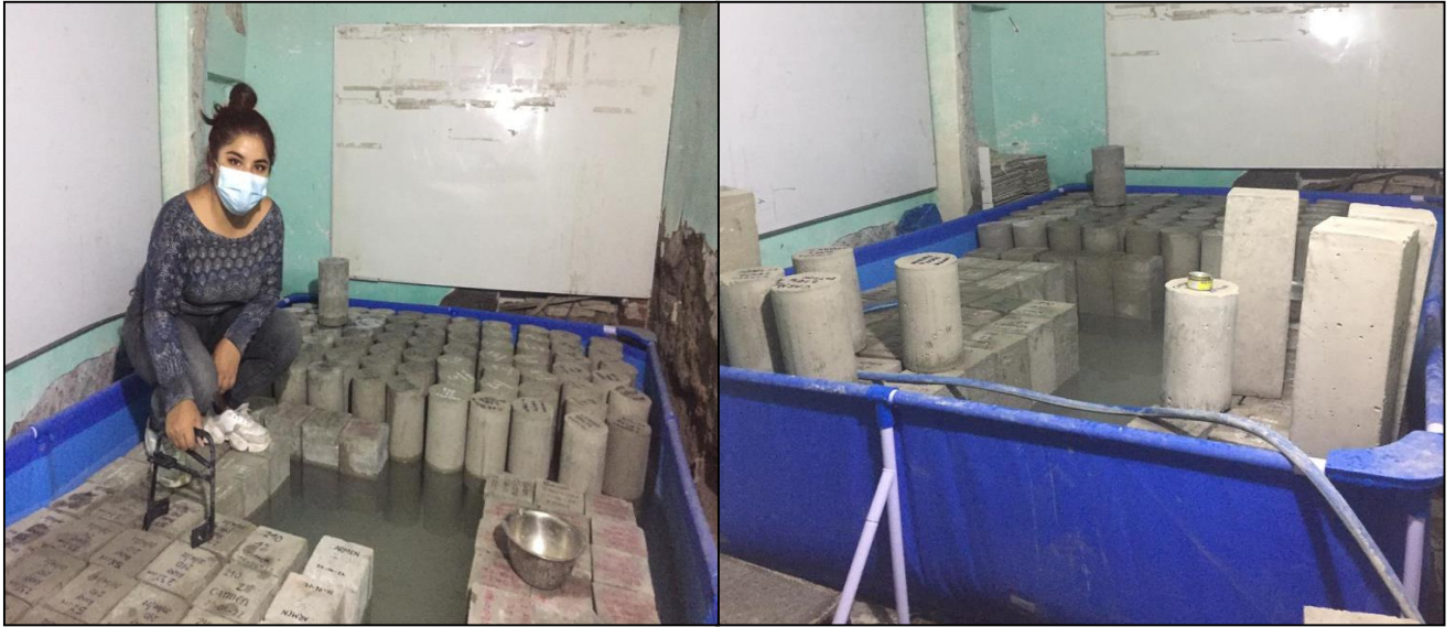
Ilustración 125. Curado de vigas y probetas
