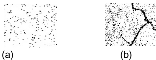
Figura 28. Imágenes sin grietas (a) y con grietas (b).
