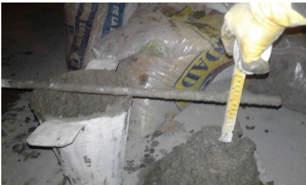
Figura 32. Ensayo de consistencia del concreto.
