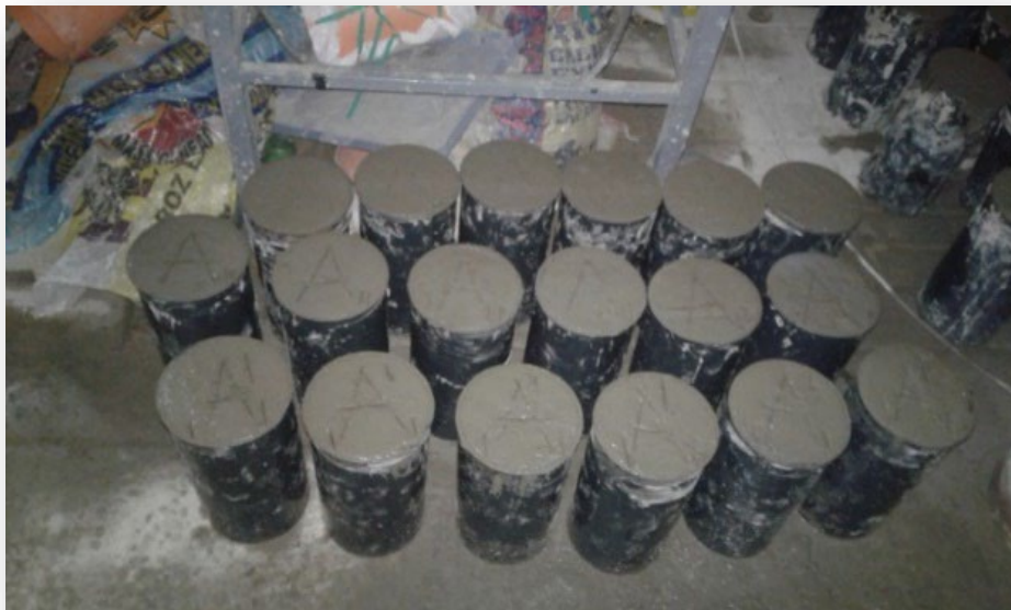
Figura 8: Fabricación y curado de probetas cilíndricas
