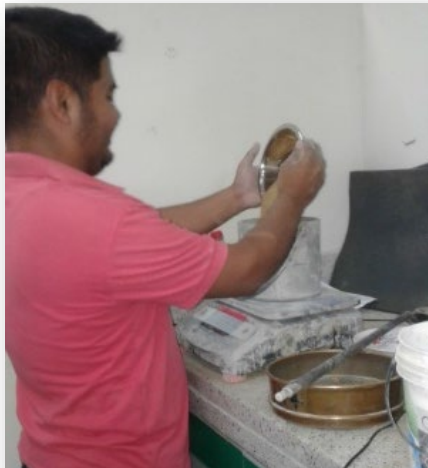
Figura 5: Peso volumétrico suelto de los agregados
