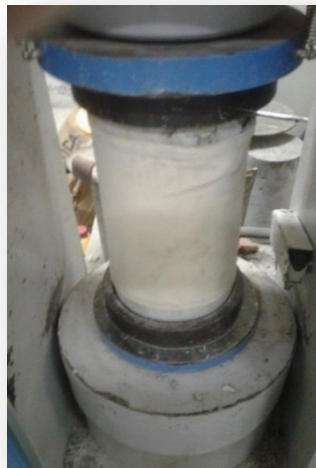
Figura 11: Resistencia a la compresión
