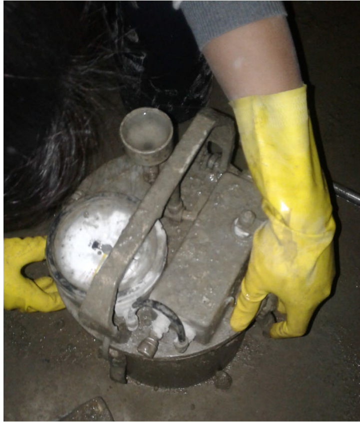
Figura 33. Ensayo de contenido de aire del concreto.
