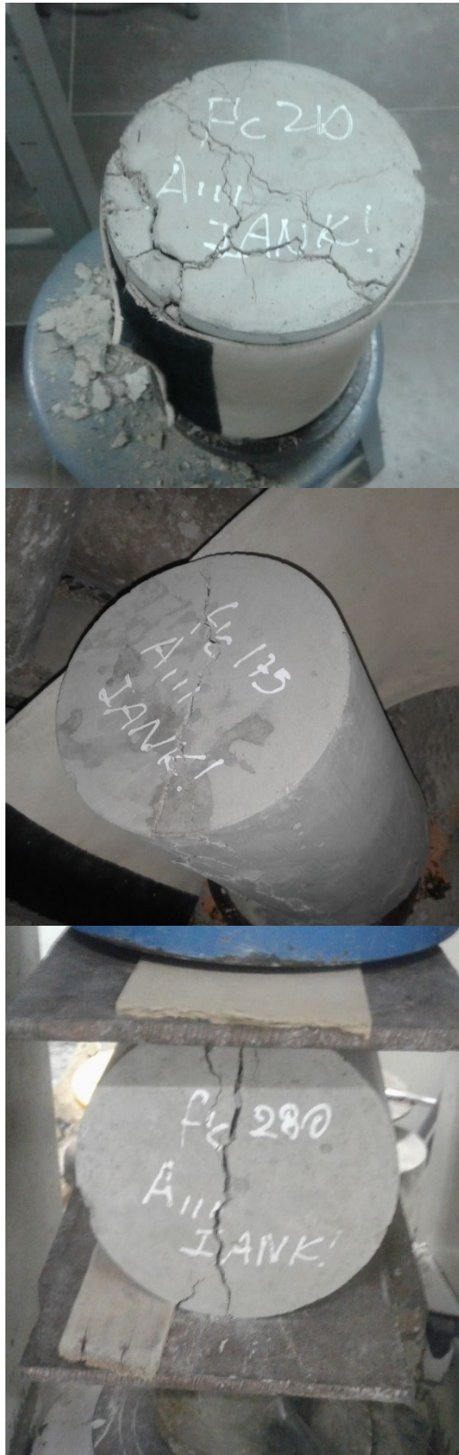
Figura 35. Rupturas de probetas de concreto.
