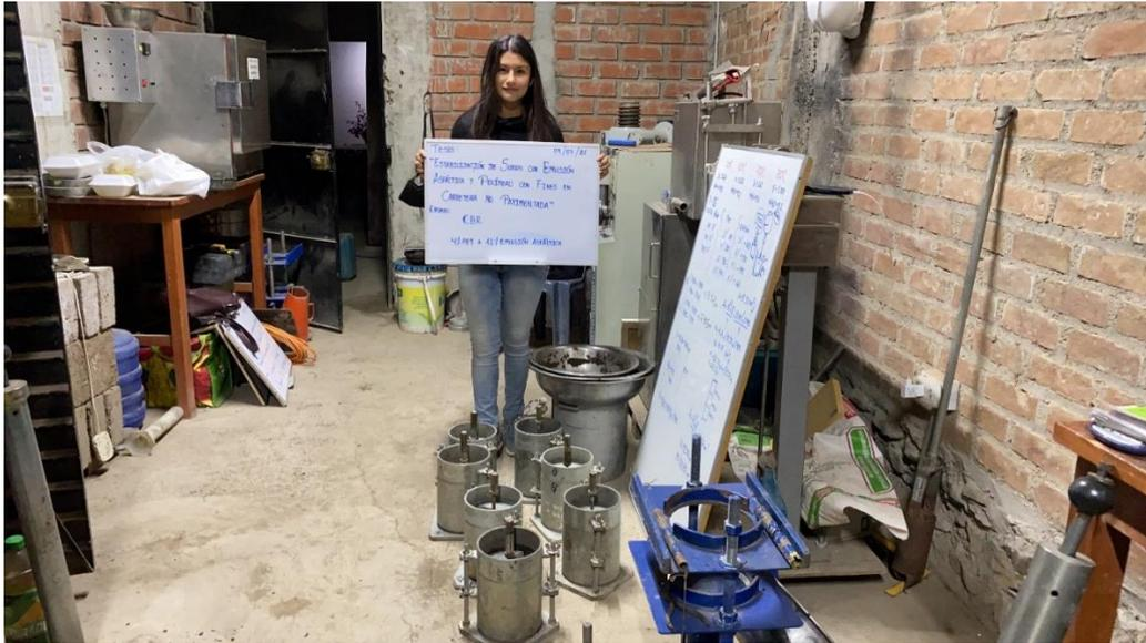
*Figura 130.* Ensayo de CBR para una combinación de 4% de PET + 12% de emulsión asfáltica.
