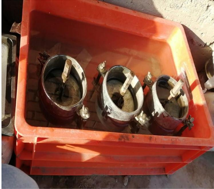
*Figura 128.* Moldes sumergidos en agua con sobrecarga colocada.
