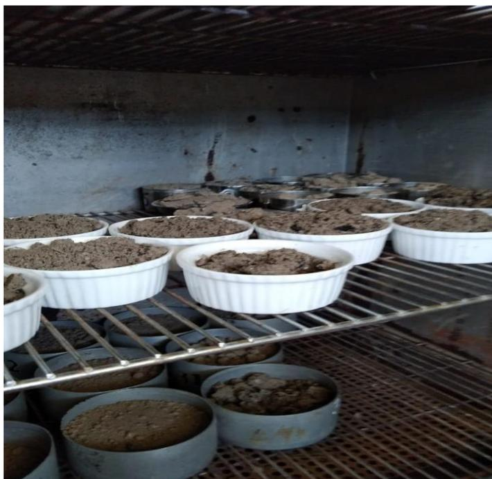
*Figura 125.* Muestras llevadas al horno para determinar su contenido de humedad.
