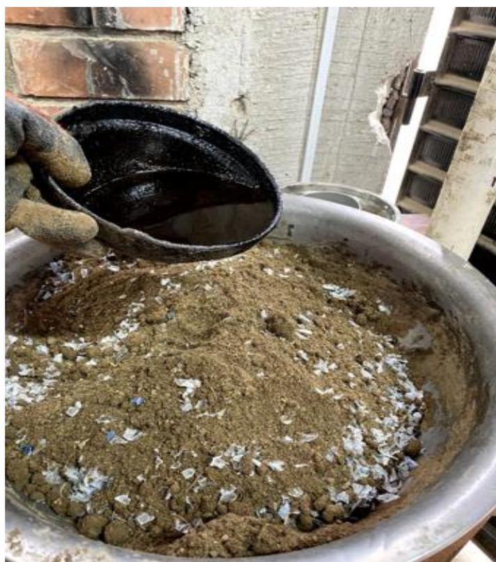
*Figura 127.* Mezcla de suelo, PET y emulsión asfáltica.
