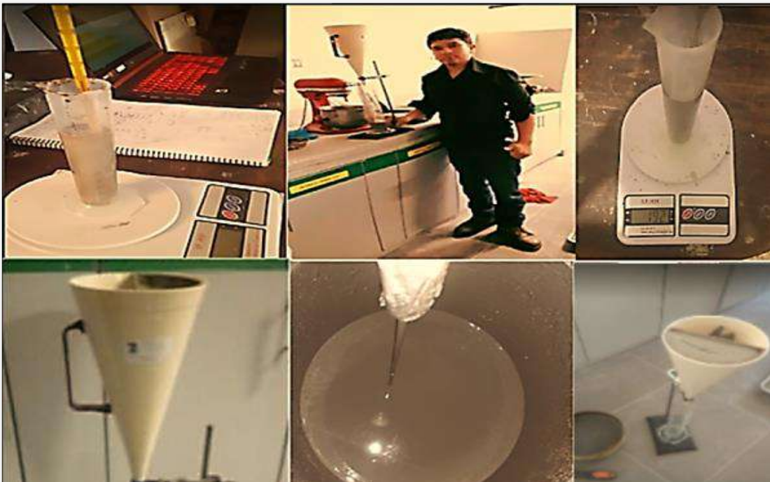
Figura 58. Fase de pruebas de fluidez y compatibilidad del mortero
