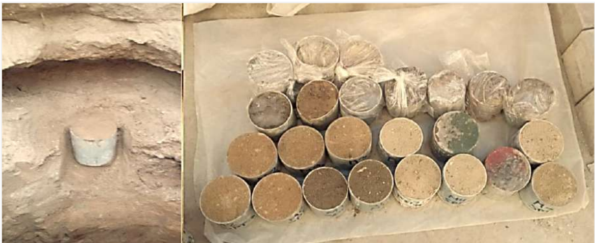
Figura 43. Obtención de muestras inalteradas
