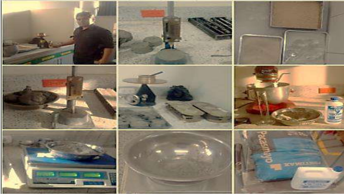
Figura 57. Fase de pruebas de selección de materiales, dosificación y preparación del mortero
