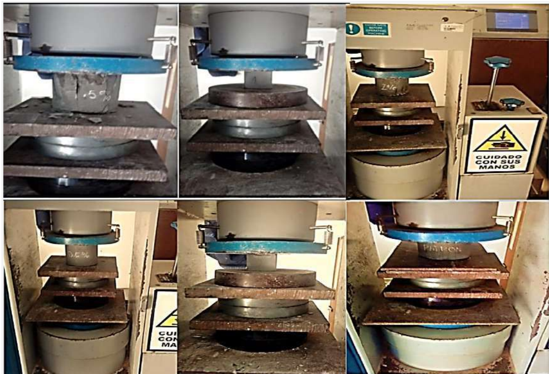
Figura 62. Rotura de moldes cilíndricos en máquina universal de compresión
