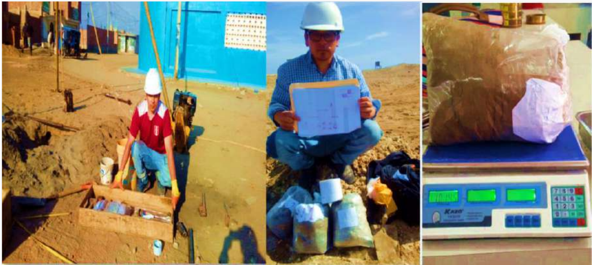
Figura 40. Obtención y recuperación de las muestras alteradas
