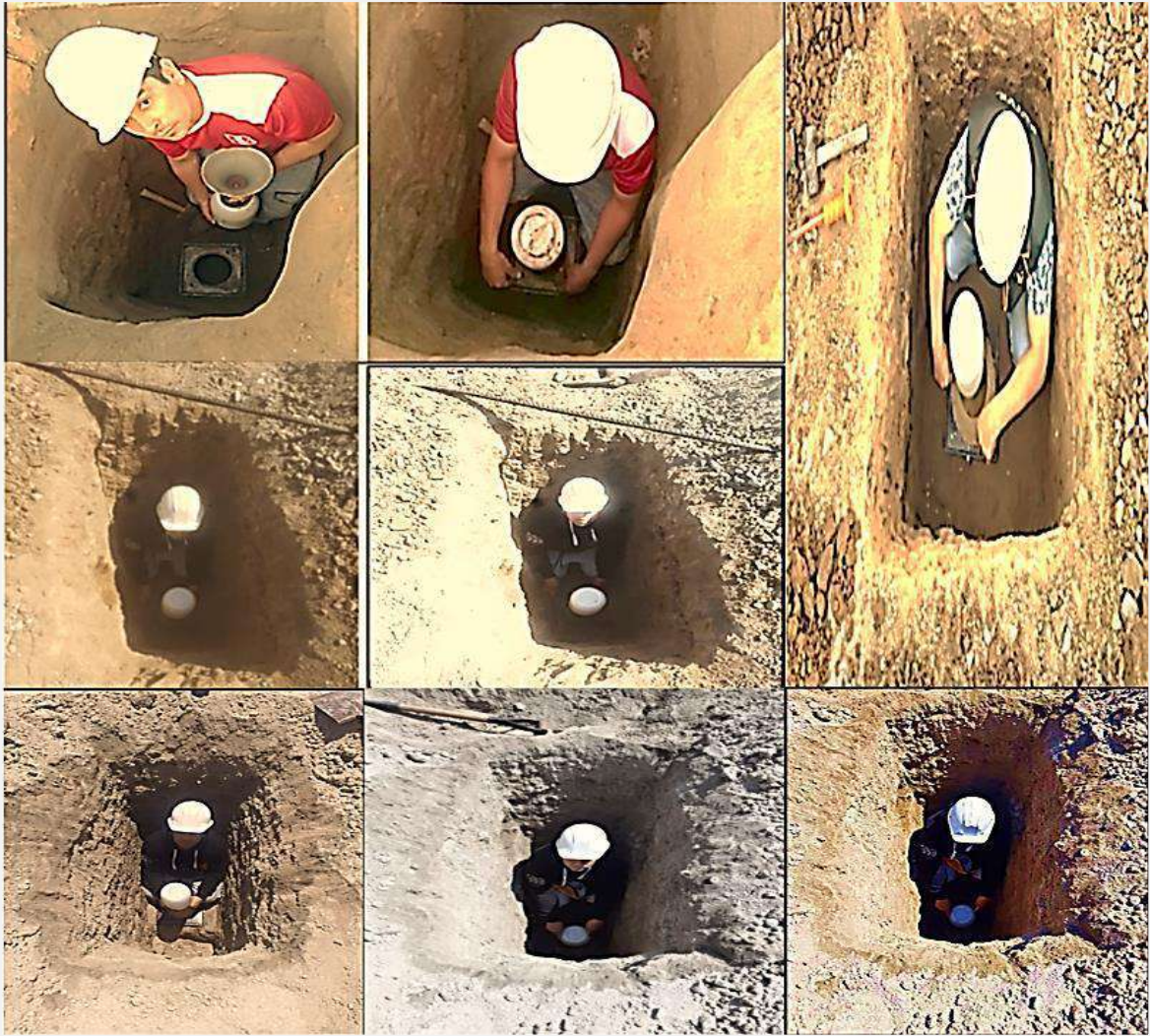
Figura 42. Toma de registro de densidad natural en las calicatas ejecutadas
