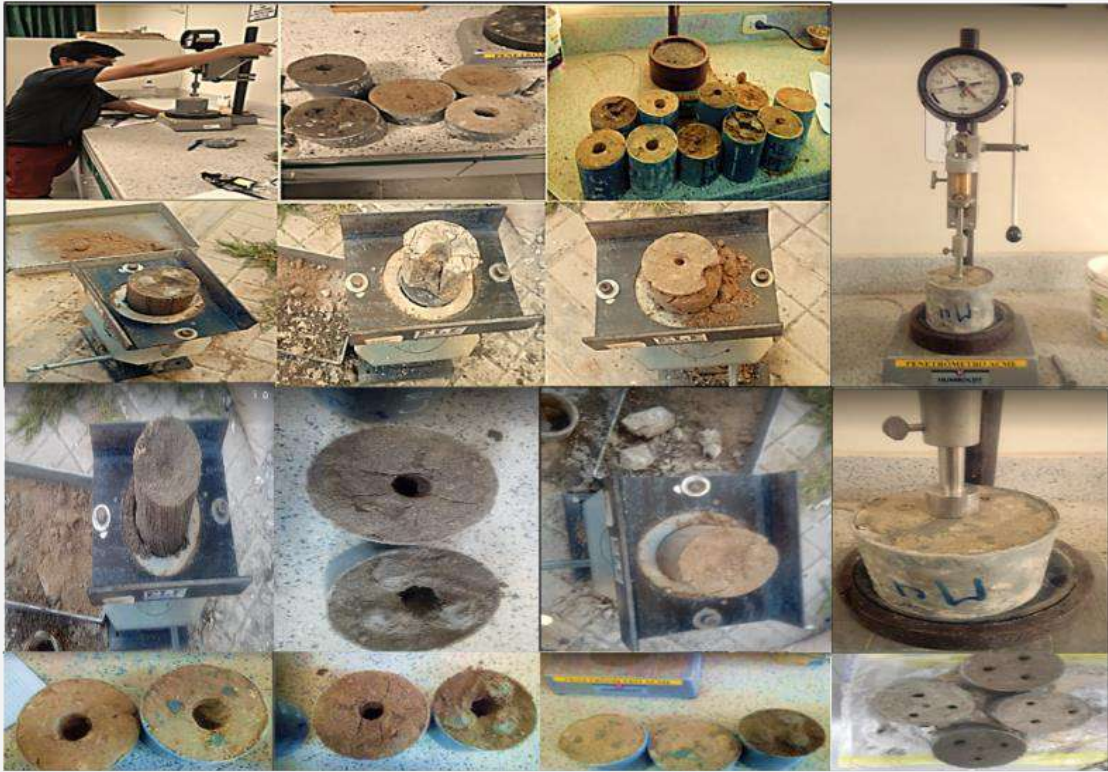
Figura 59. Ensayo de resistencia a la penetración en penetrometro ACMÉ
