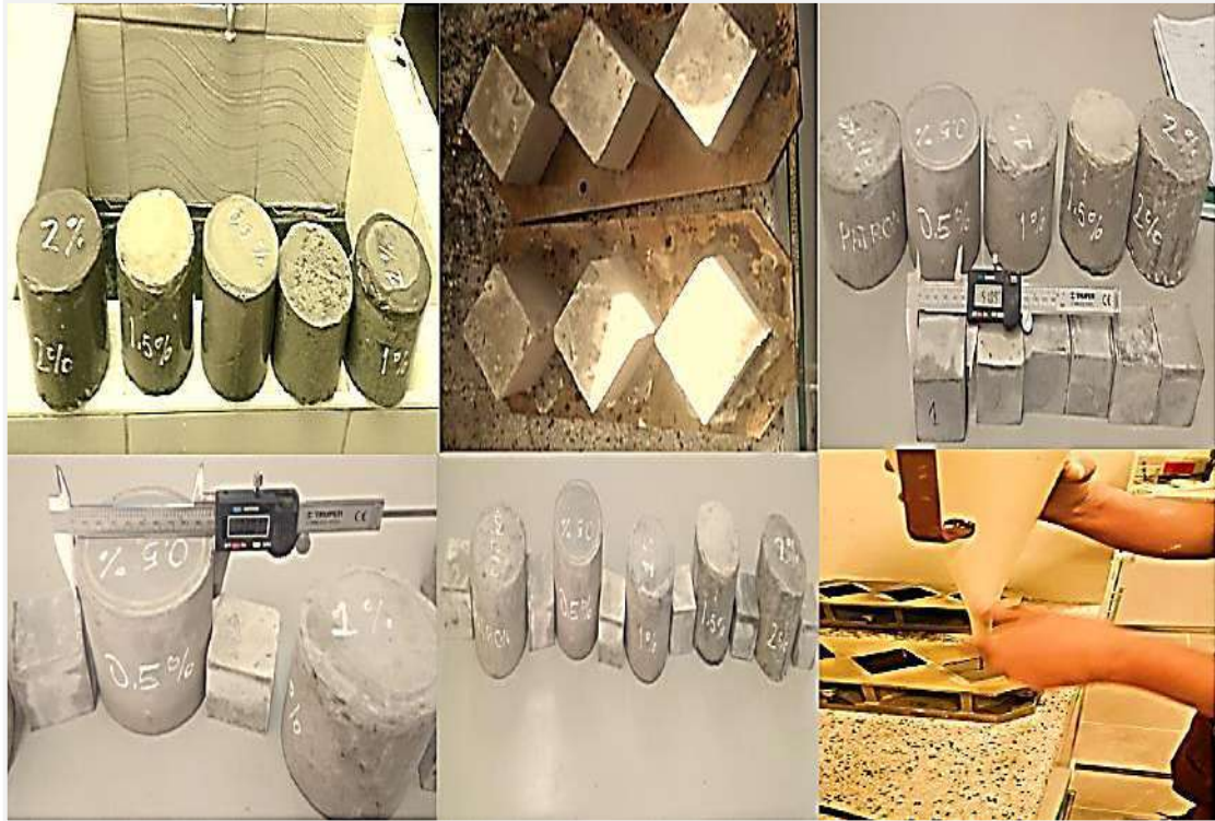
Figura 61. Preparación y curado de especímenes cúbicos y cilíndricos de mortero para los ensayos de compresión
