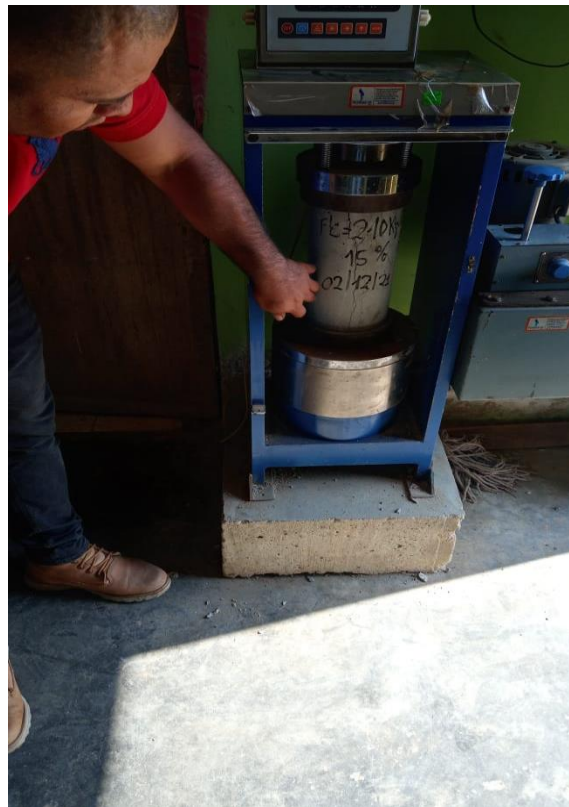
Foto 7: Resistencia a la compresión (con carga sometida).
