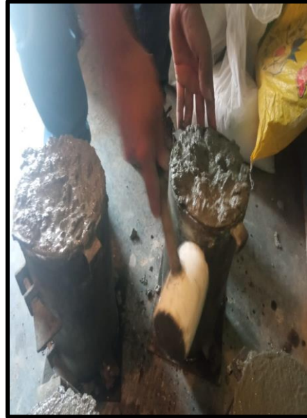
Foto 4: Compactado de las probetas cilíndricas.
