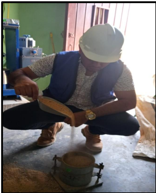
Foto 3: Compactado del agregado fino.
