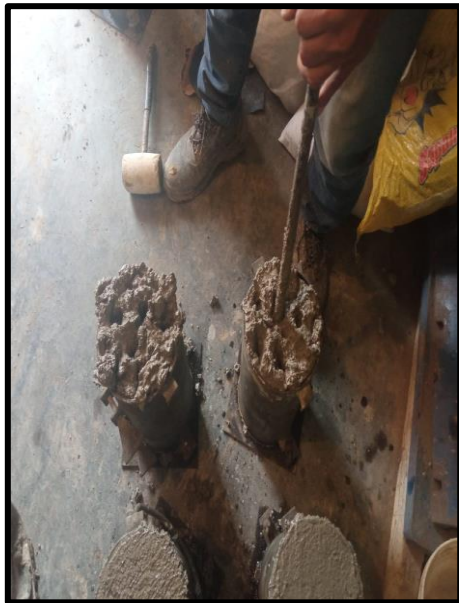
Foto 3: Varillado de la probeta cilíndrica.
