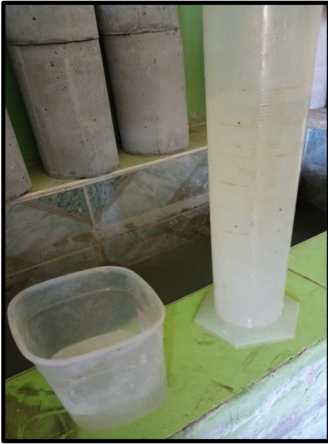
Foto 5: Curado de las probetas cilíndricas.
