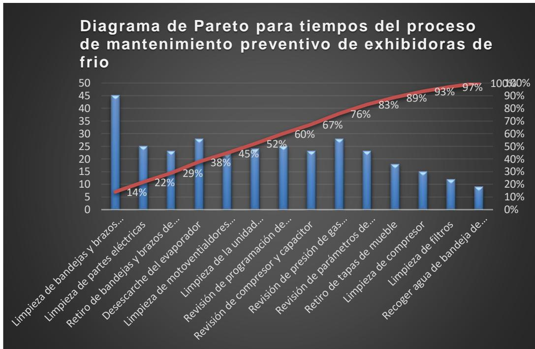
**Figura 24:** Tiempos del proceso de mantenimiento de exhibidoras de frío
